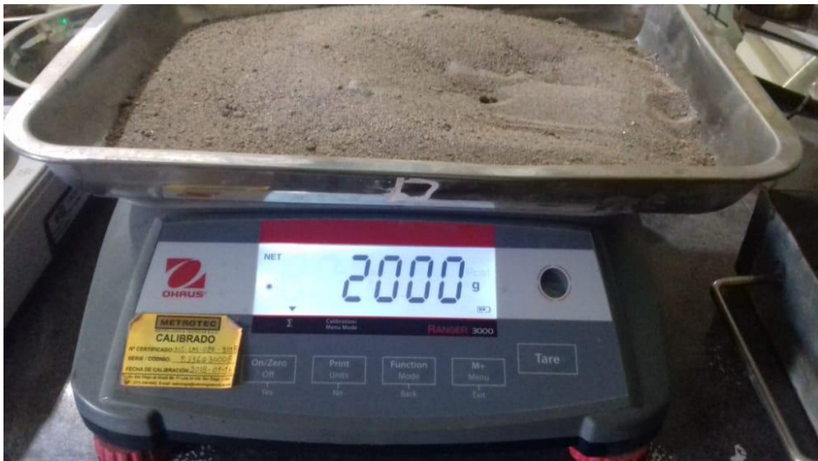
Figura N° 9. Agregado fino siendo estudiado en pesos
