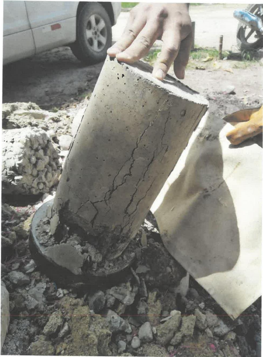
Fotografía N° 11. Rotura de probetas
