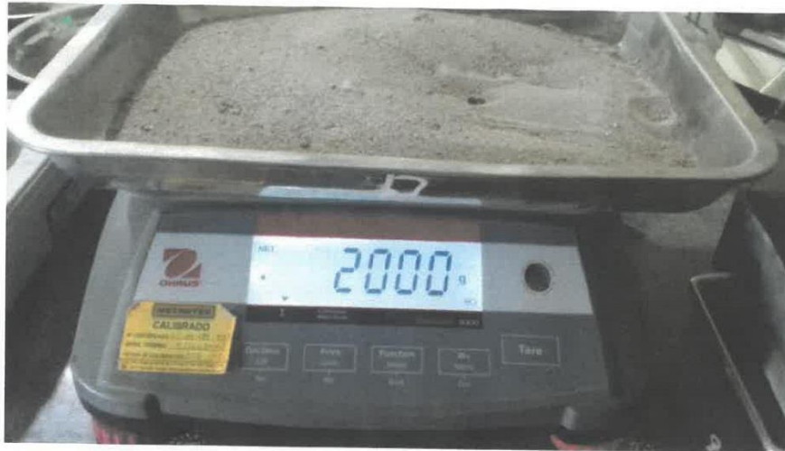
Fotografía N° 03. Peso de agregado fino previo a su colocación en el horno
