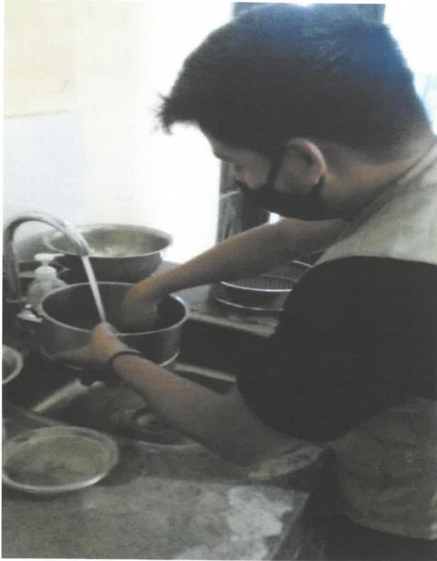
Fotografía N° 02. Lavado del Agregado fino
