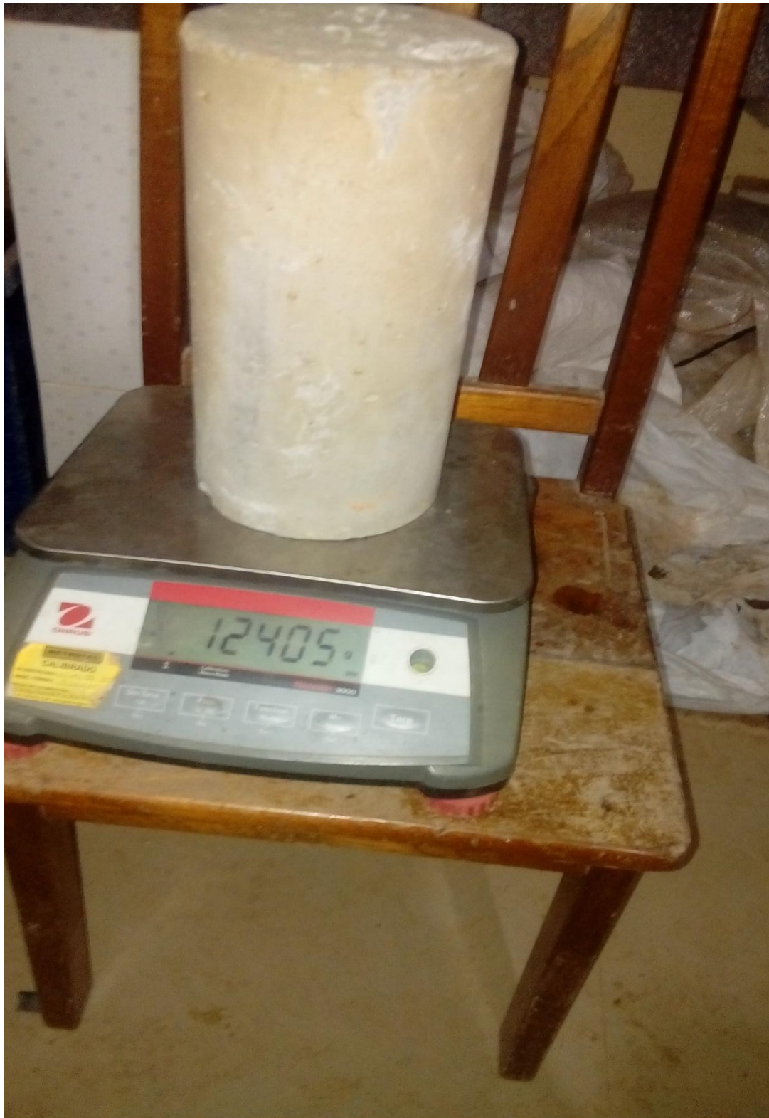
Figura N° 16. Peso de probetas para determinar la absorción de los diseños de mezcla
