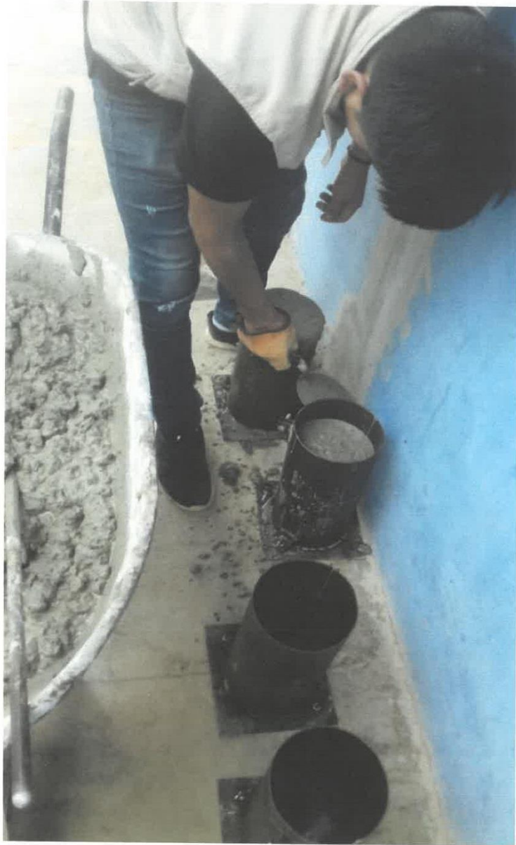
Fotografía N° 10. Colocación de diseños concreto en probetas
