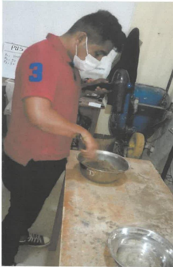
Fotografía N° 05. Secado de agregado fino manualmente para el SSS (secado superficialmente seco).
