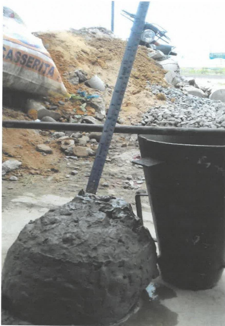
Fotografía N° 09. Slump del concreto con 15% de vidrio reciclado molido
