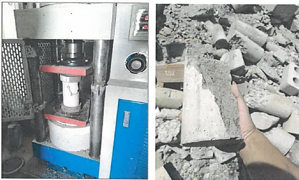
Vista N°35: Proceso de rotura, testigos de mortero de cemento.
