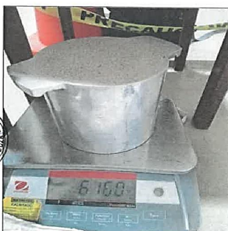
Vista N°26: Pesaje de las muestras con el molde, tratando de evitar diferencias de peso que superen los 5 gramos.
