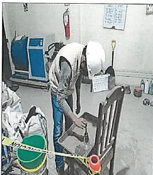
Vista N°20: Determinación del contenido de humedad óptima para el peso específico del agregado fino.
