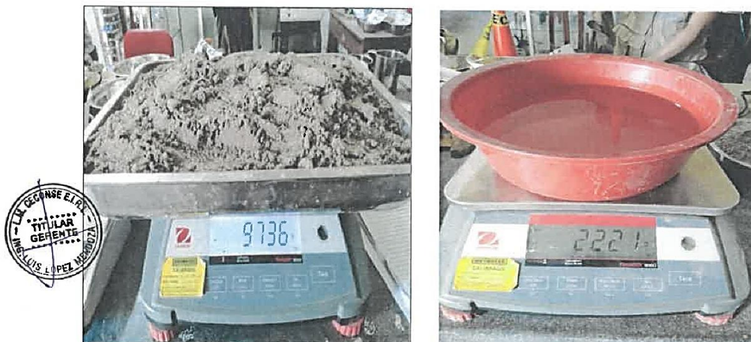
Vista N°27: Procedimiento de la dosificación de los agregados.
