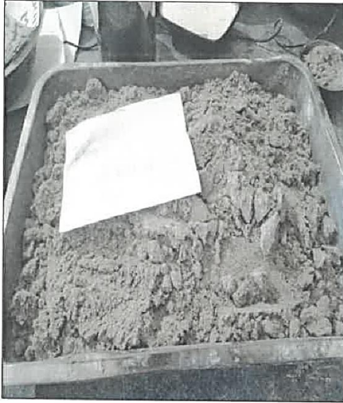
Vista N°16: Procedimiento de selección del agregado fino para el ensayo de contenido de humedad
