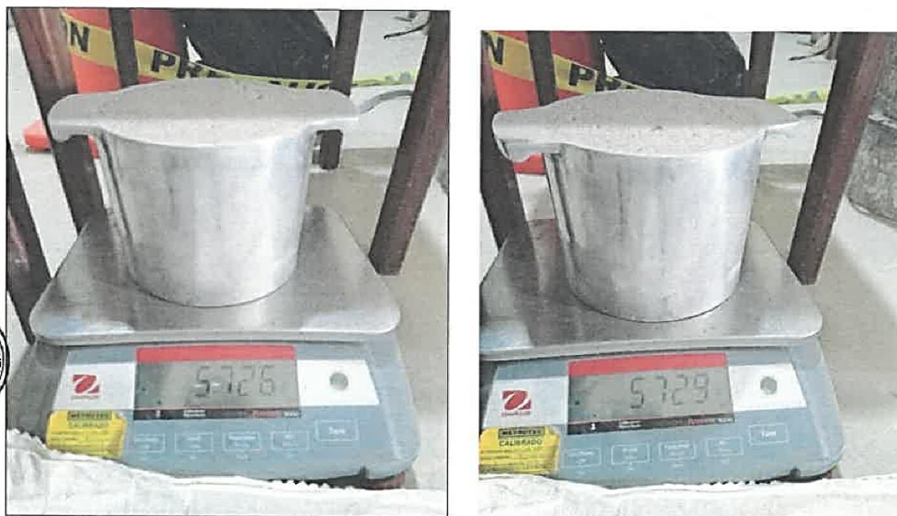
Vista N°24: Pesaje de las muestras con el molde, tratando de evitar diferencias de peso que superen los 5 gramos.
