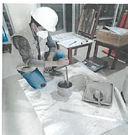
Vista N°25: Vaciado del agregado en el molde y compactación de la misma.
