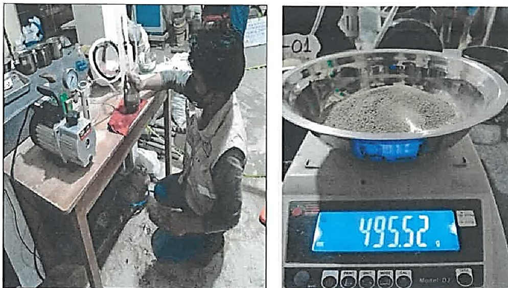
Vista N°22: Extracción del aire del agregado fino + agua y pesaje de los mismos.
