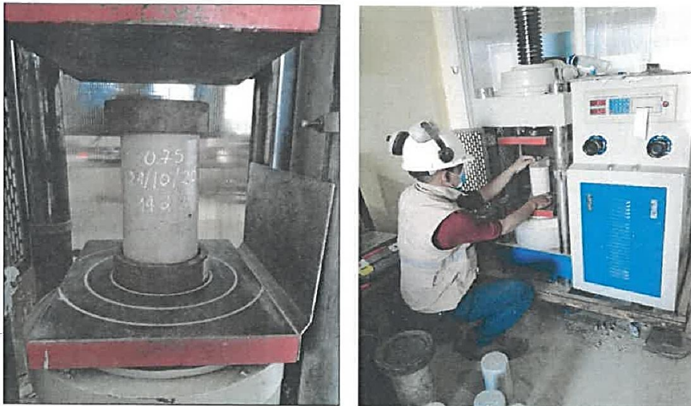
Vista N°34: Colocación de los testigos en la prensa hidráulica.
