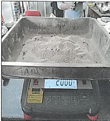
Vista N°18: Pesado de muestra y saturación de la misma para el ensayo de granulometría y tamizado.
