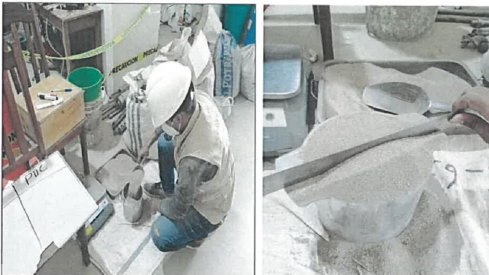
Vista N°23: Vaciado del agregado en el molde y nivelación.
