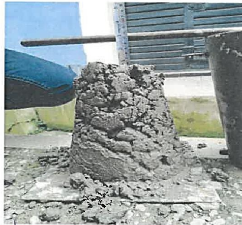
Vista N°30: Procedimiento para el ensayo de asentamiento del cono de Abrams.
