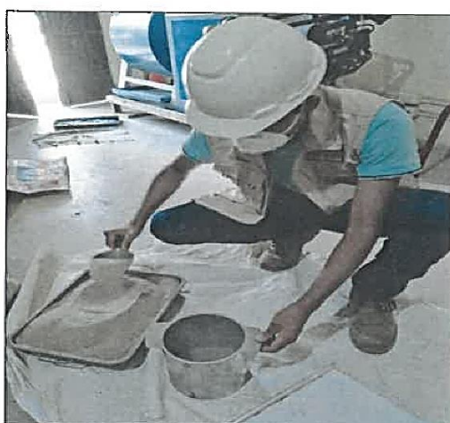
Vista N°25: Vaciado del agregado en el molde y compactación de la misma.
