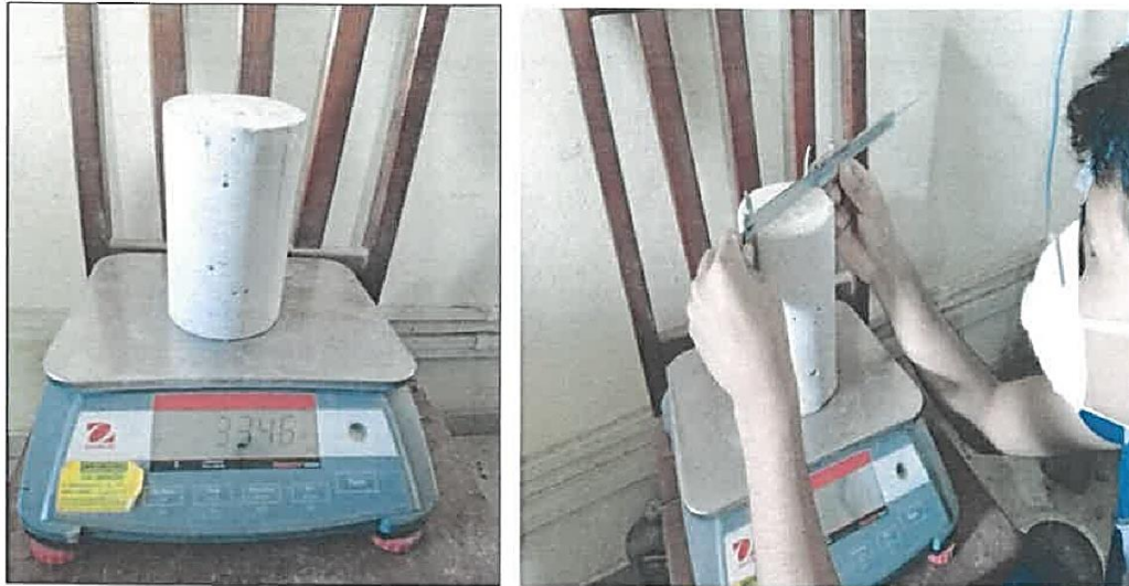
Vista N°33: Pesado y medición de los testigos de mortero.
