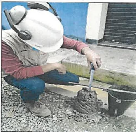
Vista N°30: Procedimiento para el ensayo de asentamiento del cono de Abrams.
