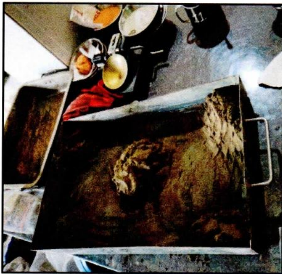
Fotografía N° 06: Evidencia de la muestra patrón dividido en 5 proporciones similares para el ensayo de Proctor modificado
