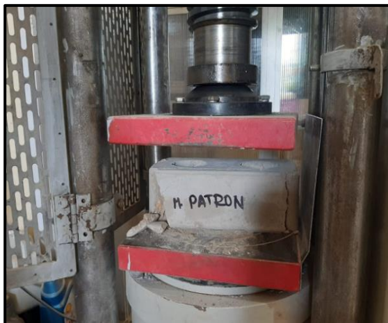
Fotografía N° 35: evidencia del ensayo de resistencia a la compresión a la muestra patrón.
