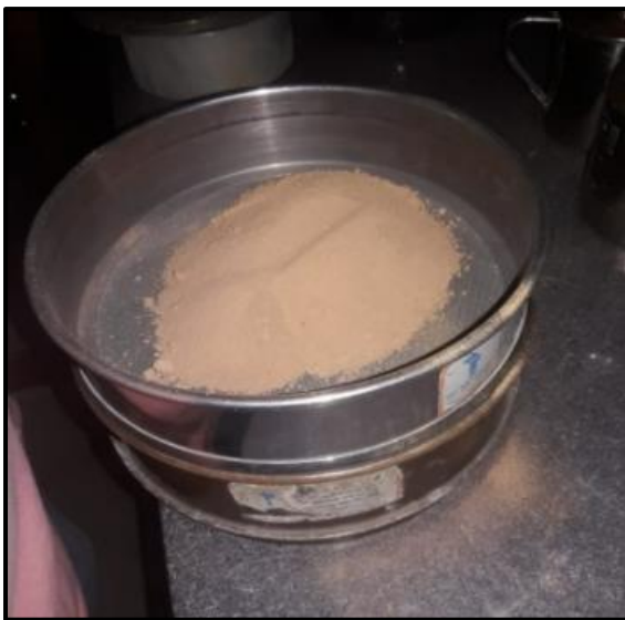
Fotografía N° 03: Tamizado de la muestra para el ensayo de límite de atterberg
