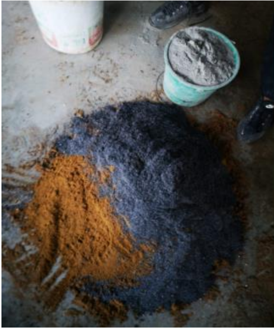
Fotografía N° 25: Evidencia de la dosificación de la muestra con el 3% de cenizas de cascarilla de arroz, para la elaboración de los ladrillos.
