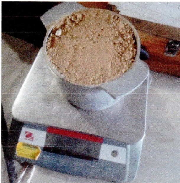
Fotografía N° 10: Evidencia del peso compactado del ensayo del peso unitario
