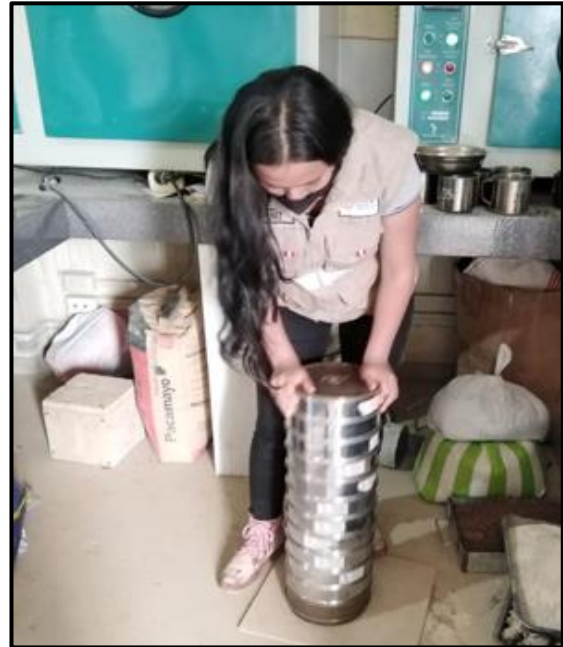
Fotografía N° 10: Evidencia del tamizado de la muestra para el ensayo de granulometría
