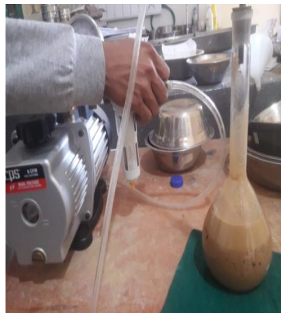
Fotografía N° 12: Evidencia del ensayo de peso específico
