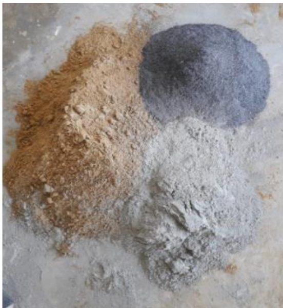
Fotografía N° 27: Evidencia de la dosificación de la muestra con el 9% de cenizas de cascarilla de arroz, para la elaboración de los ladrillos.
