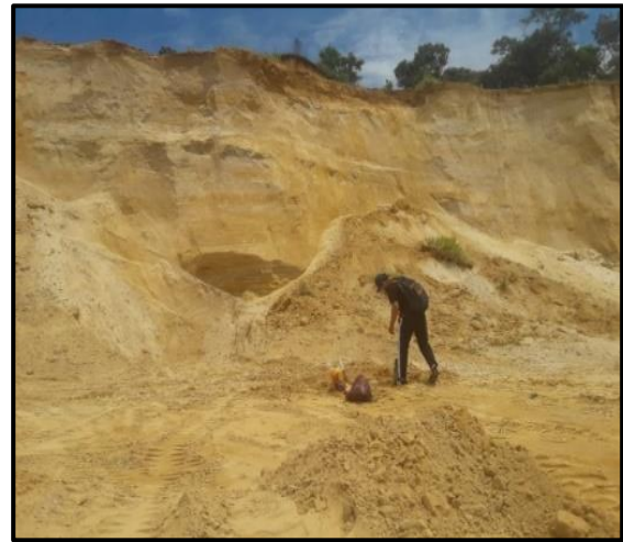
Fotografía N° 02: Extracción de la muestra para ser evaluado en el laboratorio de suelos
