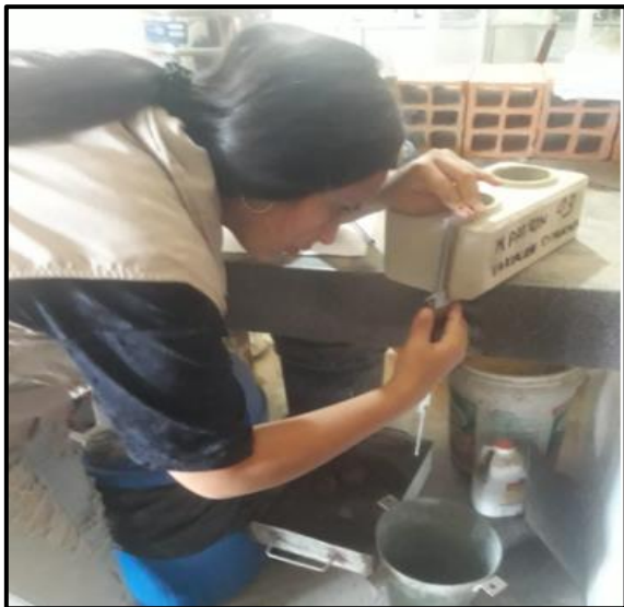
Fotografía N° 39: anotación de las medidas del ladrillo para el ensayo de variación dimensional
