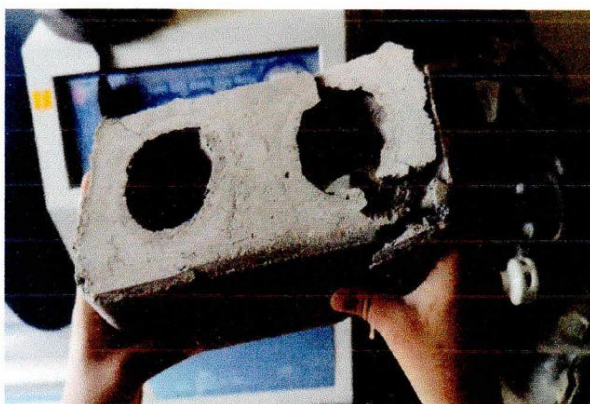
Fotografía N° 14: Evidencia de la rotura del ladrillo después de ser sometido a la compresión.
