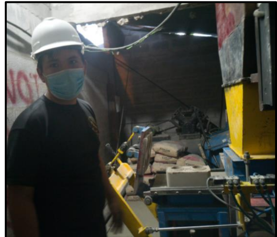
Fotografía N° 34: Evidencia de la fabricación de los ladrillos alveolares ecológicos comprimidos con la incorporación del 9% ceniza de cascarilla de arroz
