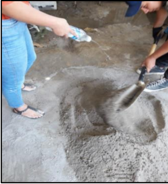
Fotografía N° 29: Agregado de porcentaje de agua a la mezcla para la elaboración de los ladrillos
