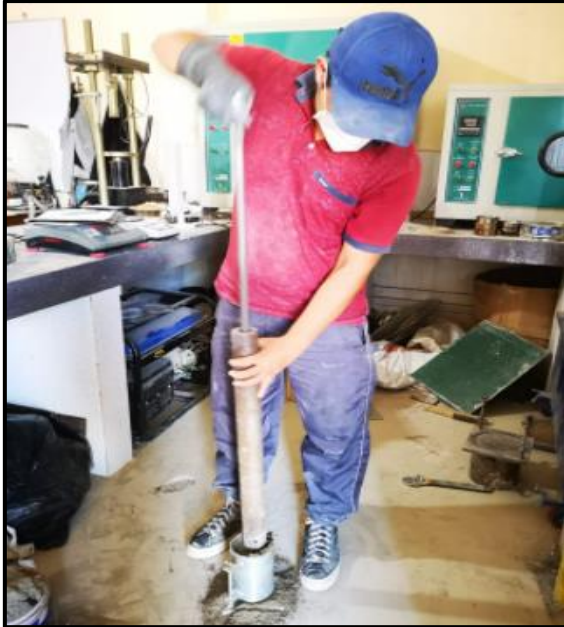
Fotografía N° 21: Evidencia del manejo del pistón en el Proctor del suelo natural + el 6% de ceniza de cascarilla arroz +20 de cemento
