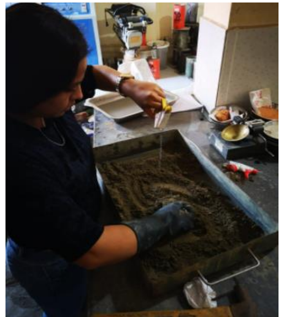
Fotografía N° 20: Evidencia del porcentaje de agua agregado para el ensayo de Proctor modificado.
