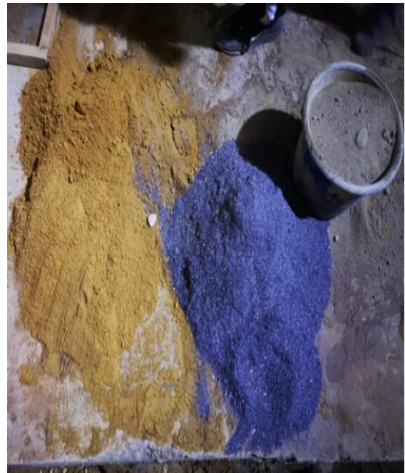
Fotografía N° 26: Evidencia de la dosificación de la muestra con el 6% de cenizas de cascarilla de arroz, para la elaboración de los ladrillos.
