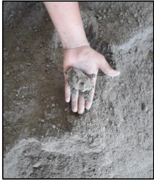
Fotografía N° 30: Prueba empírica para saber si la mezcla tiene el % de agua óptimo
