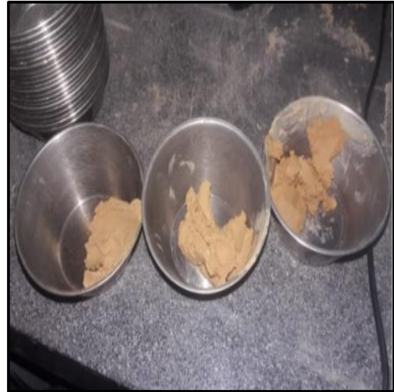
Fotografía N° 06: Evidencia de la muestra seca del ensayo de limite liquido
