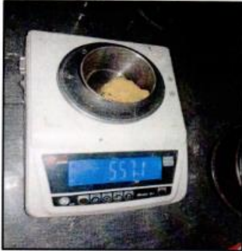
Fotografía N° 03: Peso de la muestra seca después de realizarse el ensayo de limite liquido
