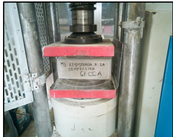
Fotografía N° 36: evidencia del ensayo de resistencia a la compresión a la muestra experimental con la incorporación de CCA.
