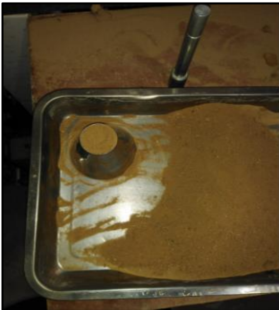
Fotografía N° 11: Evidencia del suelo superficialmente seco apto para realizar el ensayo de peso específico
