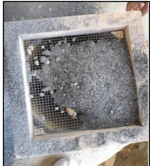
Fotografía N° 24: Evidencia del tamizado de la ceniza de cascarilla de arroz.
