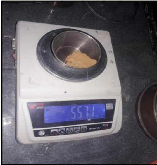
Fotografía N° 05: Peso de la muestra seca después de realizarse el ensayo de limite liquido
