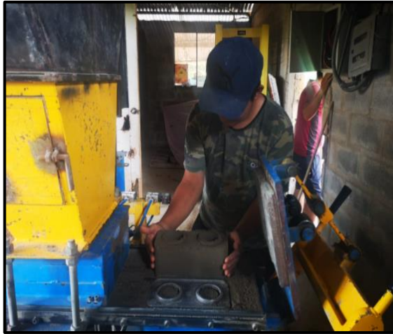
Fotografía N° 33: Fabricación de los ladrillos alveolares ecológicos comprimidos con la incorporación de 6 % ceniza de cascarilla de arroz
