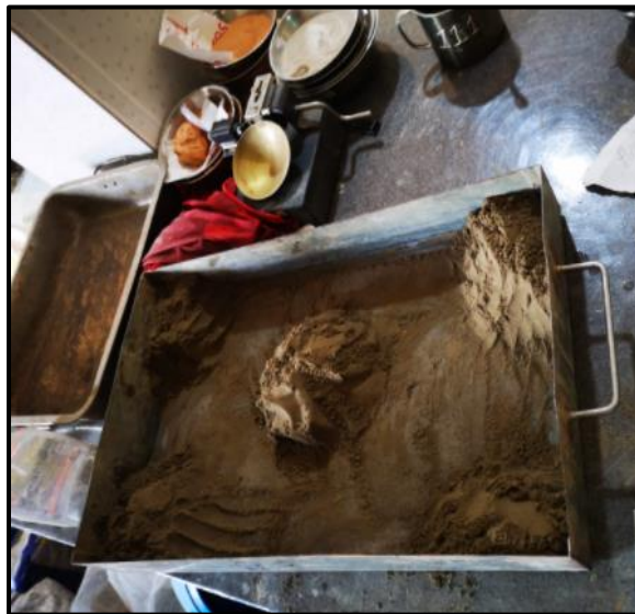
Fotografía N° 15: Evidencia de la muestra patrón dividido en 5 proporciones similares para el ensayo de Proctor modificado
