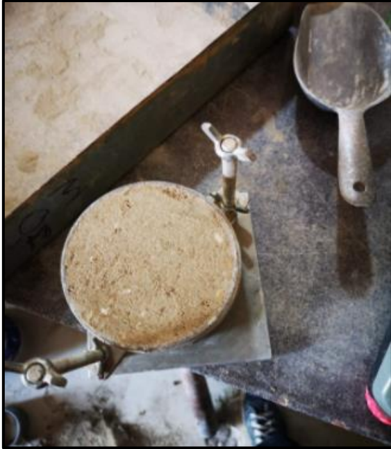
Fotografía N° 17: Evidencia del ensayo de Proctor modificado (suelo compactado)
