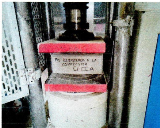
Fotografía N° 13: Evidencia del ladrillo en la compresora antes del esfuerzo a la compresión.
