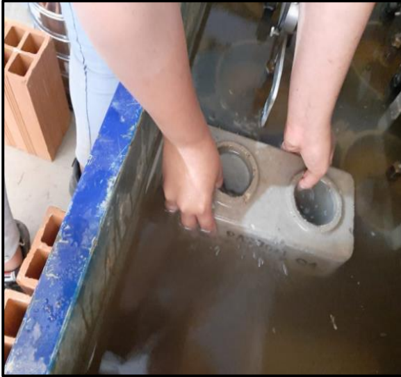
Fotografía N° 37: ladrillo sometido a la humedad por 24 horas para el ensayo de absorción
