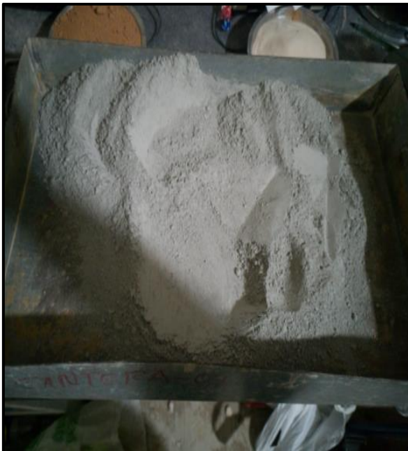
Fotografía N° 19: Evidencia de la dosificación del diseño de mezcla para el ensayo de Proctor modificado.
