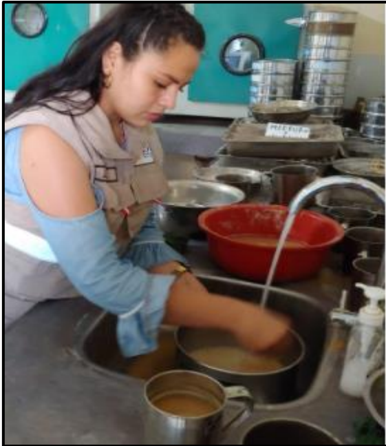
Fotografía N° 09: Evidencia del lavado de la muestra para el ensayo de granulometría
