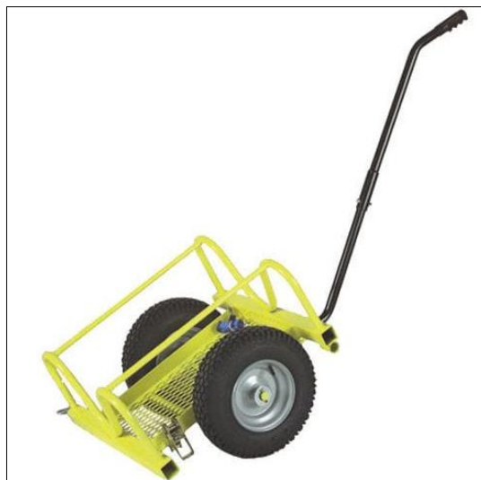
Figura N° 1: Máquina 1 - Carreta para tubos de 2 llantas
