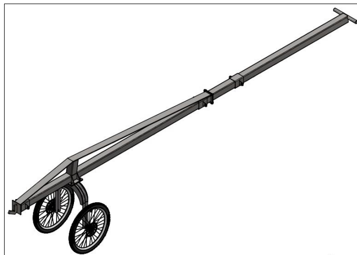
Figura N° 3: Máquina 3 – Carrier de 2 llantas para manipular tubería
