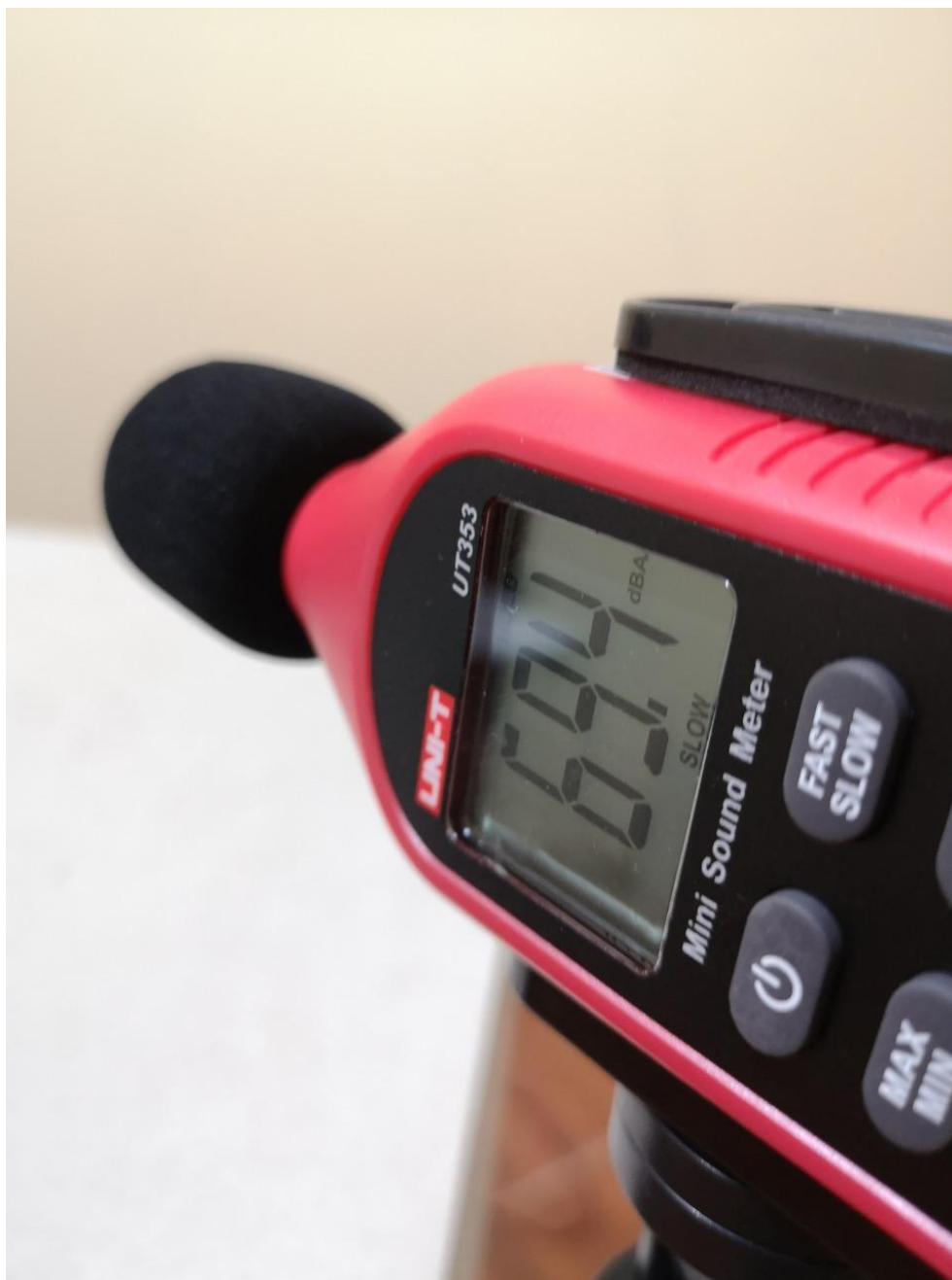
16. Mediciones del nivel de sonido con el sonómetro utilizando los diferentes materiales en las cajas insonorizadas.
