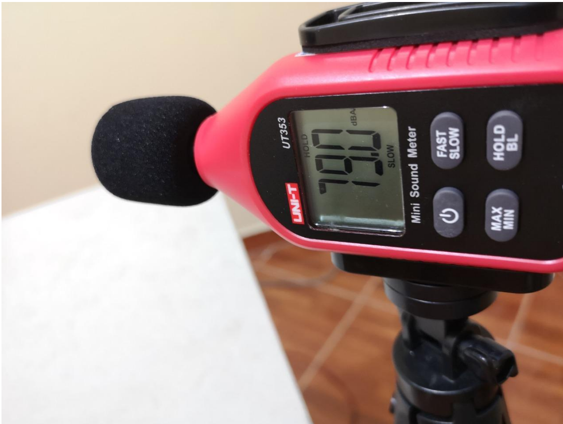
15. Mediciones del nivel de sonido con el sonómetro utilizando los diferentes materiales en las cajas insonorizadas.
