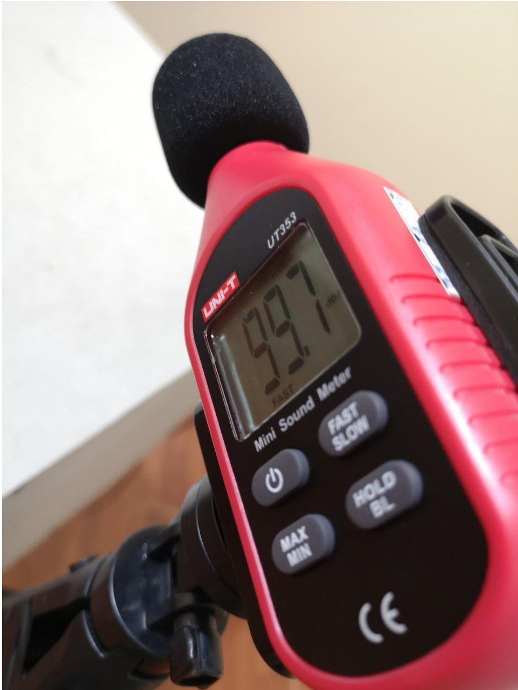
14. Mediciones del nivel de sonido con el sonómetro utilizando los diferentes materiales en las cajas insonorizadas.
