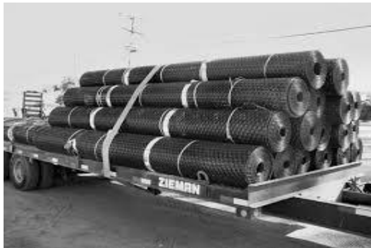
Figura N°01: Almacenamiento de los rollos de Geomallas Triaxial
