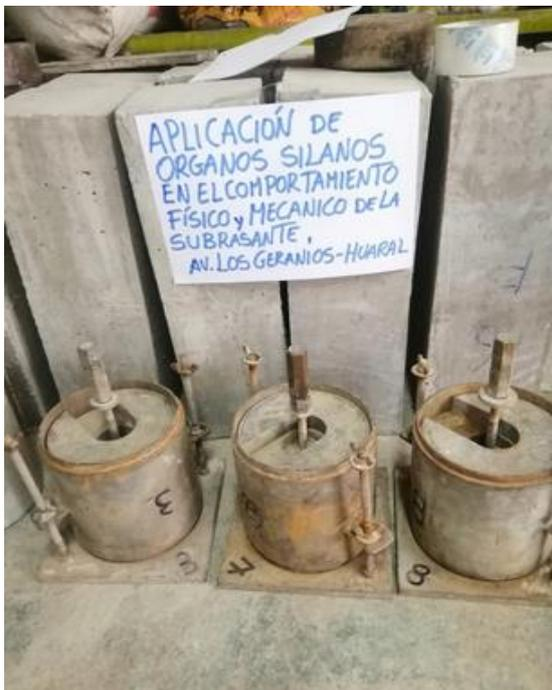
**Figura 13.** Ensayo CBR
