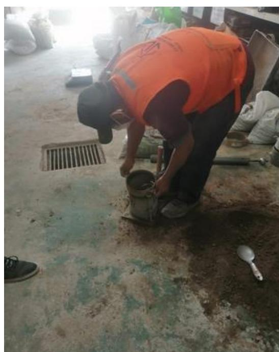
**Figura 13.** Ensayo proctor modificado
