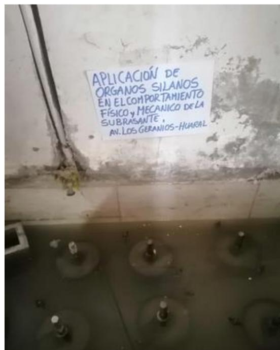
**Figura 14.** Ensayo CBR
