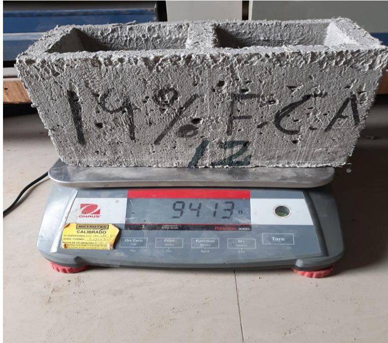
Foto 12: PESADO DE LOS BLOQUES PARA POSTERIORMENTE REALIZAR EL ENSAYO DE RESISTENCIA A LA COMPRESION
