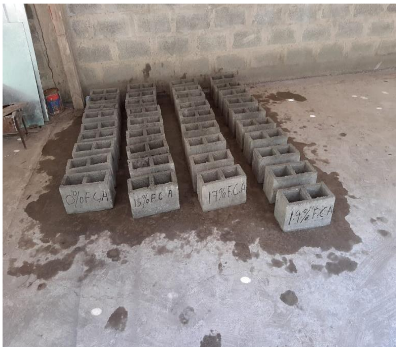
Foto 11: APILADO DE LOS BLOQUES DE CONCRETO CON INCORPORACION DE FIBRA DE CAÑA DE AZUCAR EN PRCENTAJES DEL 15%, 17% Y 19% RESPECTIVAMENTE
