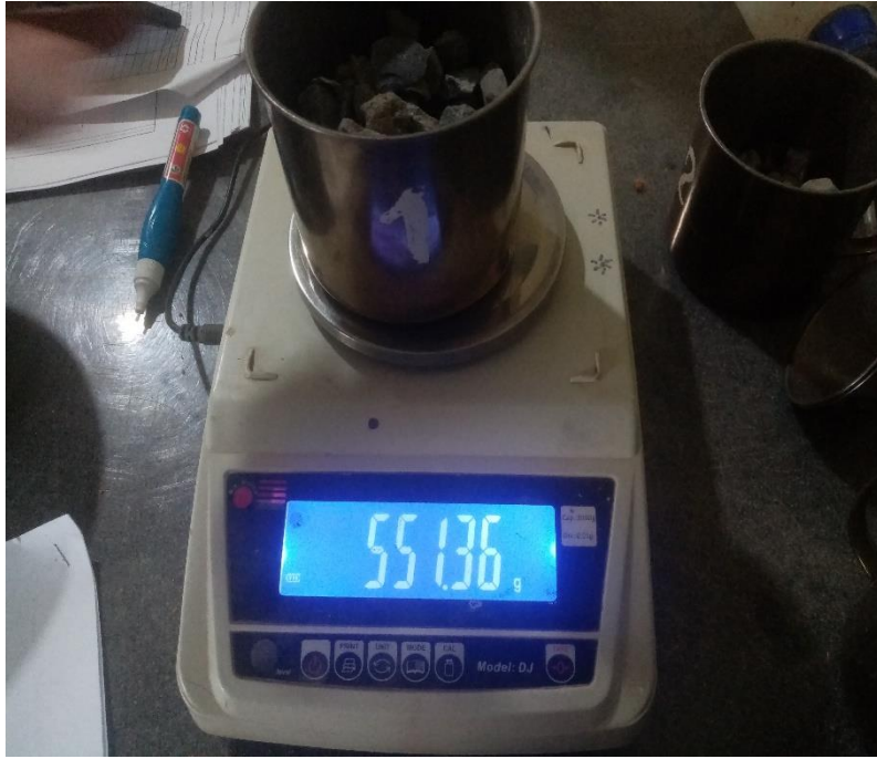
Foto 7: SE OBSERVA EL ENSAYO DE PESO UNITARIO DE LA MUESTRA SUELTA Y COMPACTADA
