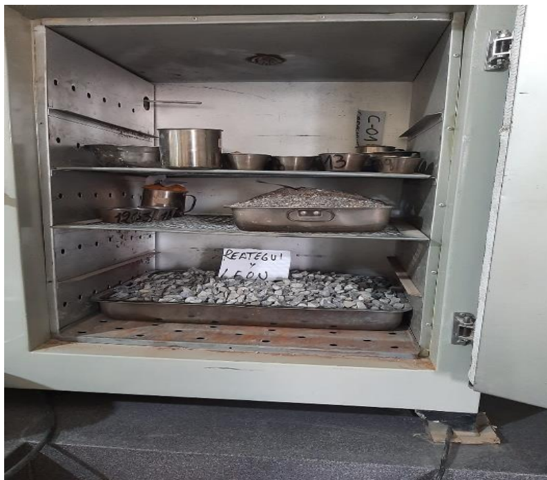
Foto 6: REALIZANDO EL ENSAYO DE HUMEDAD NATURAL LO CUAL SE ESTA HACIENDO EL PROCESO DE SECADO
