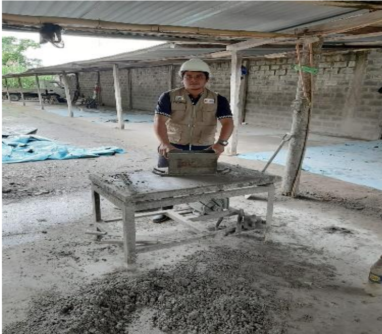
Foto 10: COMPACTADO DE LA MEZCLA EN EL MOLDE
