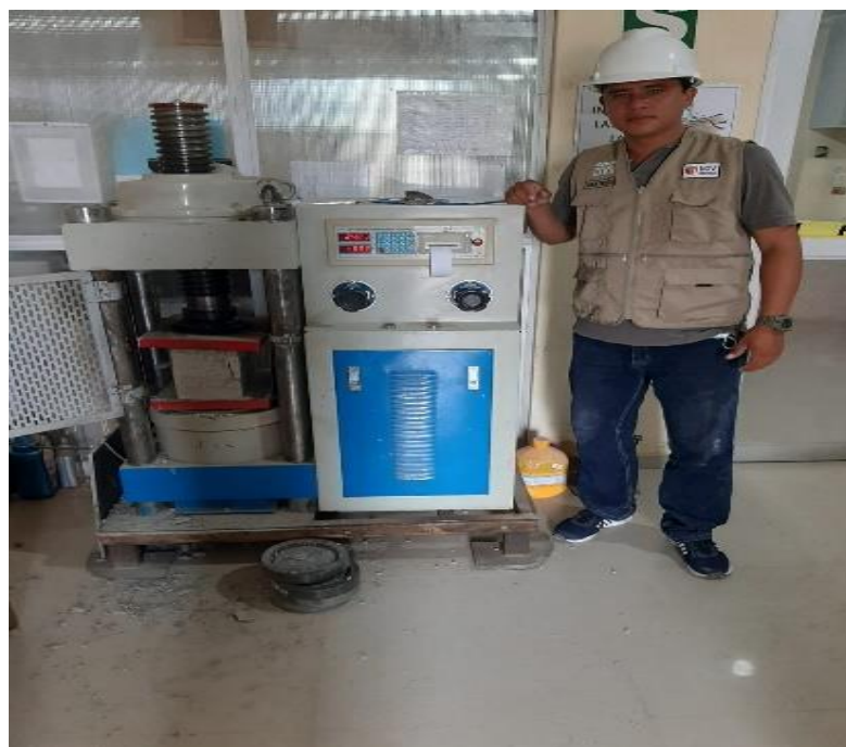
Foto 13: SE OBSERVA EL ENSAYO DE RESISTENCIA DE COMPRESION DE LOS BLOQUES DE CONCRETO CON ADICION DE FIBRA DE CAÑA DE AZUCAR
