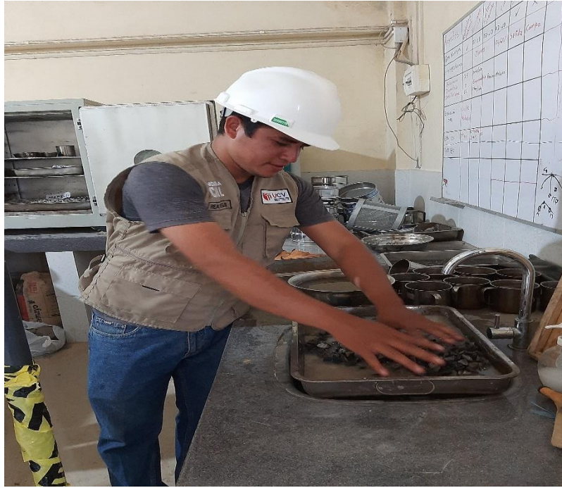
Foto 5: LAVADO DEL AGREGADO GRUESO PARA SU POSTERIOR ENSAYO DE GRANULOMETRIA
