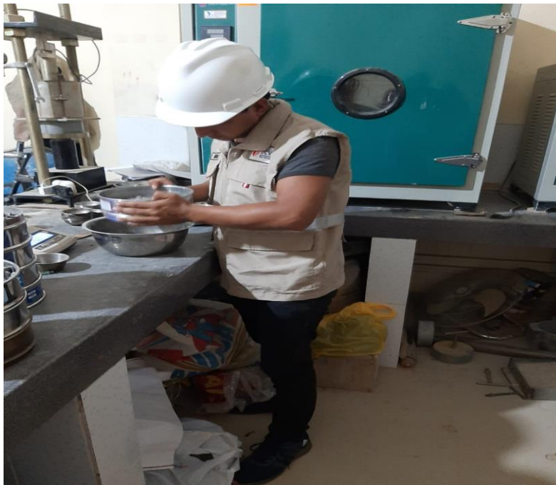
Foto 8: SE OBSERVA EL ENSAYO DE GRANULOMETRIA POR LA MALLA N° 200
