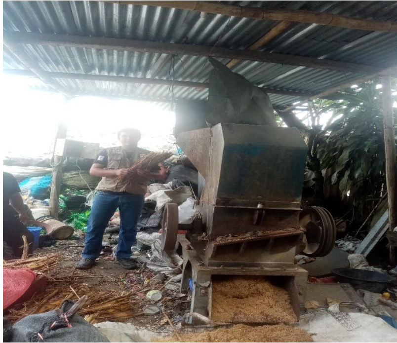
Foto 3: TRITURACION DEL BAGAZO DE LA CAÑA DE AZUCAR
