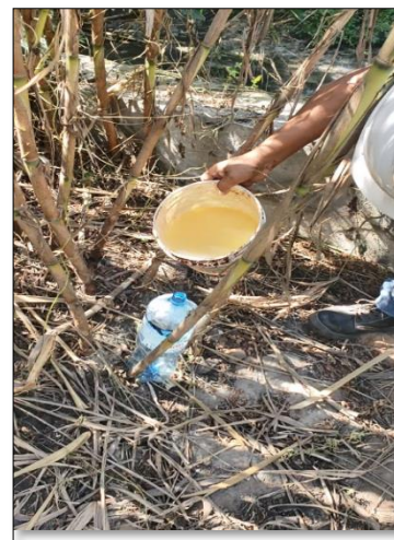
Imagen 15-16 Toma de muestra en situ para identificar el nivel de contaminación del agua residual
