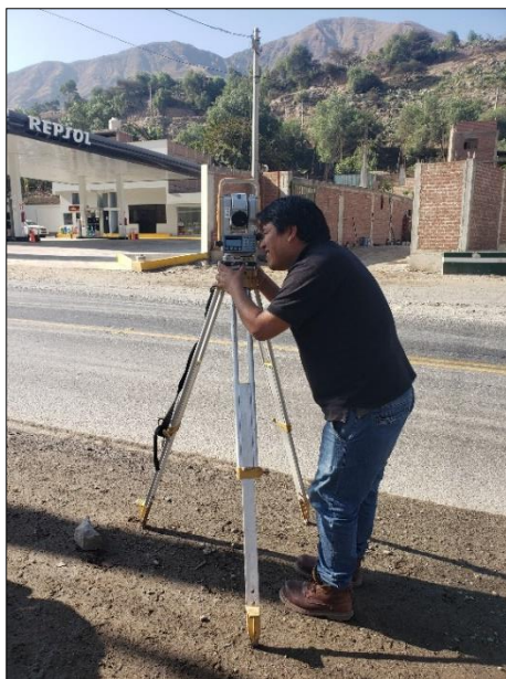
Imagen 10: calibrando equipo de alta precisión - estación total.
