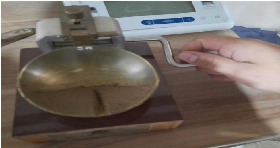
*Imagen 3: ensayo Limite Liquido*
