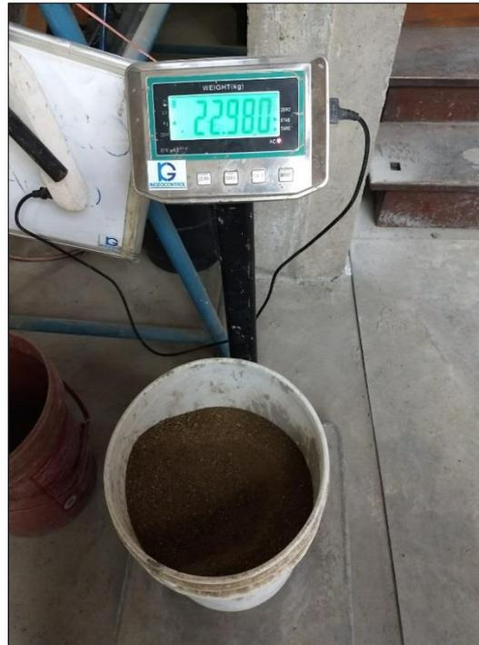
Figura N° 12 Diseño de mezcla Patrón Confitillo y Agregado Fino
