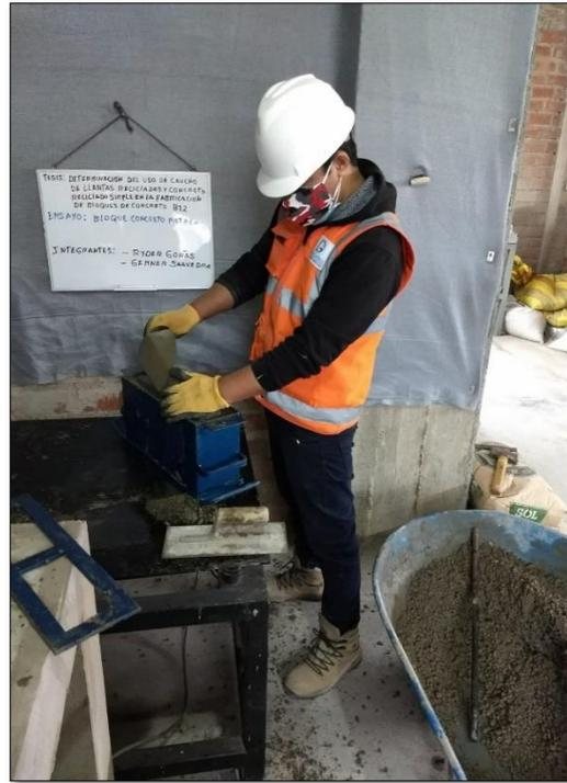
Figura N° 13 Mezclado concreto patrón y Vibrado – Molde metálico.
