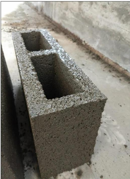
Figura N° 14 Desmolde Bloque patrón.
