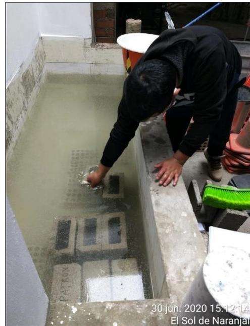
Figura N° 24 Pesado de los bloques, estado seco y Saturación 24 horas.
