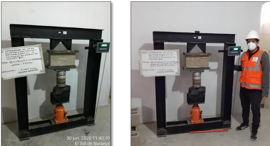
Figura N° 26 Bloque Patrón y Bloque CRS 35% y CR 5%.
