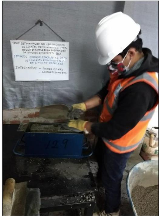
Figura N° 19 Mezclado 35% CRS y 10% CR y Llenado de molde (35 y 10)
