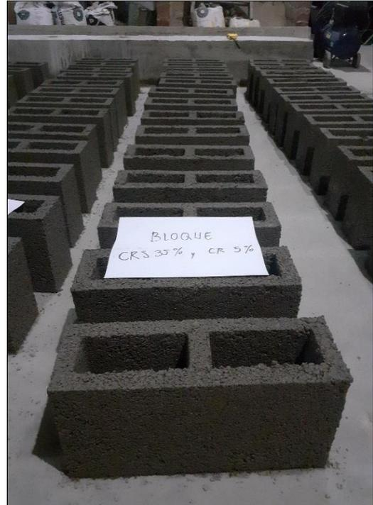
Figura N° 17 Desmolde (35%CRS y 5%CR) y Bloques (35%CRS y 5%CR)
