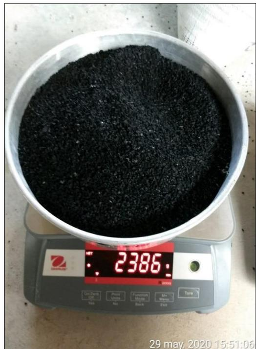
Figura N° 18 Pesado de agregados (35% y 10%) y caucho reciclado 10%
