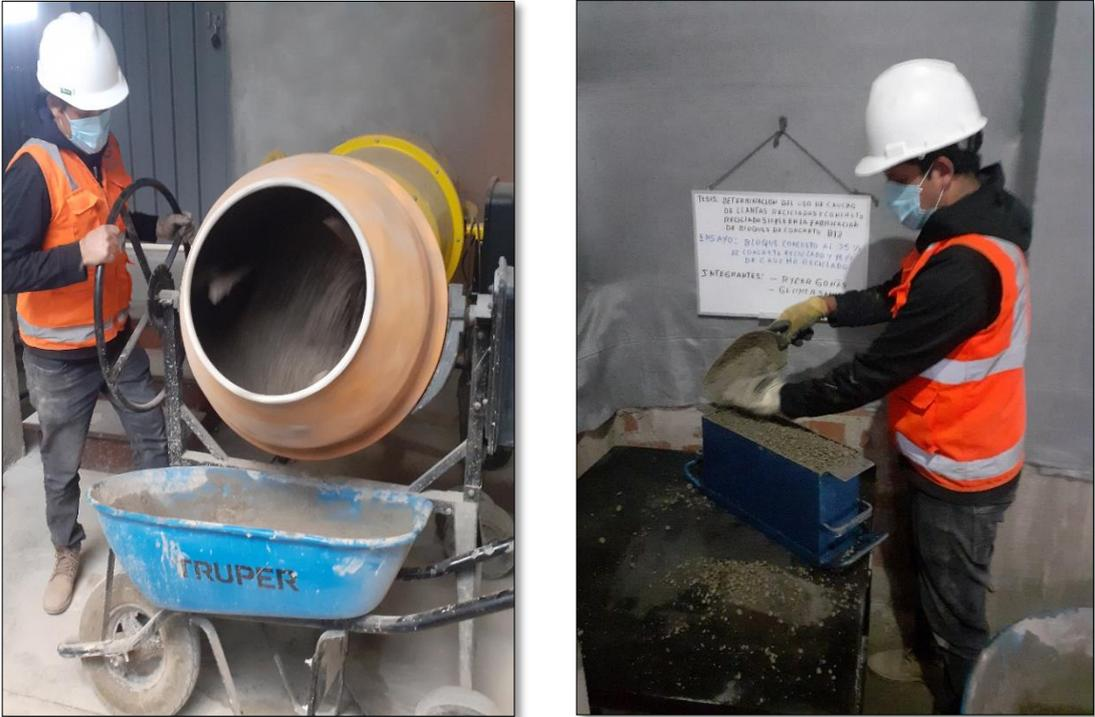
Figura N° 22 Vaciado y Lleno de molde (35% y 15%)
