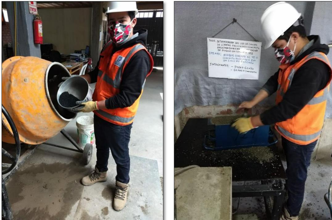
Figura N° 16 Mezclado (35%CRS y 5%CR) y Vibrado (35%CRS y 5%CR)
