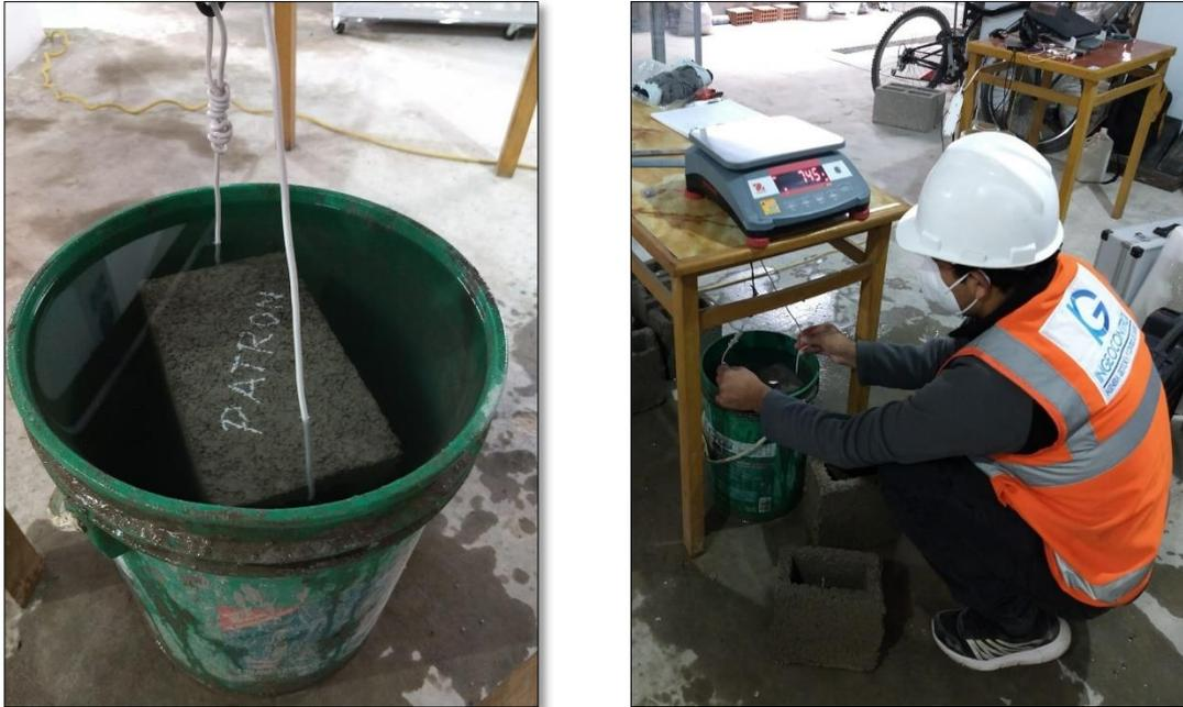
Figura N° 25 Pesado de bloque sumergido patrón.
