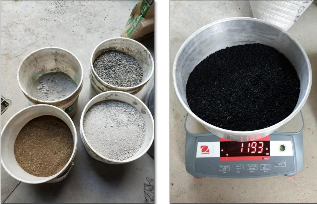
Figura N° 15 Mezcla – Pesado de agregados y Pesado caucho reciclado 5%.
