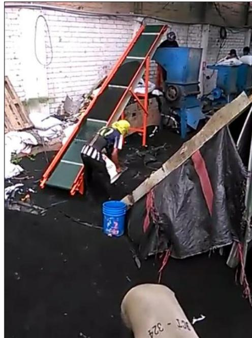
Figura N° 6 Trituración – Concreto Reciclado y Caucho Reciclado (Star Grass Perú S.A.C)
