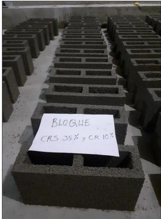
Figura N° 20 Desmolde CRS 35% y CR 10% y Bloque CRS 35% y CR 10%
