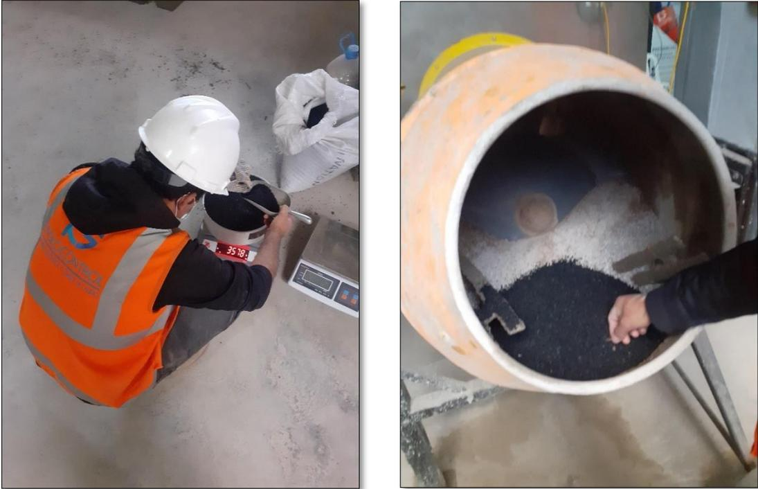
Figura N° 21 Pesado caucho y Mezclado (35 y 15)
