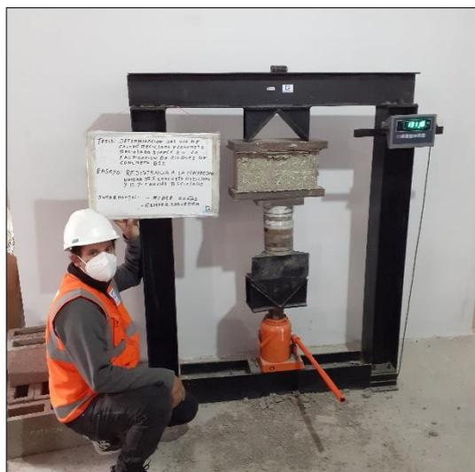
Figura N° 27 Bloque CRS 35% más CR 10% y Bloque CRS 35% más CR 15%.
