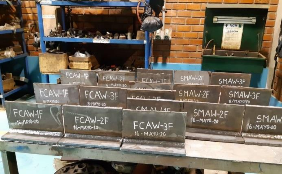
Anexo 25. Figuras de Probetas Finalizas FCAW (parte superior) y SMAW (parte inferior) Utilizadas para la Investigación.
