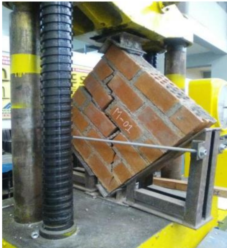
Foto 7: Tabique con ladrillo King Kong 18 huecos 30% donde se examina la falla diagonal en las juntas
