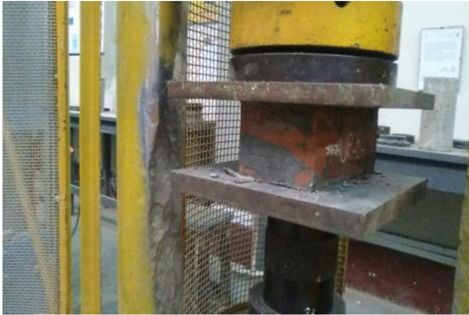
Foto 5: Ensayando la carga Axial al ladrillo King Kong 18 huecos 30% vacíos
