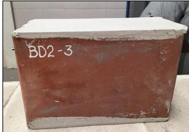
Foto 8: Bloque de Termoarcilla con refrentado superior e inferior.
