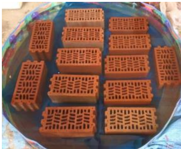
Foto 20: Bloques de Termoarcilla en recipiente de agua para el estudio de absorción
