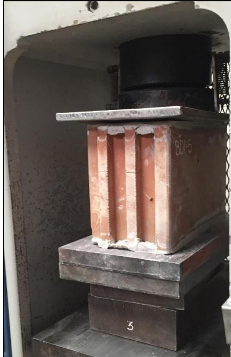
Foto 9: Ensayo de resistencia a la compresión.
