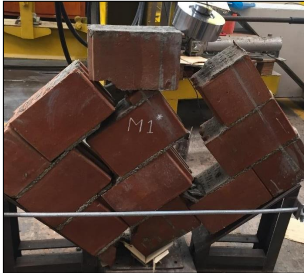
Foto 15: Falla escalonada en murete M – 1*
