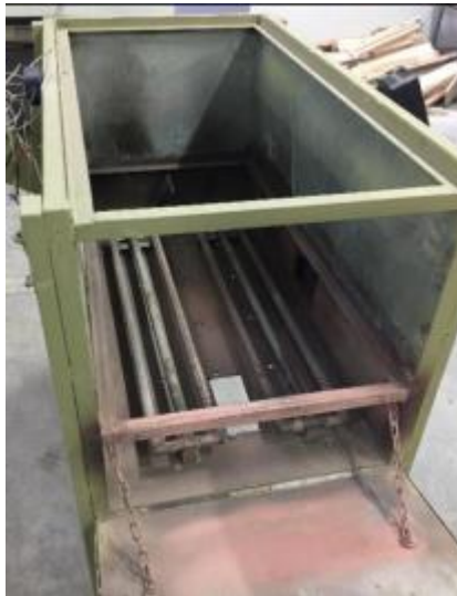
Foto 16: Sistema de quemadores del horno de ensayo
