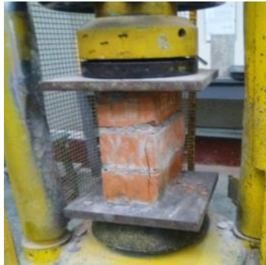
Foto 6: Hilera con Ladrillo King Kong 18 Huecos en la Maquinaria de compresión
