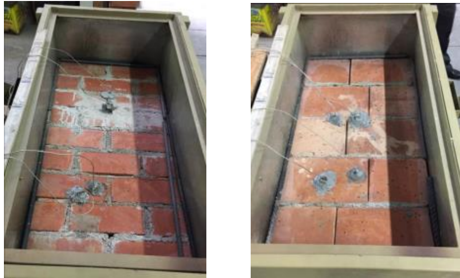
Foto 18: Ensayo Térmico en muro de ladrillo King Kong y muro de bloque de Termoarcilla
