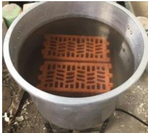
Foto 21: Bloques de Termoarcilla durante el estudio de absorción máxima
