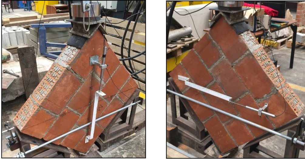
Foto 13: Sensor LVDT vertical (izquierda) y LVDT horizontal (derecha)
