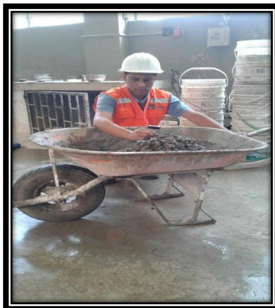
**Figura 10.** Medición de la temperatura del hormigón
