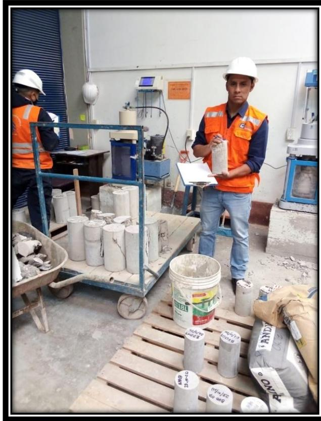
Fotografía N°3: Resistencia de rotura a compresión y tracción
