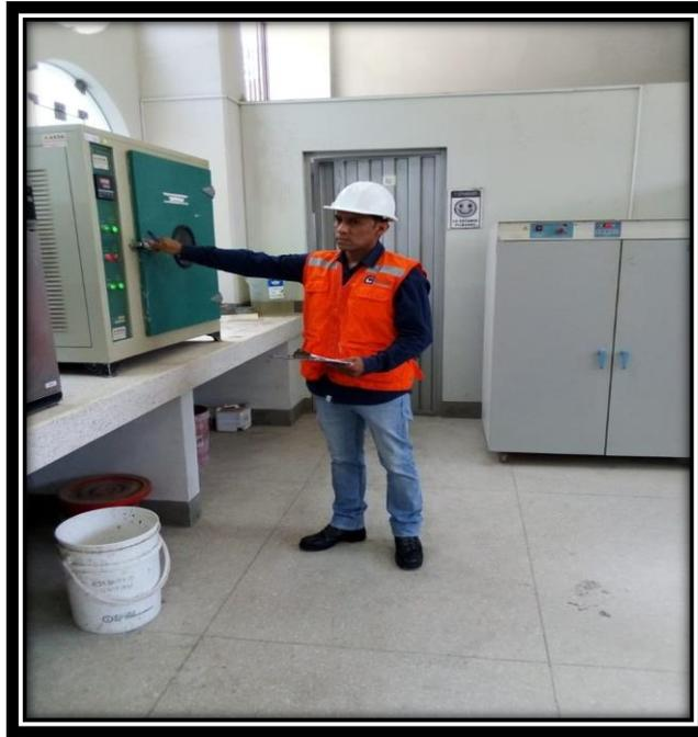
Fotografía N°1: Horno para secado de muestras
