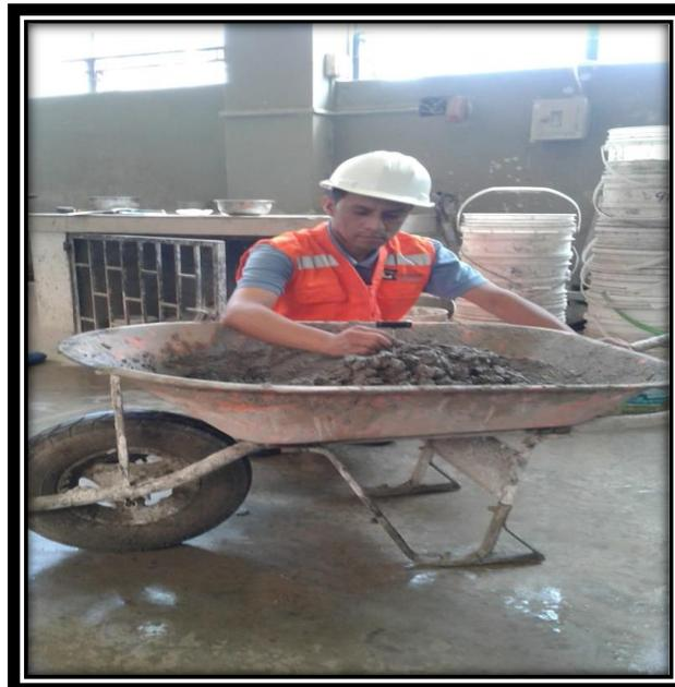
Fotografía N°2: Medida de temperatura del hormigón
