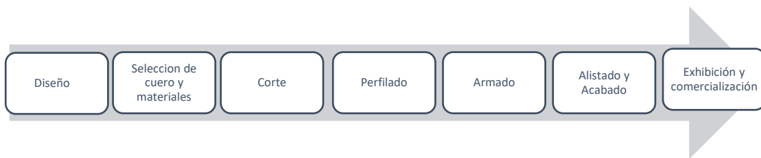
Figura 11. Proceso elaboración de calzado de cuero.
