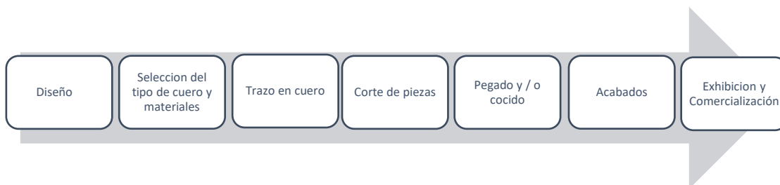
Figura 14. Proceso de producción del taller de elaboración de prendas de cuero. Fuente: Elaboración propia.
