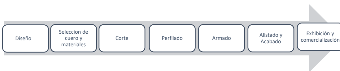
Figura 11. Proceso elaboración de calzado de cuero.
