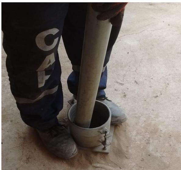
Figura 17. Se observa la compactación por impactos (5 capas).
