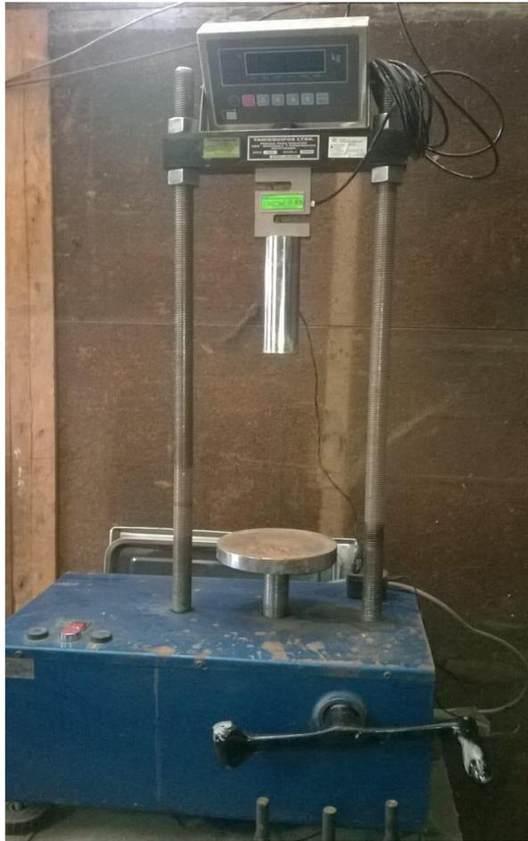
*Figura 20. Máquina para Ensayo de CBR.
