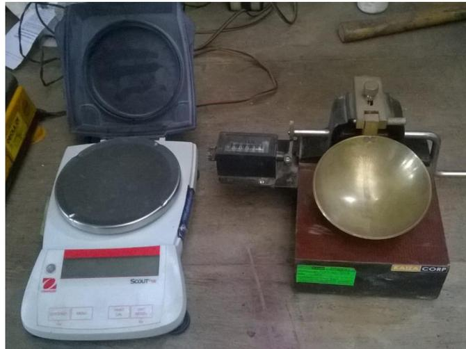
*Figura 11. Balanza electrónica y cuchara de Casagrande.
