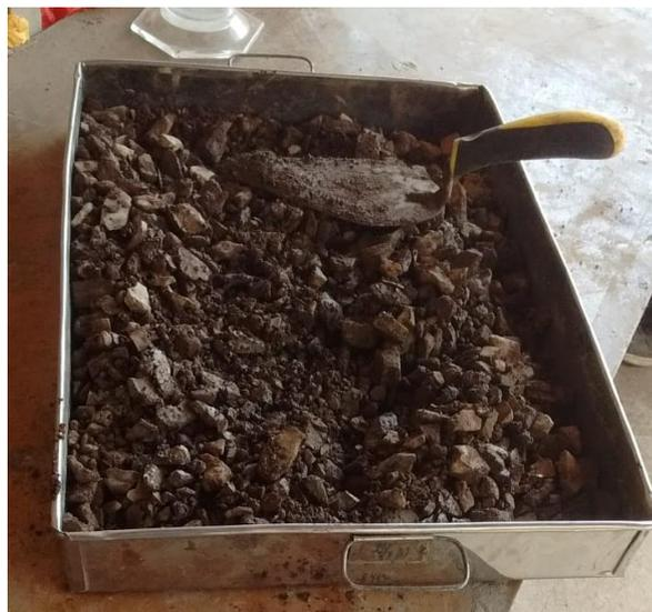
*Figura 16. Mezcla del Suelo con el Contenido de Humedad Optimo.
