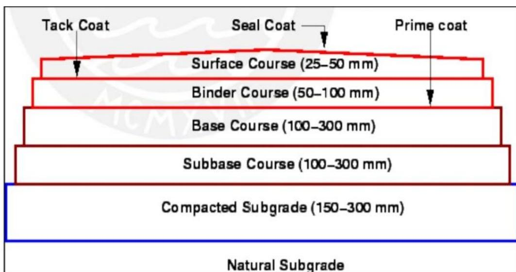
Figura 2: Sección de un pavimento convencional (Huang 2004)
