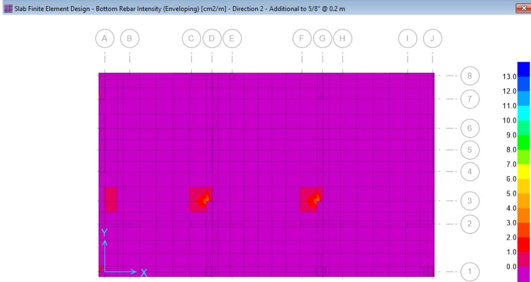
Figura 75. Diseño de platea de cimentación por elementos finitos – Refuerzo Y-Y (Superior  $\text{Ø } 3/4'' @.15$ )
