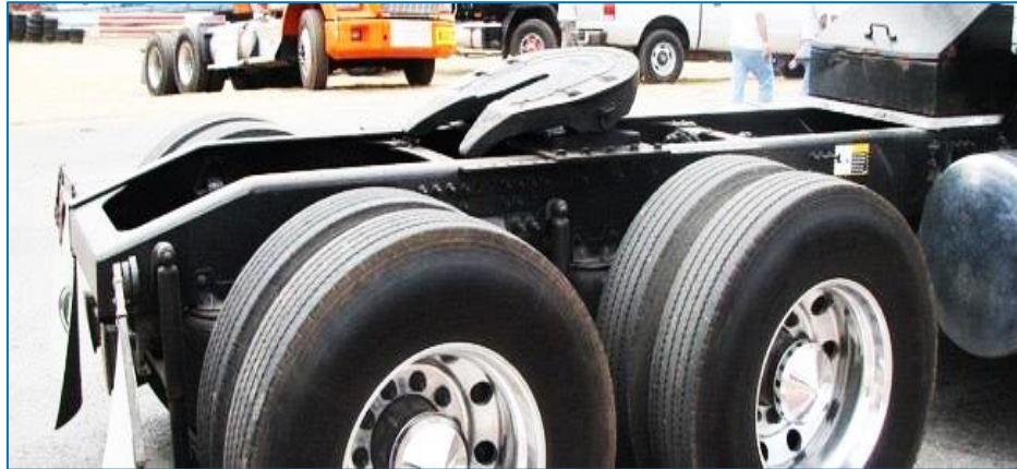
Figura n.º 13. Chasis y quinta rueda en un tracto camión
