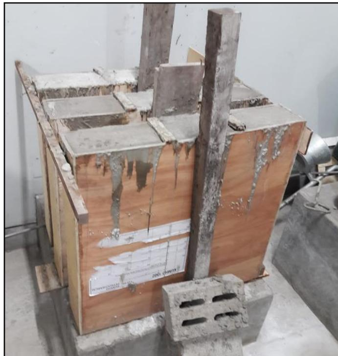
*Figura 48. Vaciado Mortero en 3 Paneles*
