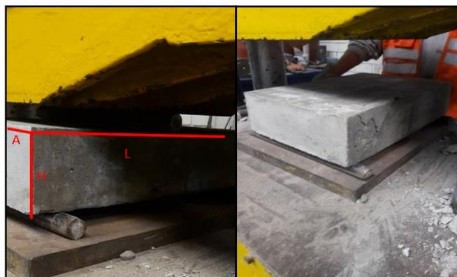
*Figura 51.* Panel de Poliestireno apoyado en 2 varillas, sometido a carga céntrica.
