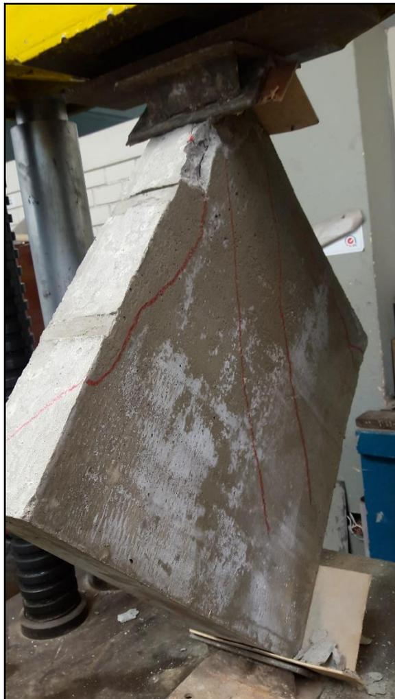
*Figura 61.* Panel de Poliestireno Expandido, sometido a compresión diagonal
