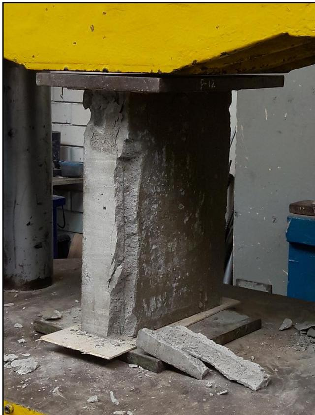
*Figura 56.* Panel de Poliestireno Expandido, sometido a compresión axial
