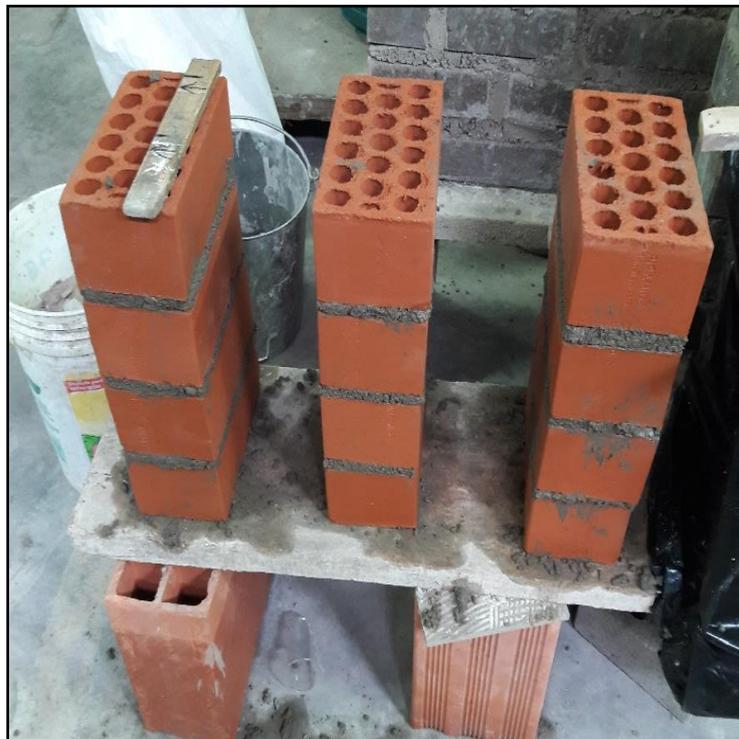
*Figura 25. Pilas de Albañilería*
