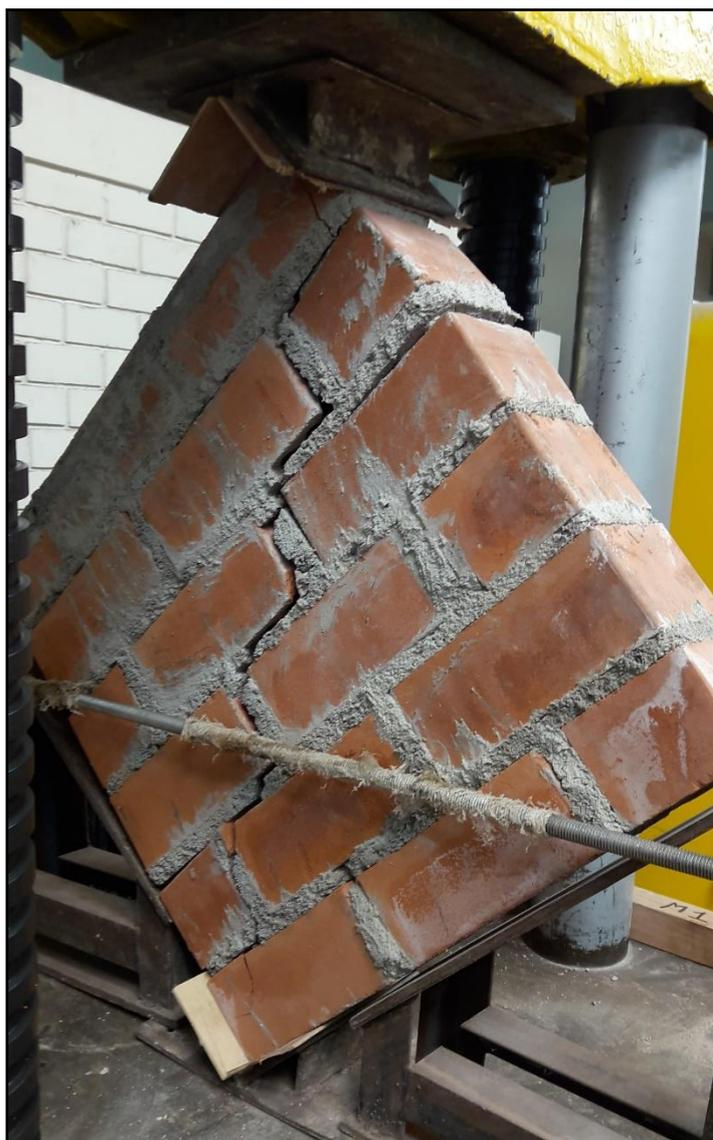
*Figura 59.* Murete de Albañilería, sometido a Compresión Diagonal
