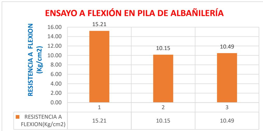
*Figura 50.* Grafica de Modelo de rotura a Flexión
