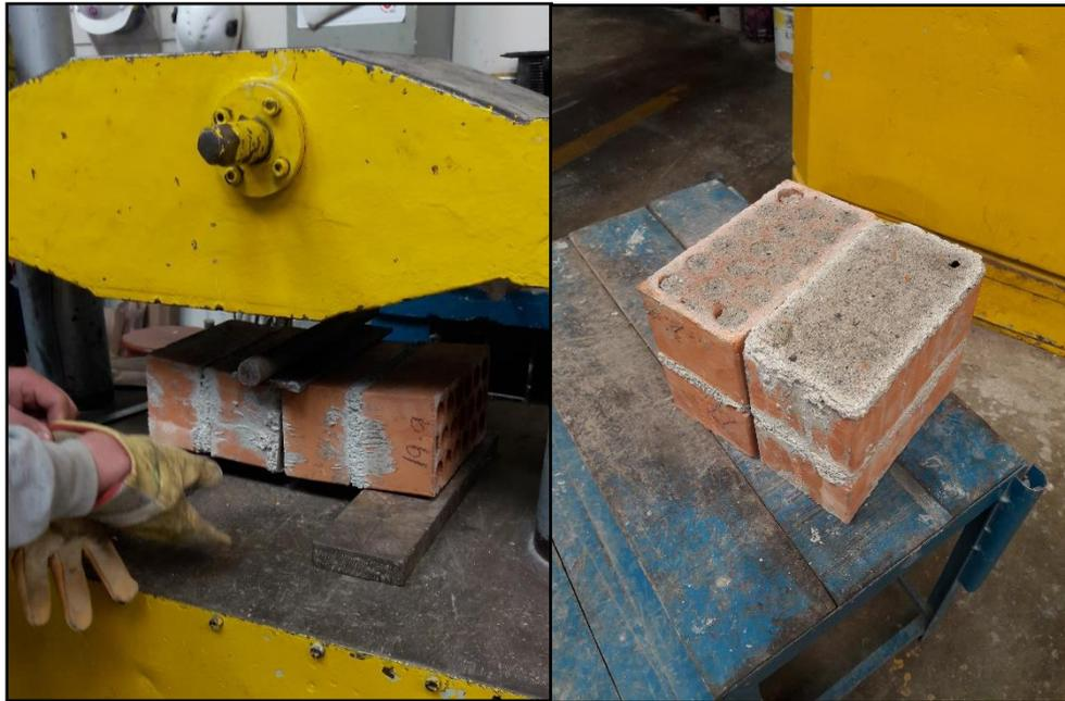
*Figura 49.* Pila con ladrillo King Kong 18 huecos, sometido a una carga al centro de la luz de la pila
