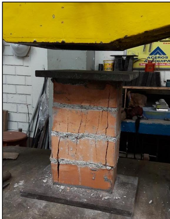
*Figura 54. Pila con ladrillo King Kong, falla por Carga*
