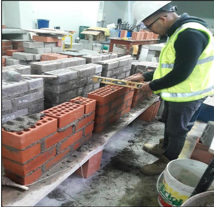
*Figura 31.* Regla de Nivelación de la 4ta hilada de los muretes
