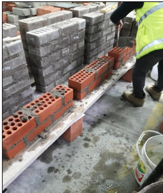
*Figura 30. Colocación de mortero en las juntas*
