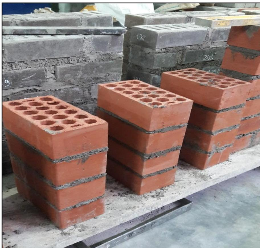
*Figura 26. Pilas de Albañilería*
