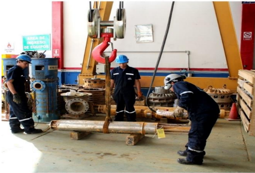
Figura.04. Motor eléctrico sumergible.
