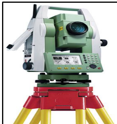
Figura N°03. Equipos Utilizados en Campo – Estación Total
