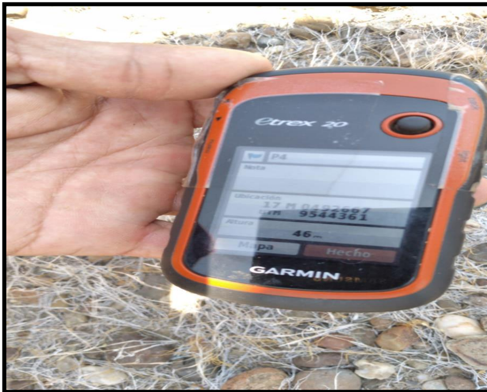
FiguraN°11: Vista de levantamiento de coordenadas con GPS.
