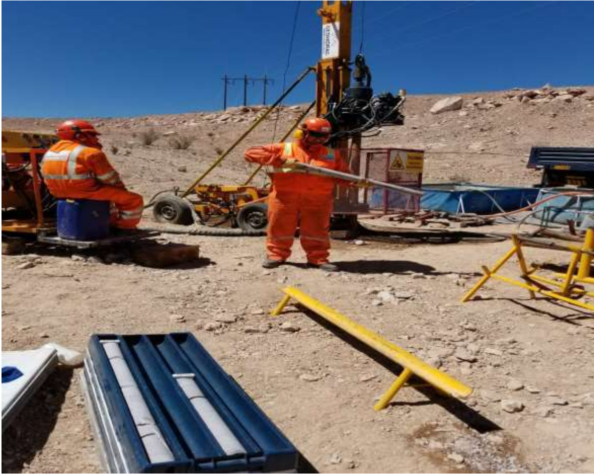
Descripción: Recuperación de muestras – Perforación diamantina.
