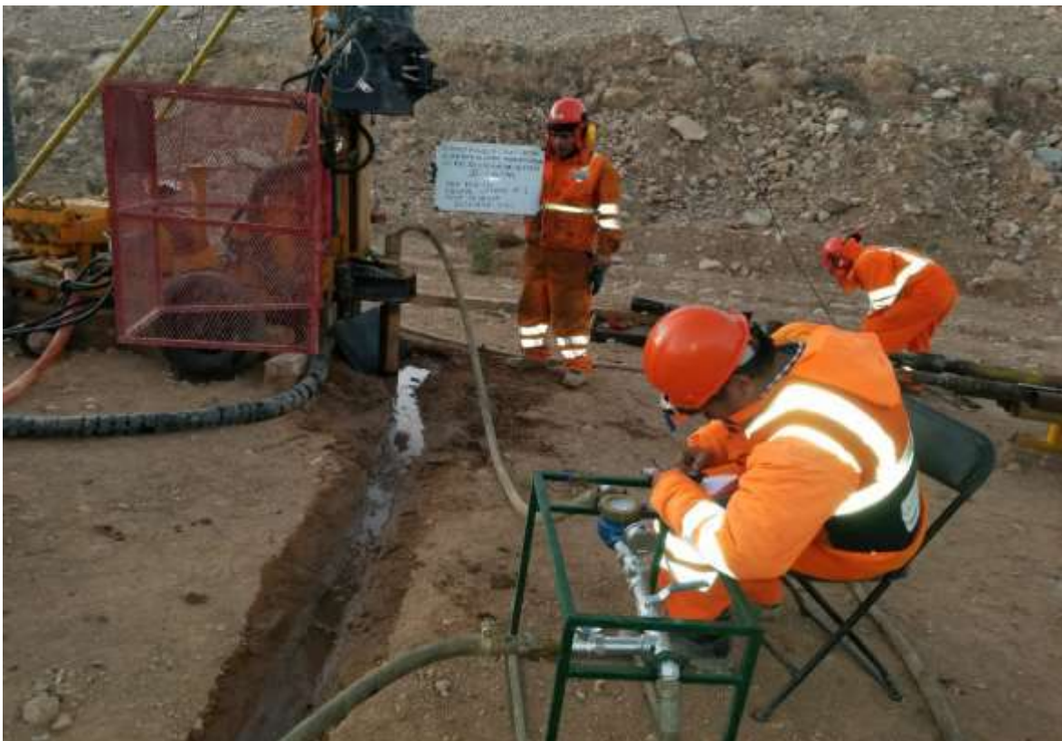
Descripción: Ejecución del ensayo Lefranc en las perforaciones diamantinas.
