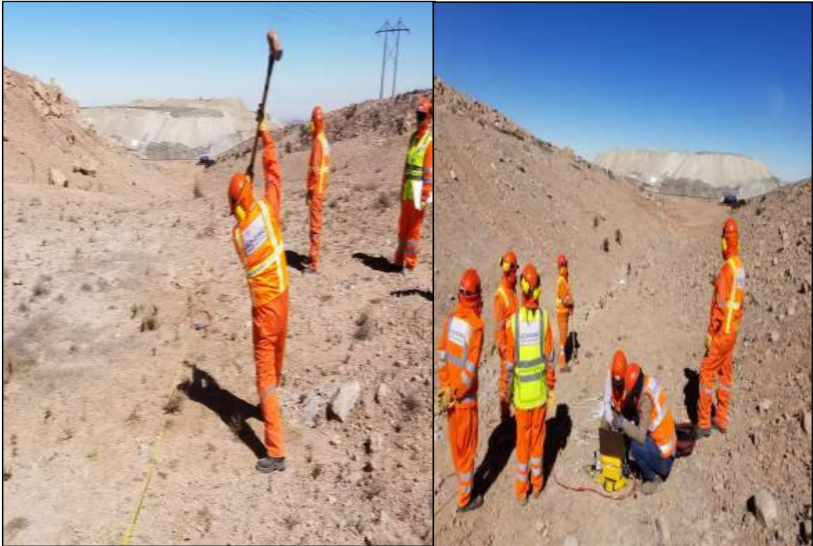
Descripción: Ejecución del ensayo de Refracción Sísmica y verificación de la data recolectada.
