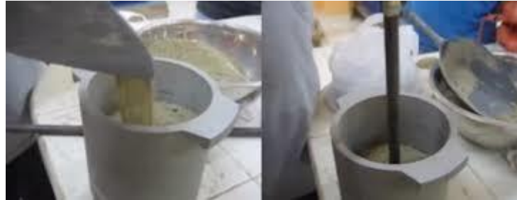
Figura 2: Peso unitario suelto y compactado con varilla del agregado fino
