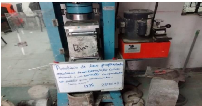
Figura 42: Ensayo resistencia a flexión.
