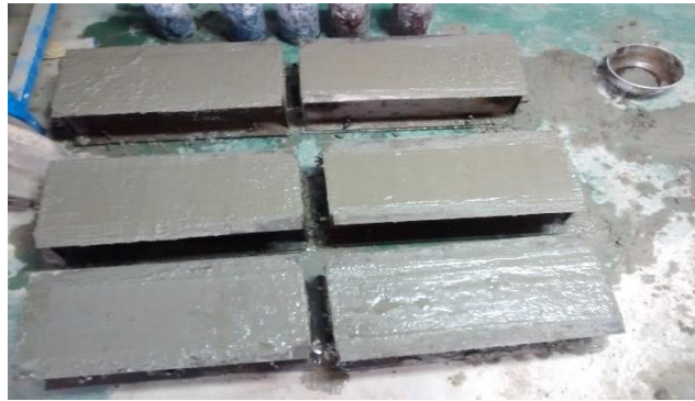
Figura 32: Llenado de las probetas prismáticas de concreto convencional.
