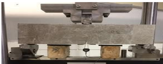
Figura 9: Ensayo a flexión aplicado a una probeta prismática
