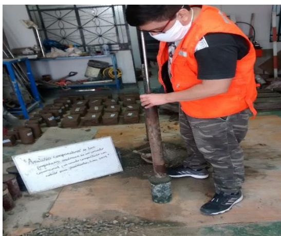
Figura 36: Compactación de la probeta cilíndrica del CCR
