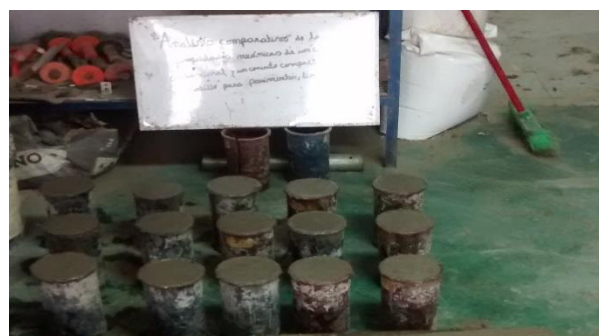
Figura 31: Llenado de las probetas cilíndricas de concreto convencional.
