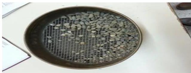
Figura 3: Ensayo granulométrico del agregado grueso
