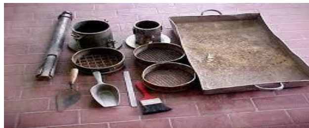
Figura 6: Ensayo de Proctor modificado
