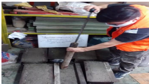
Figura 37: Compactación de las vigas del CCR
