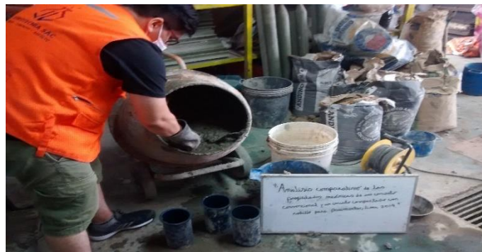
Figura 30: Elaboración de la mezcla del concreto convencional.
