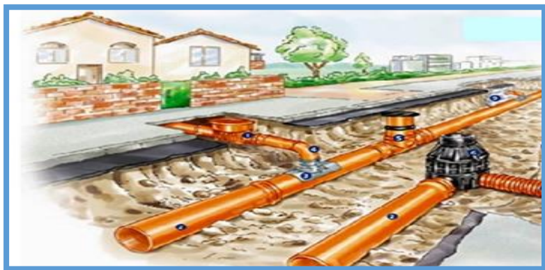
Figura 14. Red de alcantarillado
