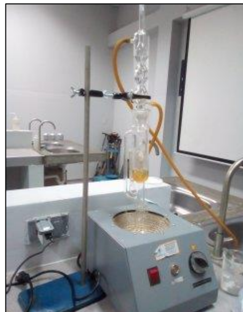
Figura D. Extracción de impurezas con equipo soxhlet para tara y linaza
