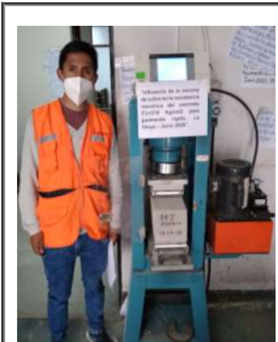
Se realiza el ensayo a flexión a la viga fabricada con 20% de escoria de cobre a la edad de 28 días.
