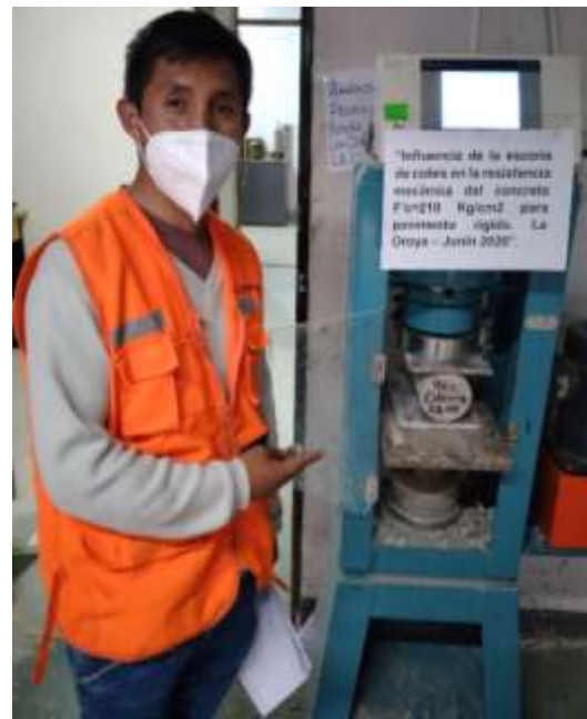
Se evalúa la resistencia a la tracción del concreto con incorporación de 40% de escoria de cobre.
