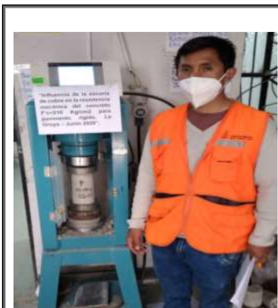
Figura 14. Ensayo a la compresión del concreto patrón.
