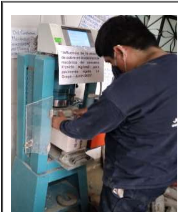
Se realiza la ubicación de la viga para ser sometida al ensayo a la flexión a la edad de 28 días.
