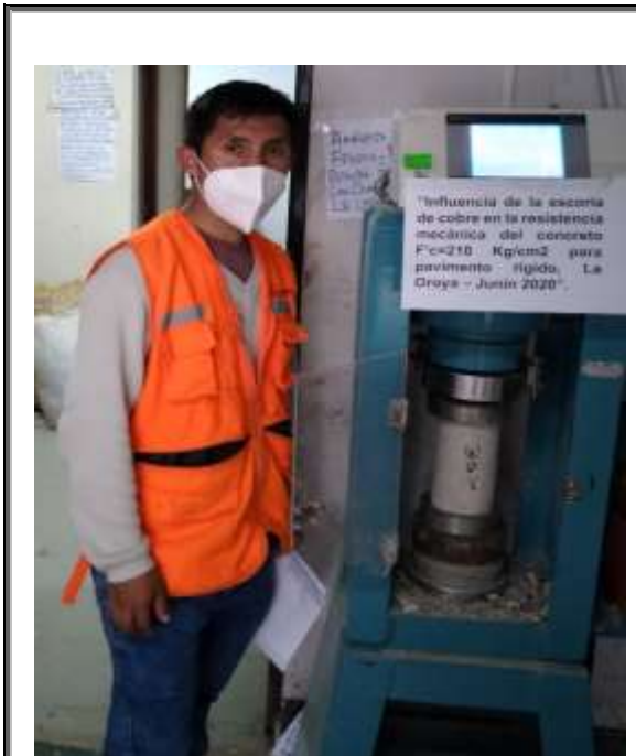
Se somete a la compresión la probeta con adición de 30% de escoria de cobre a la edad de 28 días.
