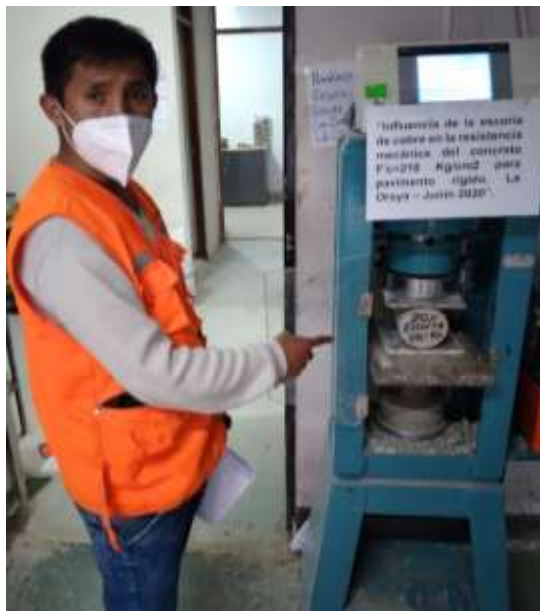
La probeta a la edad de 28 días con incorporación de 20% de escoria de cobres es sometida al ensayo a la tracción.
