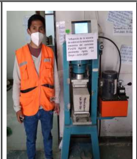
Se evalúa la resistencia a la flexión de la viga de concreto patrón a la edad de 28 días.
