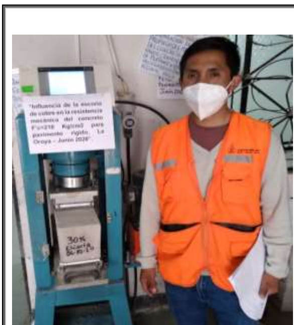
Figura 16. Ensayo a la flexión de la viga con adición del 30% de escoria de cobre.
