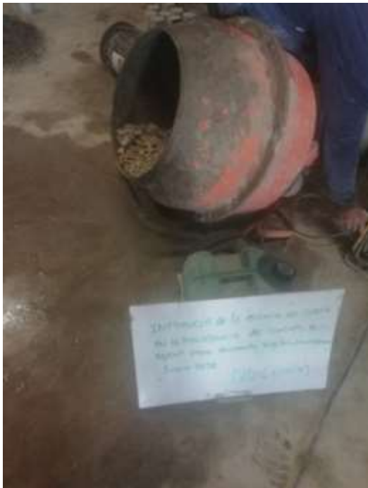
Se realiza la mezcla del concreto patrón.
