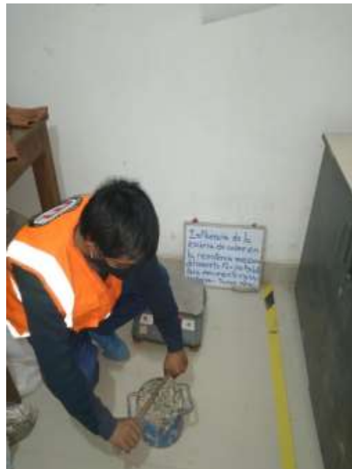
Ensayo del peso unitario compactado del agregado grueso.
