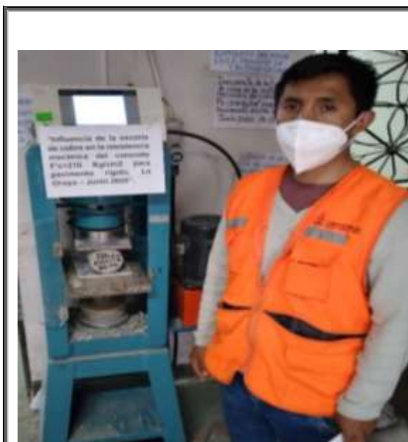
Figura 18. Ensayo de la resistencia a tracción del concreto patrón.
