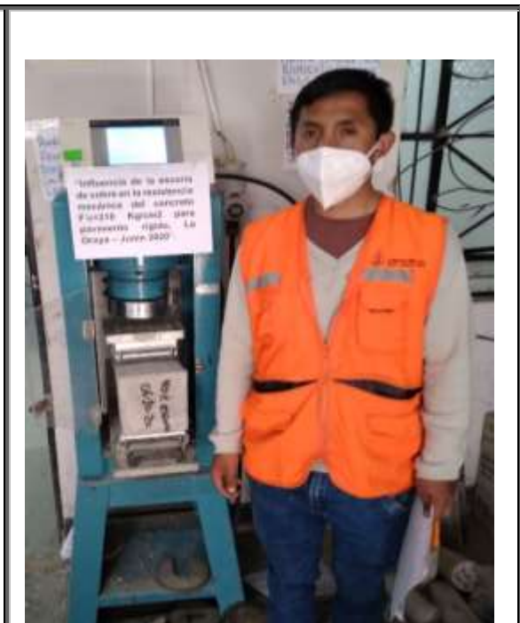
Se realiza el ensayo a flexión a la viga fabricada con 30% de escoria de cobre a la edad de 28 días.
