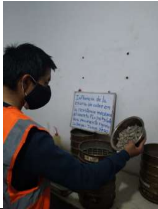
Ensayo de granulometría del agregado grueso.
