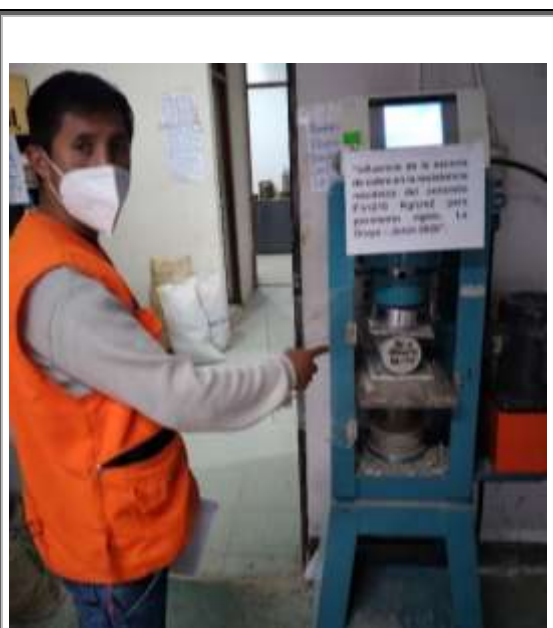
Figura 19. Ensayo de la resistencia a tracción del concreto con adición de 30% de escoria de cobre.
