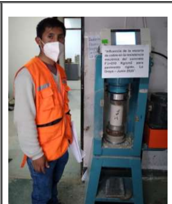
Se somete a la compresión la probeta con adición de 40% de escoria de cobre a la edad de 28 días.
