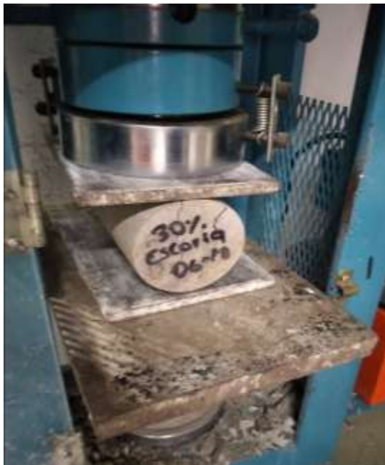
Rotura de la probeta con la incorporación de la escoria de cobre en reemplazo del agregado fino al 30%.
