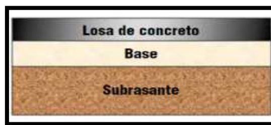
Figura 1. Estructura de un pavimento rígido
