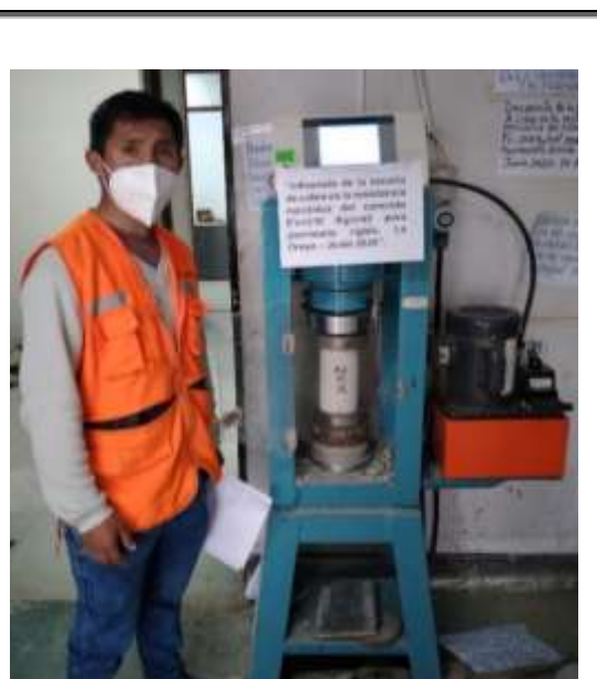
Figura 15. Ensayo a la compresión del concreto con 20% de escoria de cobre.
