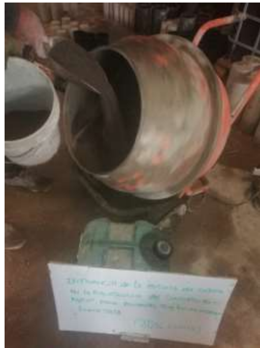
Se realiza la mezcla del concreto con porcentajes de escoria de cobre en reemplazo del agregado fino.
