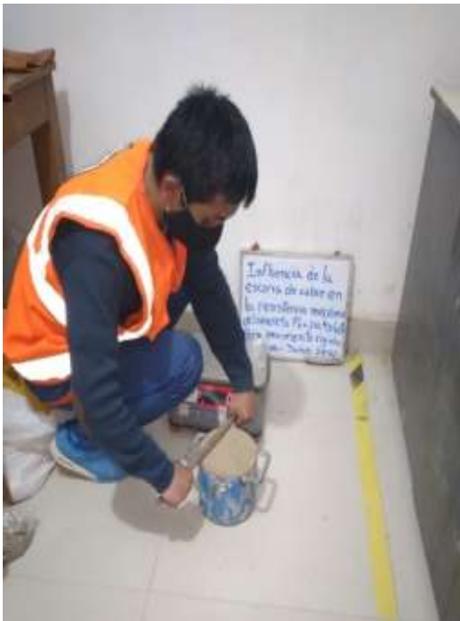
Ensayo del peso unitario compactado del agregado fino.
