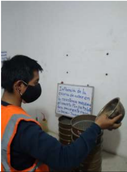
Ensayo de granulometría del agregado fino.
