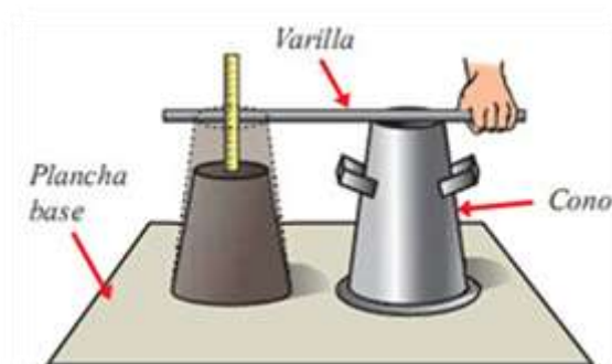
Figura 4 Medición de Slump con cono de Abraham.
