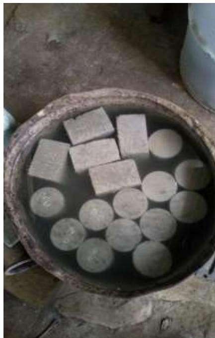
Figura 42. Curado de probetas y unidades de albañilería
