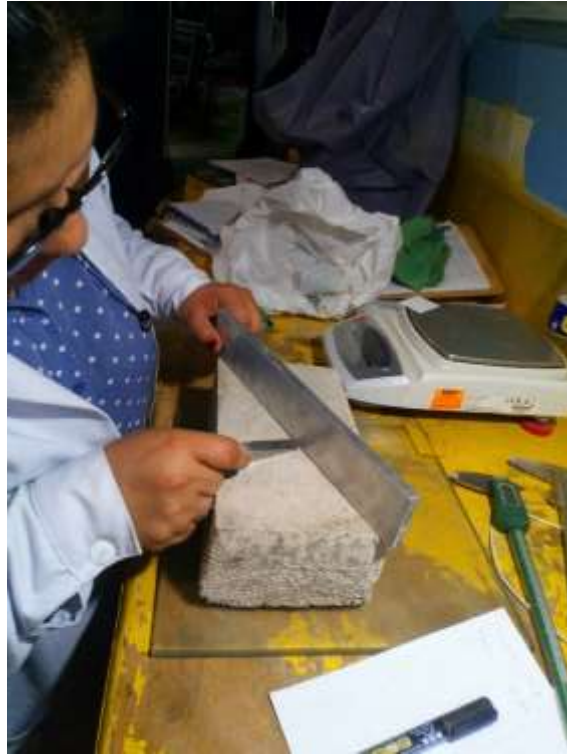
Figura 47. Comprobación del alabeo en las unidades de albañilería.
