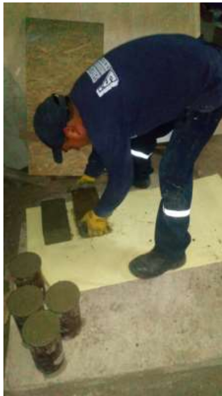
Figura 40. Desmoldado de las unidades de albañilería resistentes a la humedad
