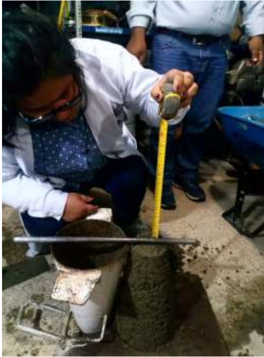
Figura 39. Verificación del asentamiento del concreto
