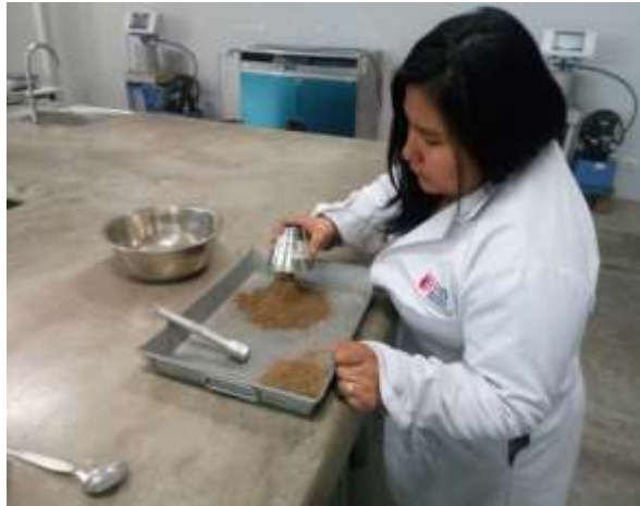
Figura 11. Levantamiento del cono tronconico.
