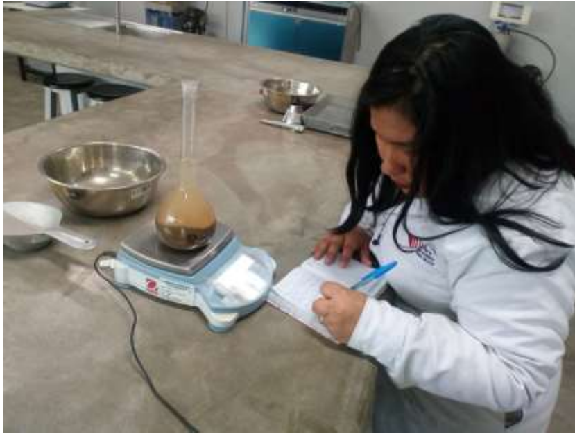
Figura 35. Tomando los datos del ensayo de absorción del agregado.
