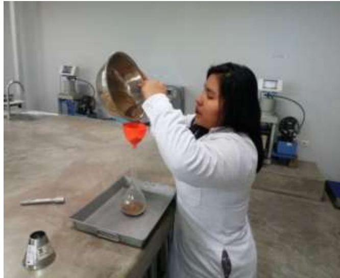
Figura 12. Ensayo de absorción del agregado fino
