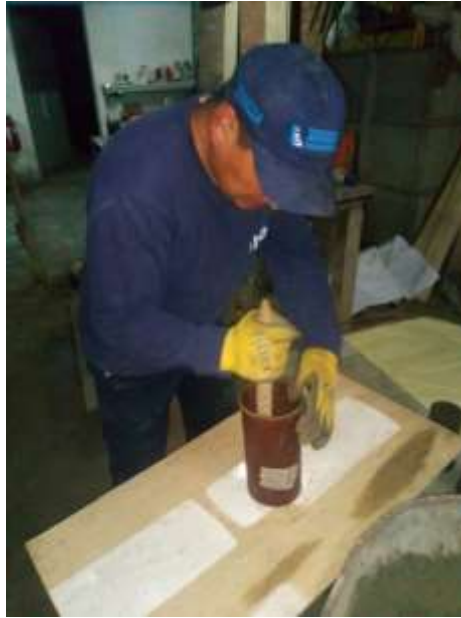
Figura 23. Compactación de mezcla en probeta
