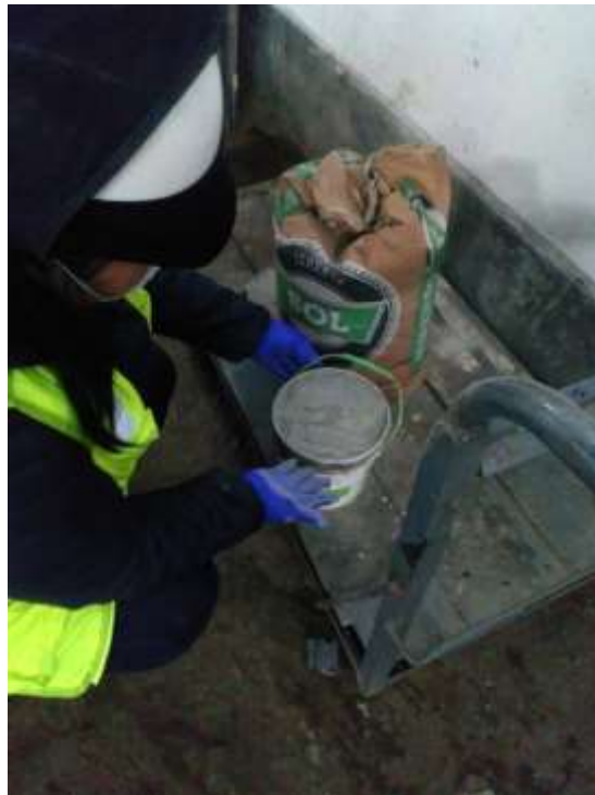
Figura 36. Dosificando el cemento.
