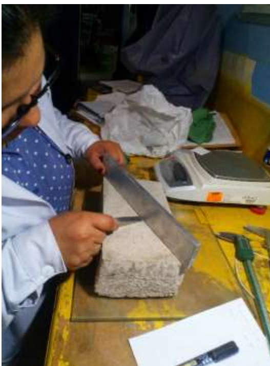
Figura 32. Comprobación del alabeo.
