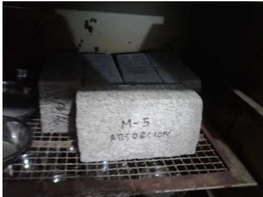
Figura 288. Unidades de albañilería puestas en horno
