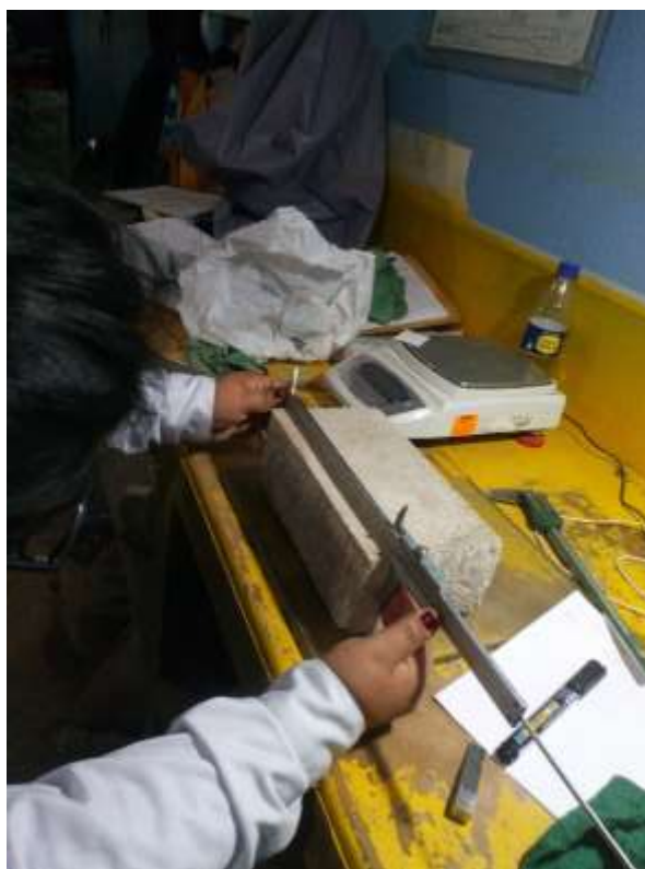
Figura 30. Dimensionamiento con uso vernier.
