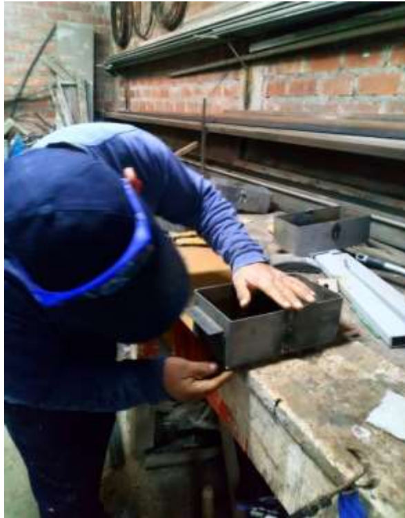
Figura 16. Revisión de juntas del molde.
