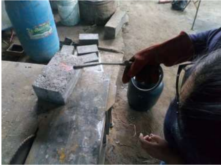
Figura 43. Sopleteado de con fuego- eliminación de fibras salientes
