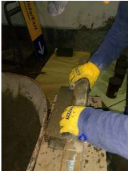
Figura 24. Rasado de mezcla en moldes
