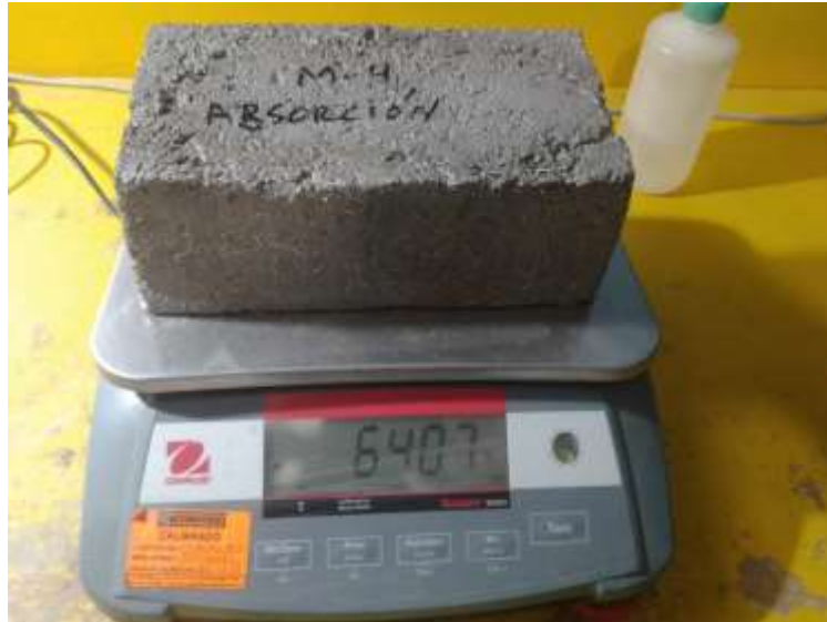
Figura 31. Pesado de unidades de albañilería
