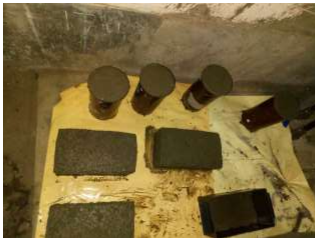
Figura 25. Las unidades desmoldadas y puestas al secado.
