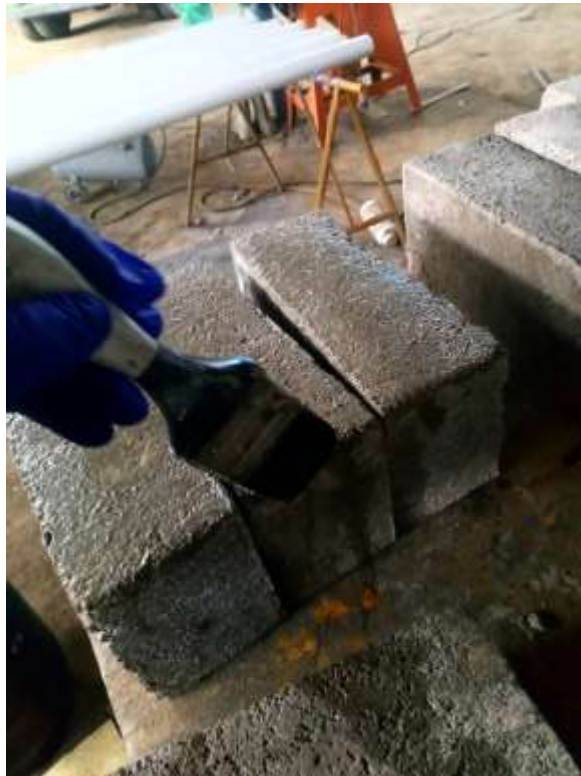
Figura 44. Aplicación de impermeabilizante natural en las unidades de albañilería
