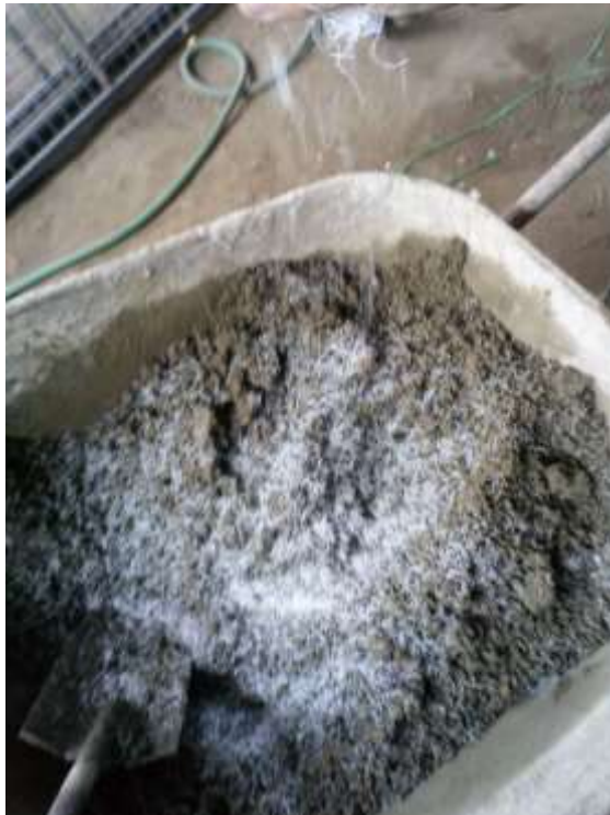
Figura 38. Aplicación de fibra a la mezcla patrón
