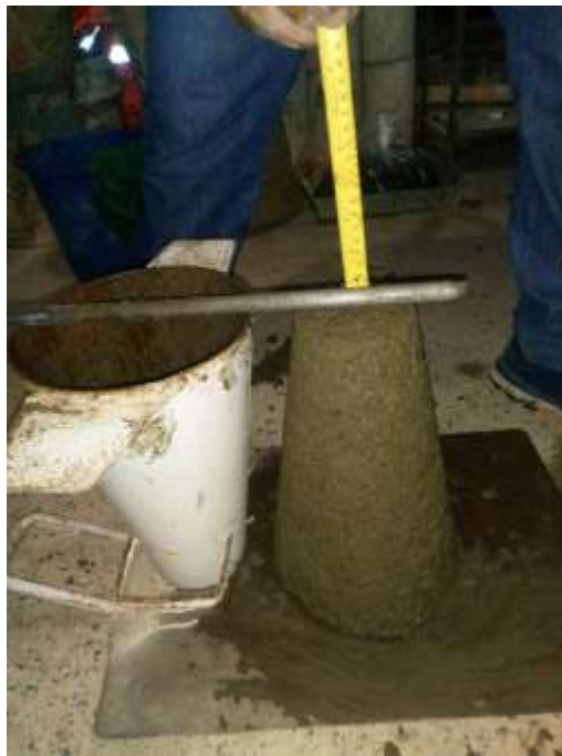
Figura 19. Medición del asentamiento en pulgadas.
