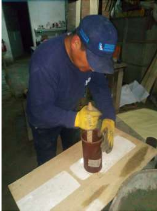
Figura 271. Compactación de mezcla en probetas
