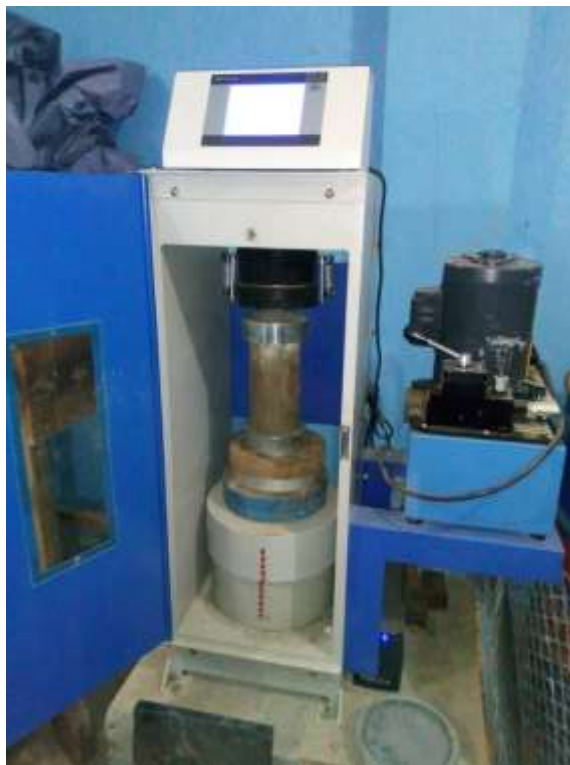
Figura 46. Equipo de rotura, aplicando carga a probeta
