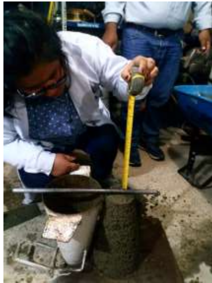
Figura 18. Ensayo del Slump.
