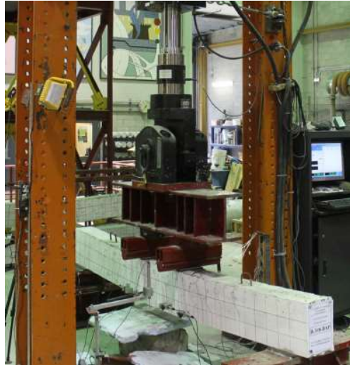
Figura 12. Ensayo a flexión en viga.
