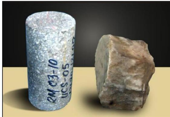
*Figura 3. Muestra de Roca Intacta.*
