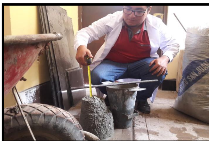
Figura 9: Ensayo de Slump
