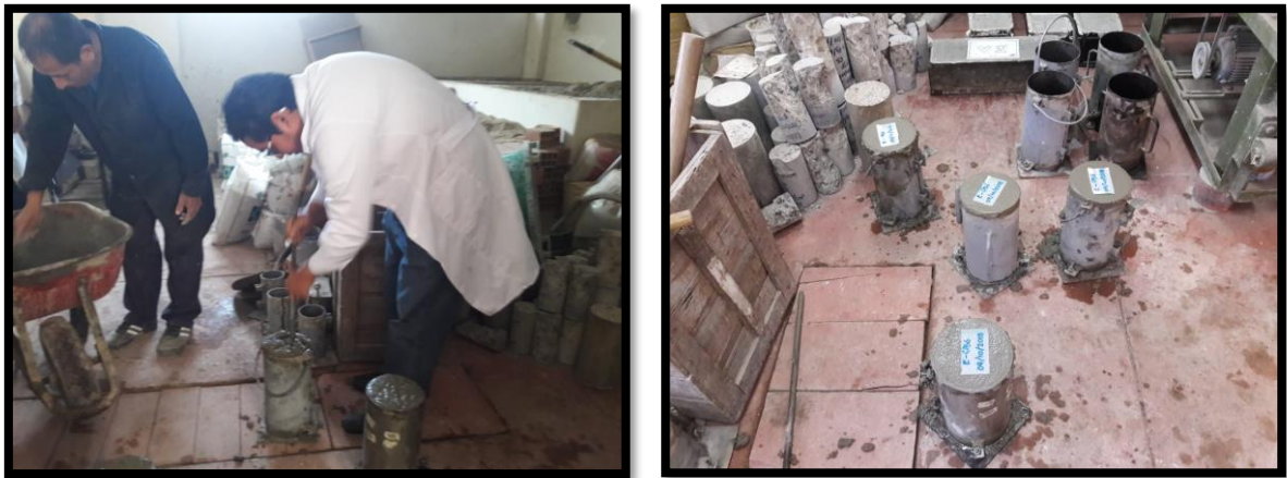
Figura 19: Vaceado de concreto a los moldes cilíndricas
