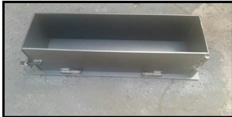
Figura 15: Moldes de Viga
