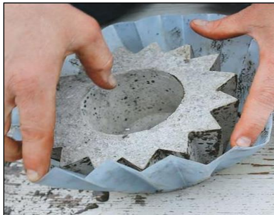
Imagen N° 20 Retiro de molde Fuente: propia
