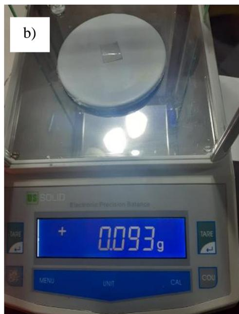
**Figura 41.** Pesaje de las muestras del Tereftalato de Polietileno después de tiempo de contacto con el *Fusarium culmorum*
