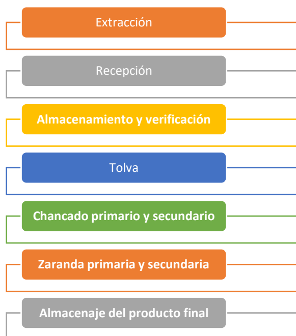
Figura 01: Procesos para la Producción de Piedra Chancada Fuente: Empresa chancadora Chachapoyas Elaboración propia
