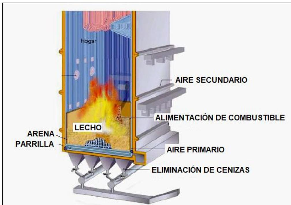
Figura 01: Caldera en lecho fluidizado con carbón
