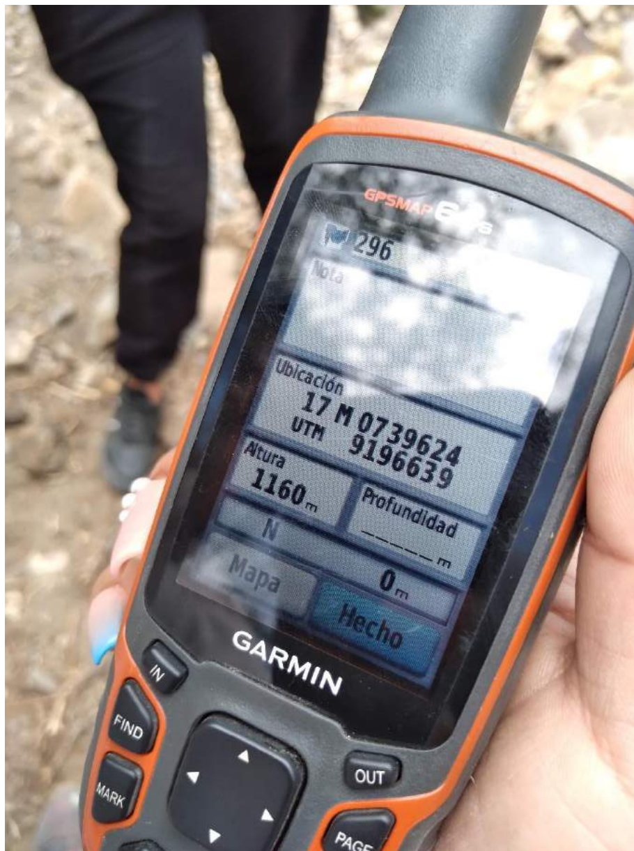
Imagen 05: GPS utilizado en el levantamiento topográfico
