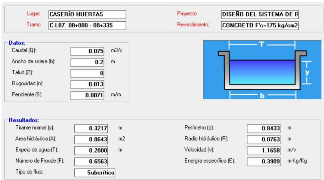
Figura 27. Diseño geométrico - Canal lateral 07 / 00+000 - 00+335 km
