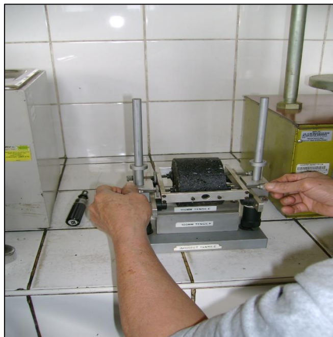
Figura 50. Acondicionamiento del espécimen en la Máquina de Carga a Tensión
