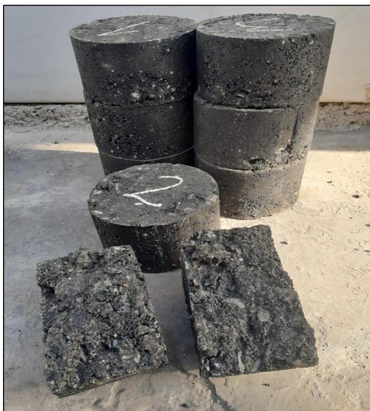
Figura 54. Fractura de la briqueta después del ensayo
