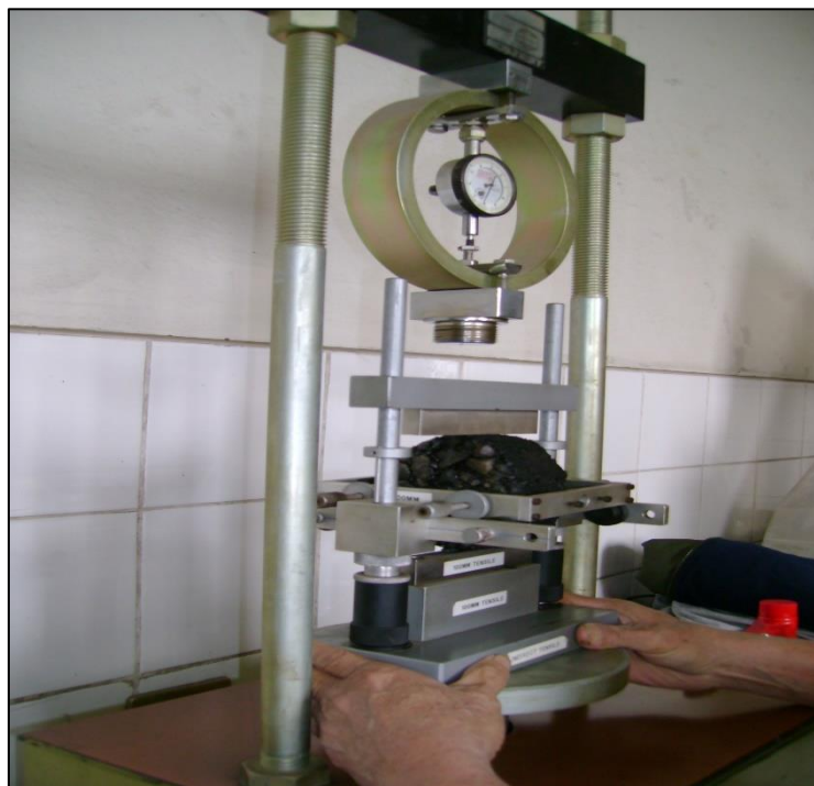
Figura 53. Espécimen sometido a prueba de Tensión
