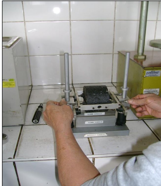
Acondicionamiento del espécimen en la Máquina de Carga a Tensión
