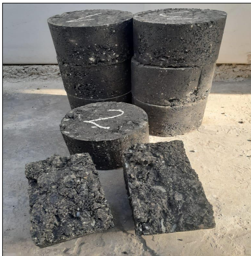
Fractura de la briqueta después del ensayo
