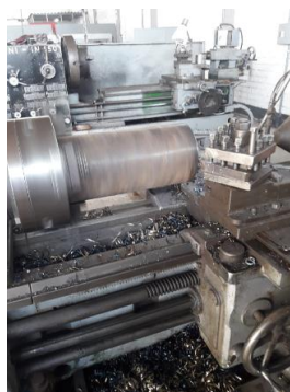
Figura 12. Foto del proceso de embocinado de escudos
