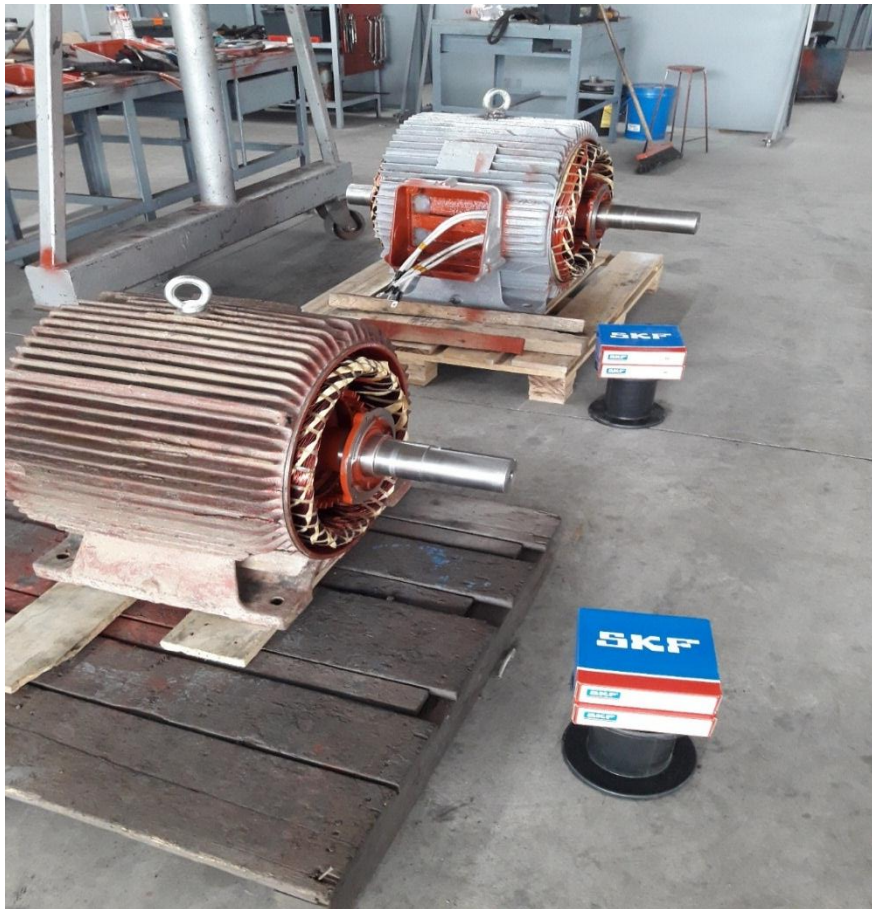
Figura 16. Fotos del proceso de montaje de motores
