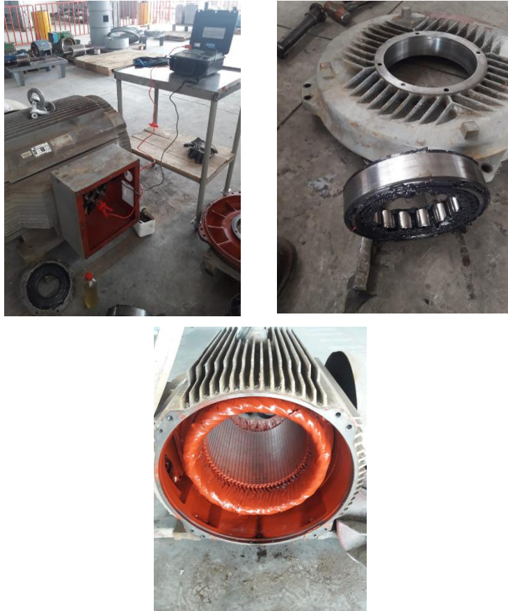
Figura 4. Fotos del proceso de desmontaje de motores.
