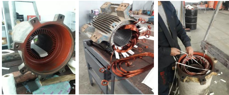
Figura 6. Fotos del proceso de rebobinado del estator.
