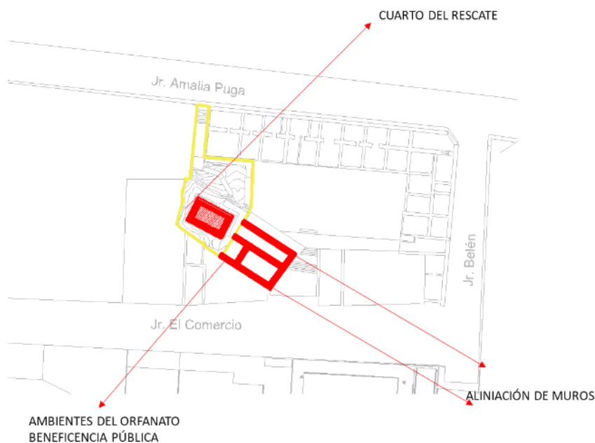
Figura 77: Jr. El Comercio, construcción de adobe del hogar de niñas de la Beneficencia que se asienta sobre muros incas
