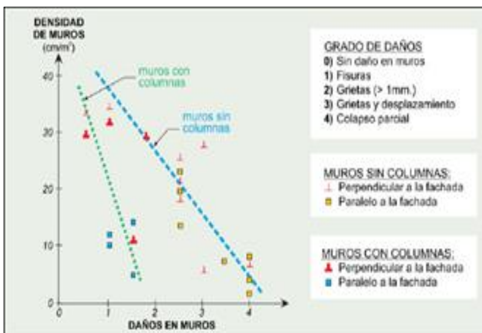
Figura 1. Relación de daños y densidad de muros, con columnas de concreto armado y sin ellas (Kuroiwa Horiuchi, Pando Pacheco, & Pando Merino, 2010)
