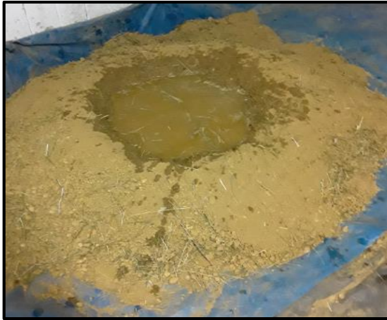
Figura N° 3-32 y 3-33 Mezcla del Material con la paja y agua y con 3% de Adición de emulsión Asfáltica RC-250
