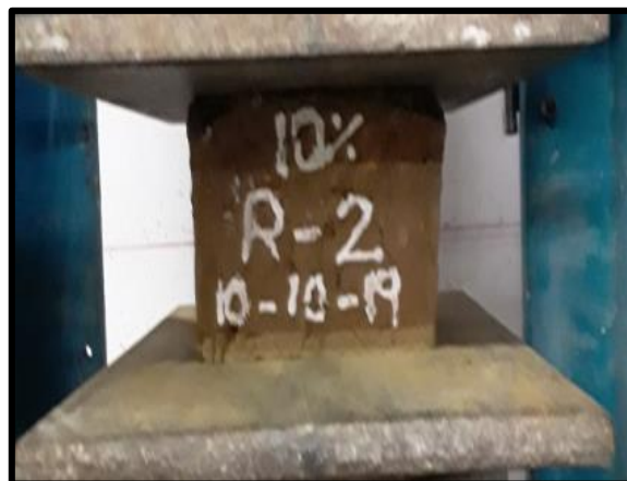
Foto N° 24, 25,26 Muestra de Adobe con 10% de Adición de Emulsión Asfáltica RC-250
