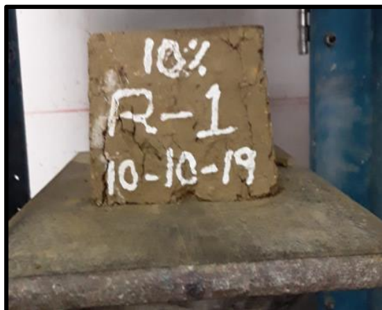
Foto N° 24, 25,26 Muestra de Adobe con 10% de Adición de Emulsión Asfáltica RC-250
