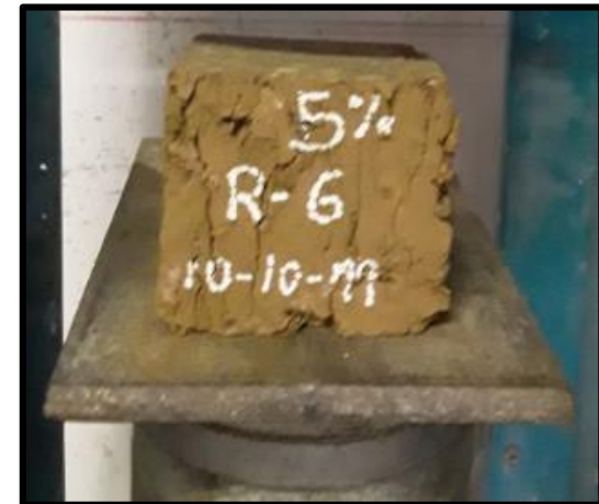
Foto N° 21, 22,23 Muestra de Adobe con 5% de Adición de Emulsión Asfáltica RC-250
