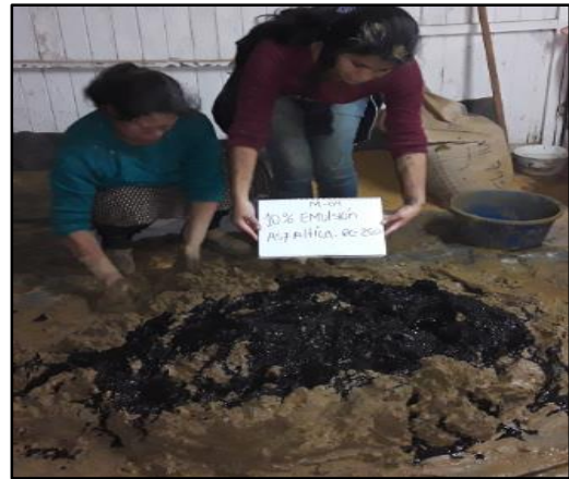
Figura N° 3-34 y 3-35 Mezcla del Material con la paja y agua y con 5% y 10% de Adición de emulsión Asfáltica RC-250
