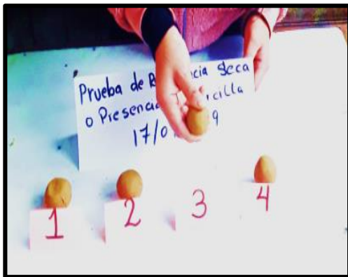
Figura 3-13 y 3-14 Realizando la prueba de la bolita 3 y 4 para ver si es apto el material
