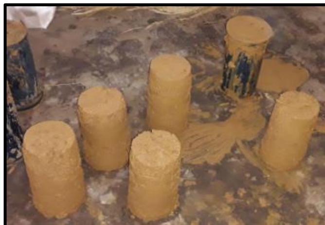
Figura N° 3-31 Elaboración de las muestras cilíndricas Para el ensayo a tracción diametral
