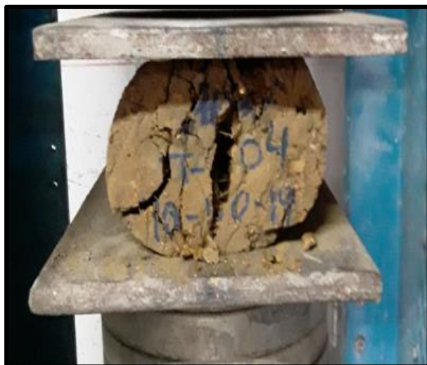
Foto N° 53, 53, 55, 56,57, Muestras de Adobe Estabilizado con 10% de Emulsión asfáltica RC-250 Sometidas a Tracción Diametral
