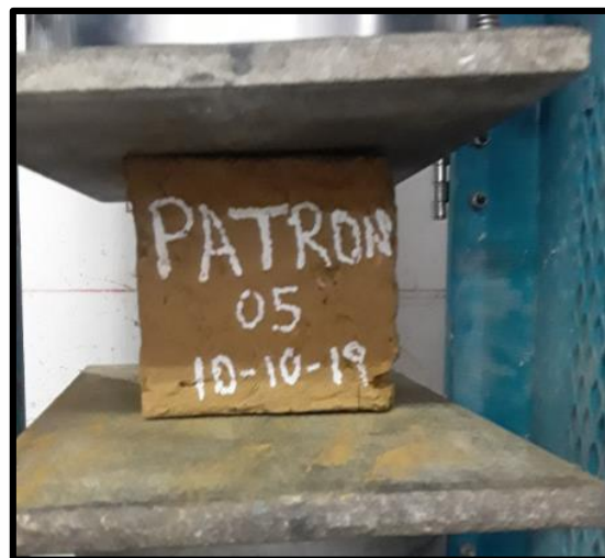
Foto N° 09, 10, 11 Muestra del adobe patrón sometidas a compresión
