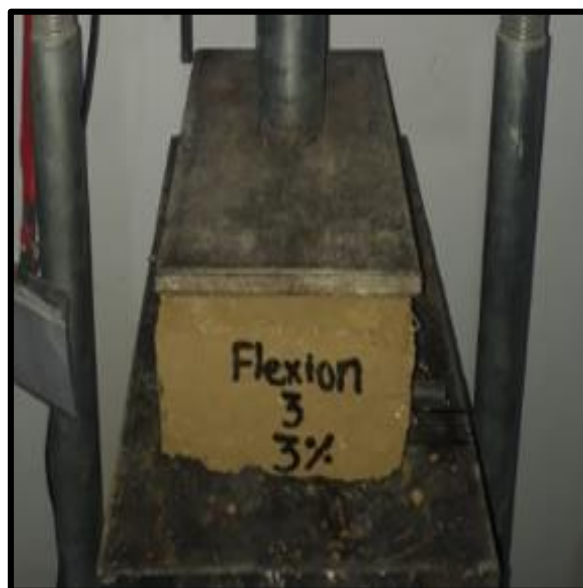
Foto N° 34,35 Muestras a Flexión del adobe Patrón y Estabilizado con 3% de Emulsión Asfáltica RC-250
