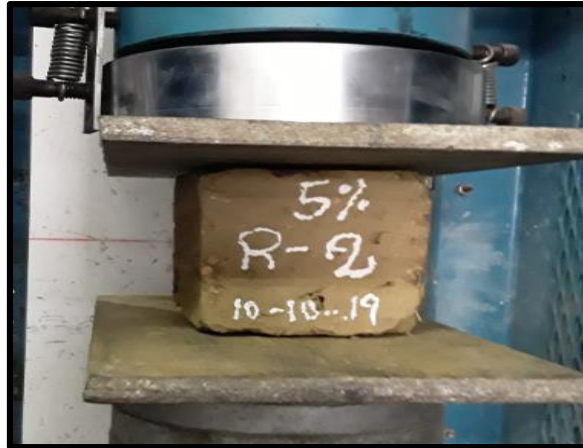
Foto N° 18, 19,20 Muestra de Adobe con 5% de Adición de Emulsión Asfáltica RC-250
