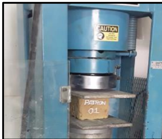
Foto N° 06, 07, 08 Muestra del adobe patrón sometidas a compresión
