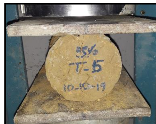
Foto N° 48, 49, 50, 51,52, Muestras de Adobe Estabilizado con 5% de Emulsión asfáltica RC-250 Sometidas a Tracción Diametral
