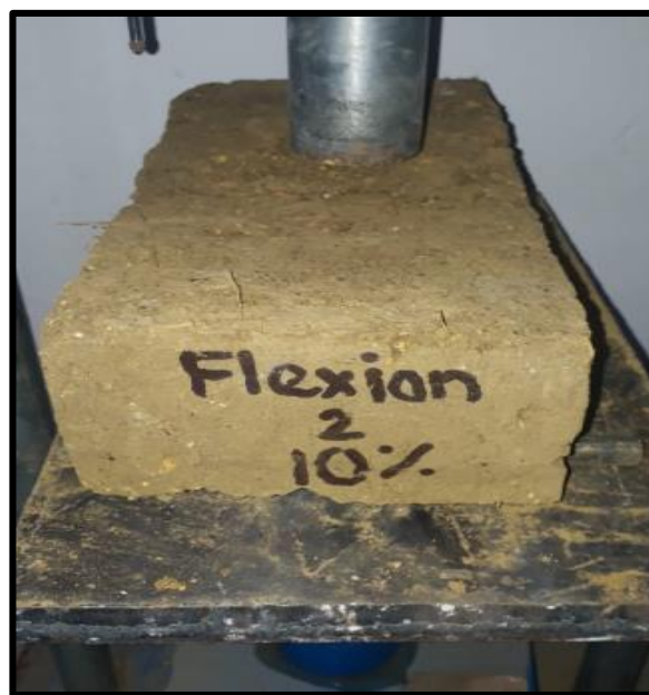
Foto N° 36,37 Muestra a Flexión del adobe Patrón y Estabilizado con 5% y 10% de Emulsión Asfáltica RC-250
