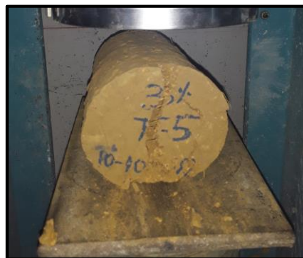
Foto N°. 43. 44. 45. 46.47. Muestras de Adobe Estabilizado con 3% de Emulsión asfáltica RC-250 Sometidas
