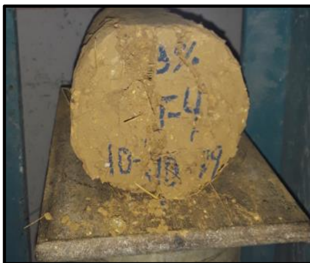
Foto N°. 43. 44. 45. 46.47. Muestras de Adobe Estabilizado con 3% de Emulsión asfáltica RC-250 Sometidas
