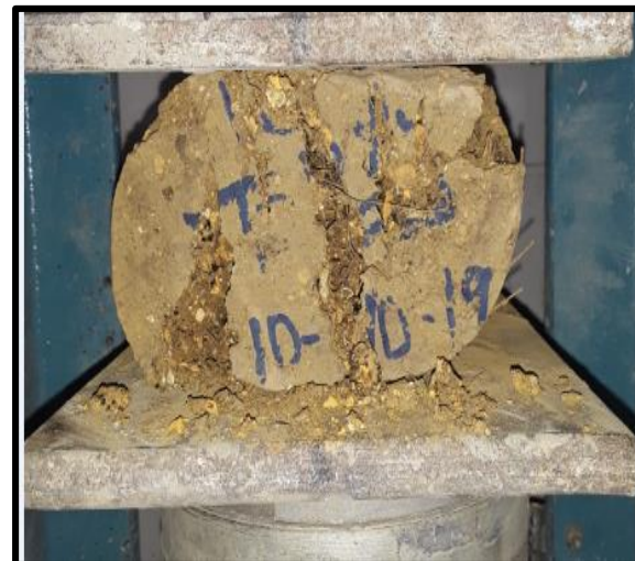
Foto N° 53, 53, 55, 56,57, Muestras de Adobe Estabilizado con 10% de Emulsión asfáltica RC-250 Sometidas a Tracción Diametral
