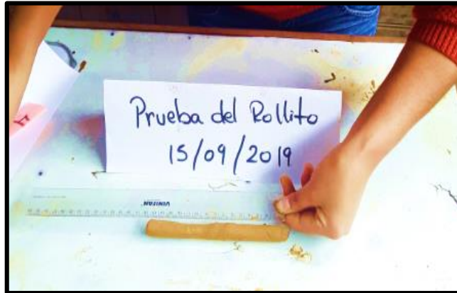
Figura N° 3 -06 Elaboración del rollito de 15 cm aproximadamente
