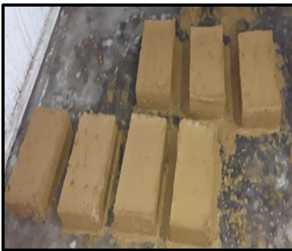
Figura N° 3-29 y 3-30 Elaboración de la muestra de adobe para el ensayo a compresión, flexión y absorción
