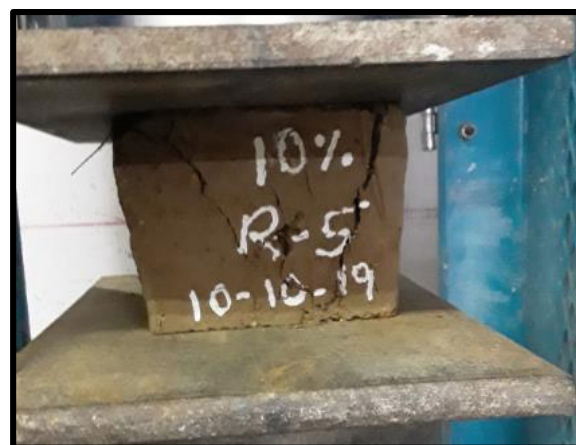
Foto N° 27, 28,29 Muestra de Adobe con 10% de Adición de Emulsión Asfáltica RC-250
