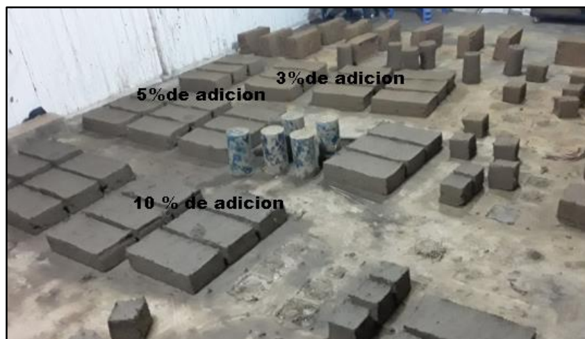
Figura N° 3-36 Muestras Elaboradas del adobe estabilizado con 3%, 5% y 10 % Fuente: Elaboración Propia.
