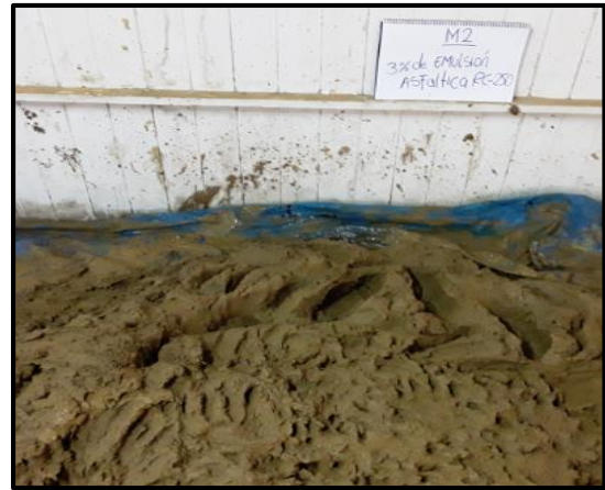
Figura N° 3-32 y 3-33 Mezcla del Material con la paja y agua y con 3% de Adición de emulsión Asfáltica RC-250
