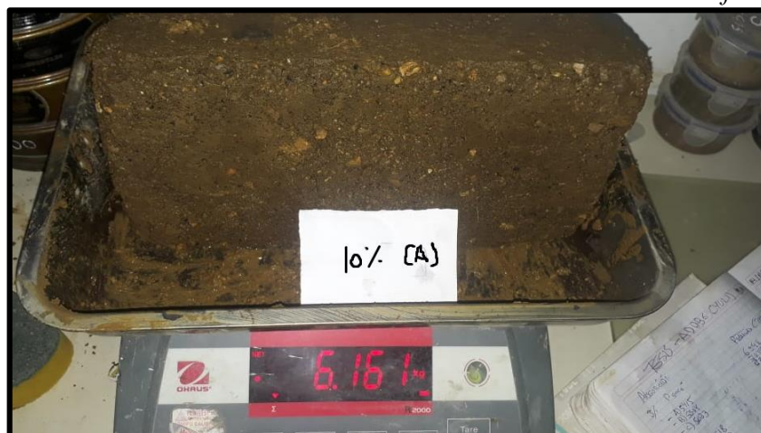
Foto N° 64 Absorción al 10 % de Adición de Emulsión Asfáltica
