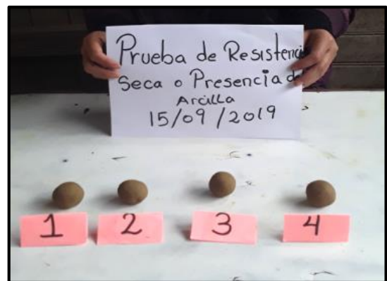
Figura N°3-09 y 3 -10 se muestra la Elaboración de las 4 bolitas de arcilla
