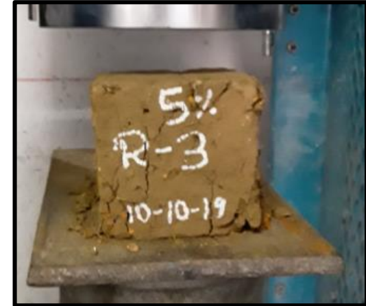
Foto N° 18, 19,20 Muestra de Adobe con 5% de Adición de Emulsión Asfáltica RC-250
