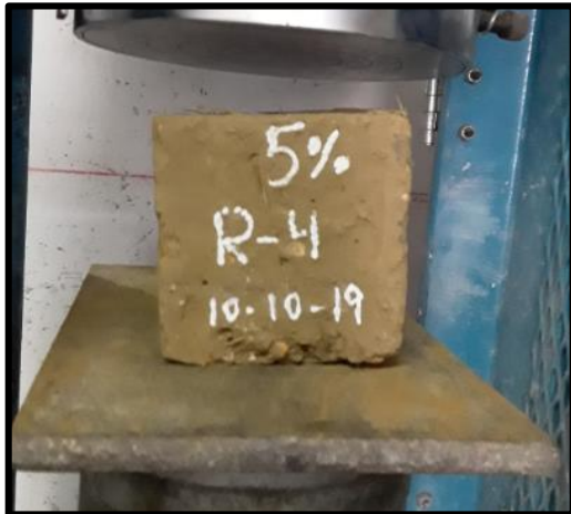
Foto N° 21, 22,23 Muestra de Adobe con 5% de Adición de Emulsión Asfáltica RC-250
