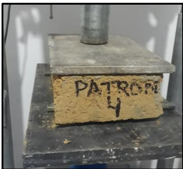
Foto N° 34,35 Muestras a Flexión del adobe Patrón y Estabilizado con 3% de Emulsión Asfáltica RC-250
