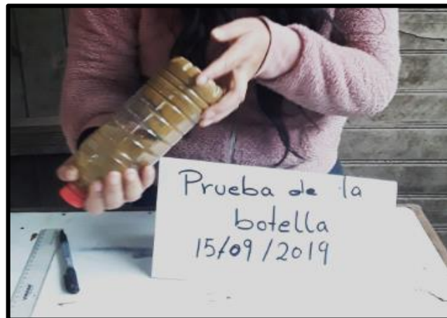
Figura N°3-15 Llenar el material en una botella a la mitad con agua y moverla hasta que se mezcle bien
