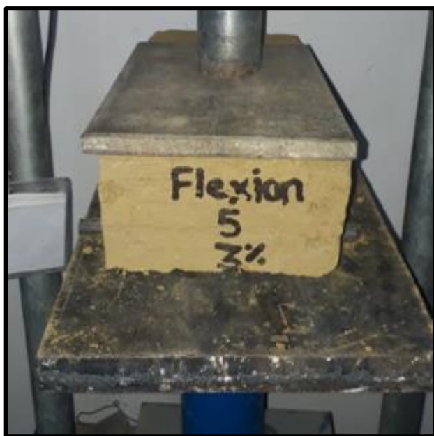
Foto N° 36,37 Muestra a Flexión del adobe Patrón y Estabilizado con 5% y 10% de Emulsión Asfáltica RC-250
