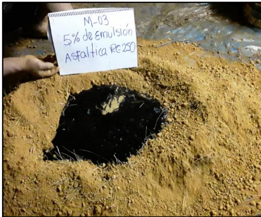
Figura N° 3-34 y 3-35 Mezcla del Material con la paja y agua y con 5% y 10% de Adición de emulsión Asfáltica RC-250
