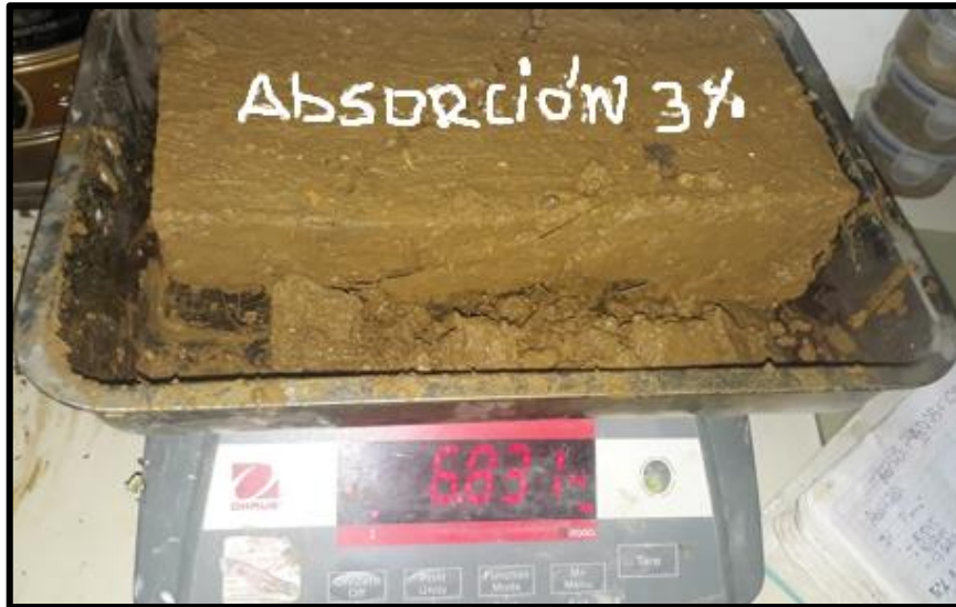
Foto N° 62 Absorción al 3 % de Adición de Emulsión Asfáltica
