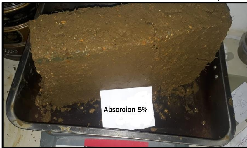
Foto N° 63 Absorción al 5 % de Adición de Emulsión Asfáltica
