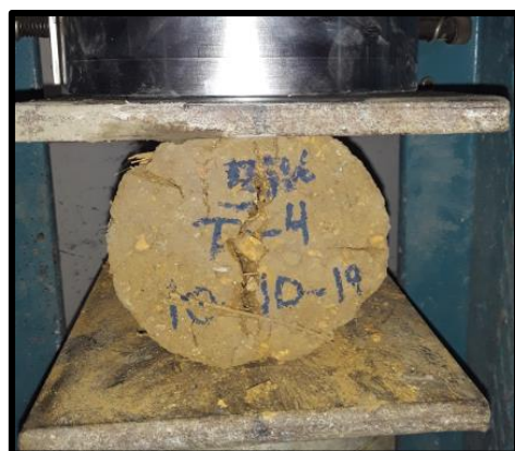
Foto N° 48, 49, 50, 51,52, Muestras de Adobe Estabilizado con 5% de Emulsión asfáltica RC-250 Sometidas a Tracción Diametral
