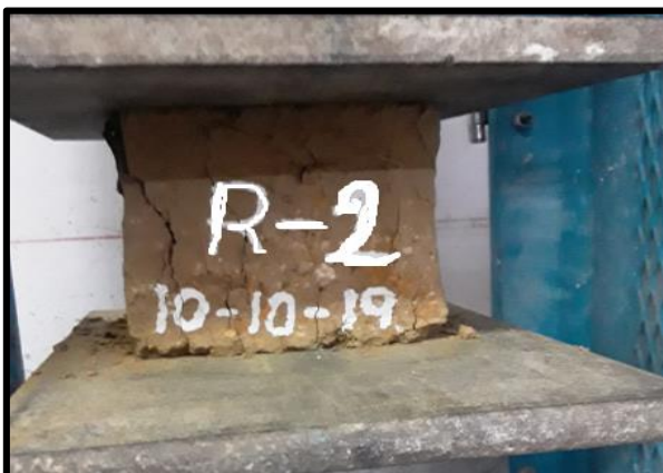
Foto N° 12, 13,14 Muestra del adobe patrón sometidas a compresión
