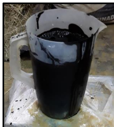
Figura N° 3-21 v 3-22 obtención de la emulsiona asfáltica RC-250
