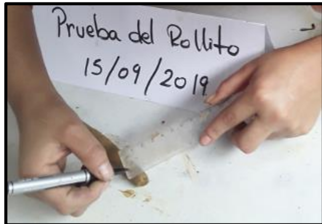
Figura N° 3-07 Memos el diámetro del rollito elaborado
