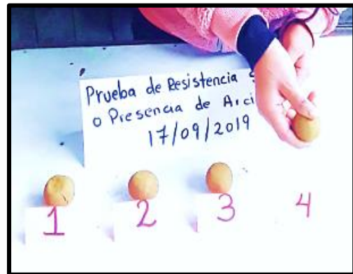
Figura 3-13 y 3-14 Realizando la prueba de la bolita 3 y 4 para ver si es apto el material
