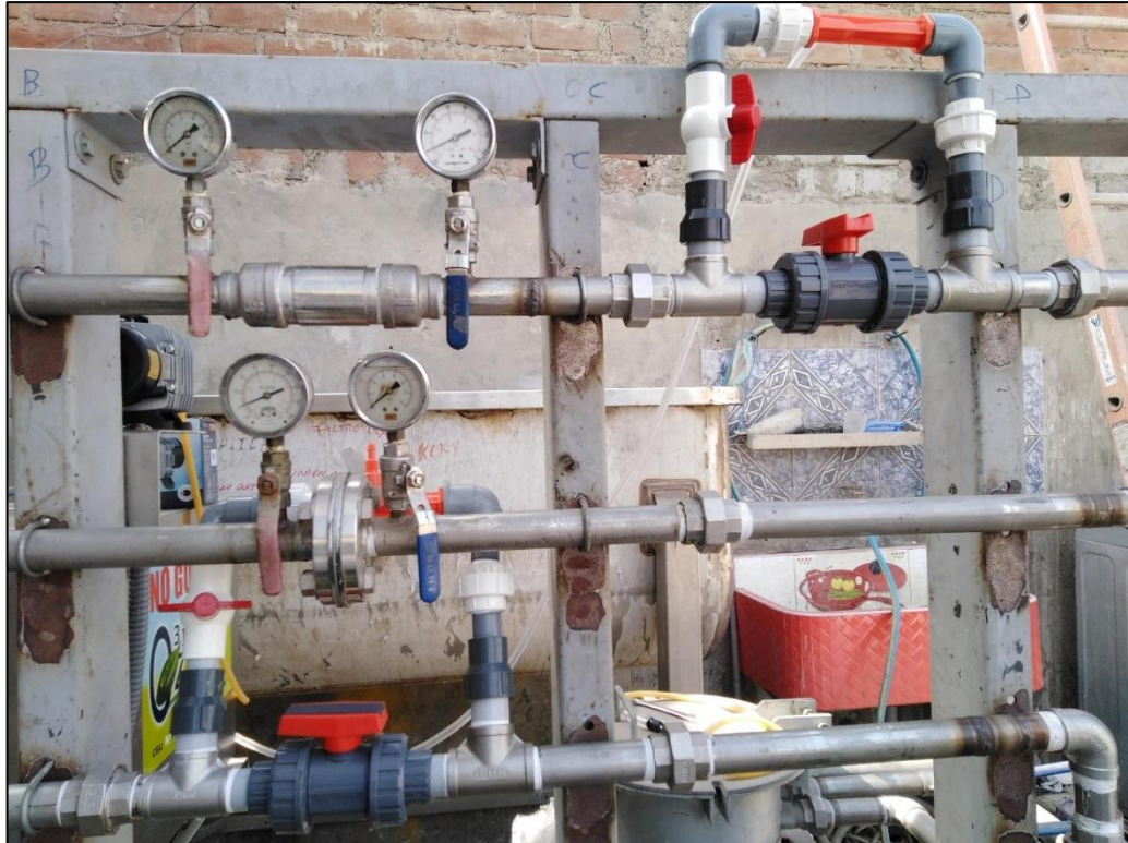
Figura 9. Proceso en combinación de cavitación hidrodinámica y ozonización
