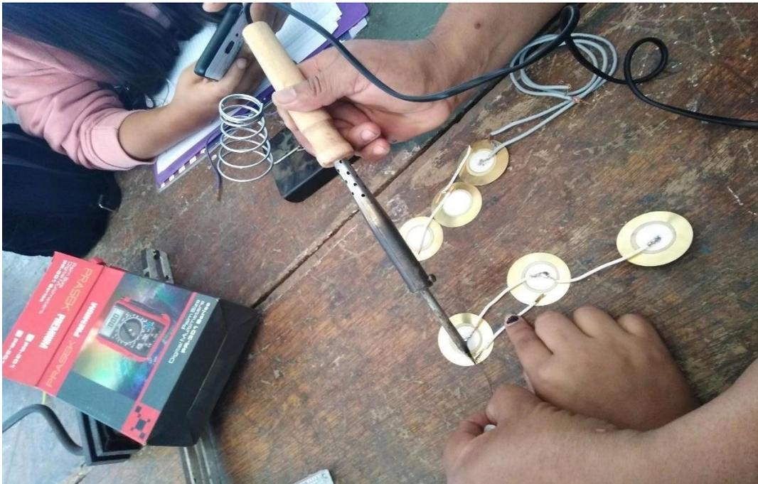
Primera prueba circuito con 6 piezoeléctricos
