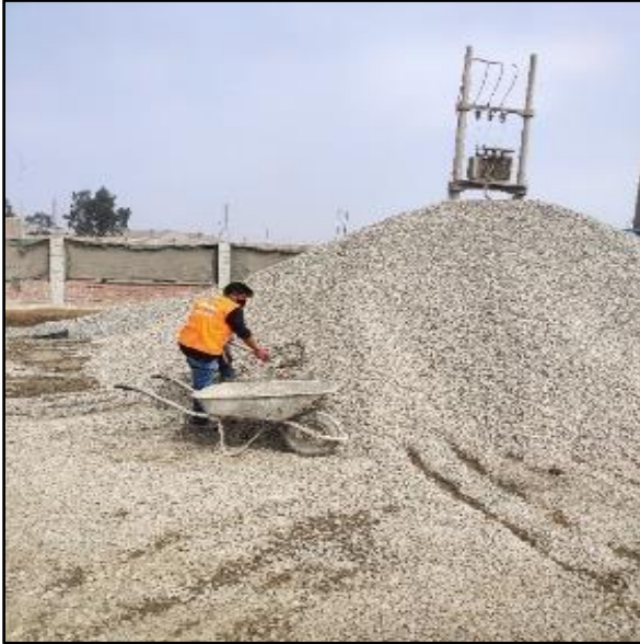
Foto 1. selección de muestra de agregado grueso
