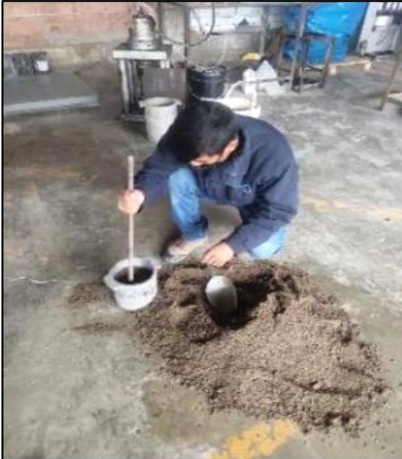
Foto 24. Ensayo de peso unitario
