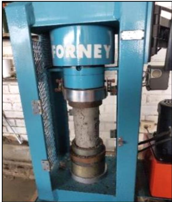
Foto 72. falla a compresión de testigo con 7% de PET
