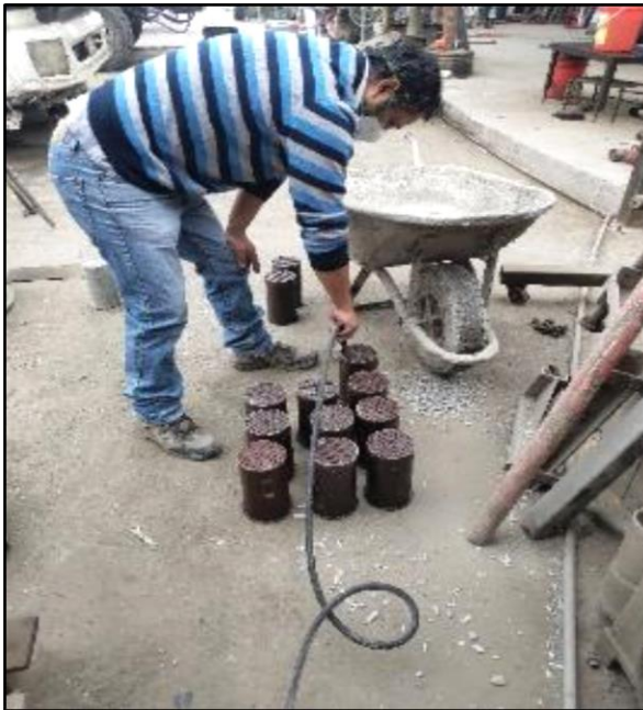
Foto 41 y 42. desmoldeo de probetas y vigas
