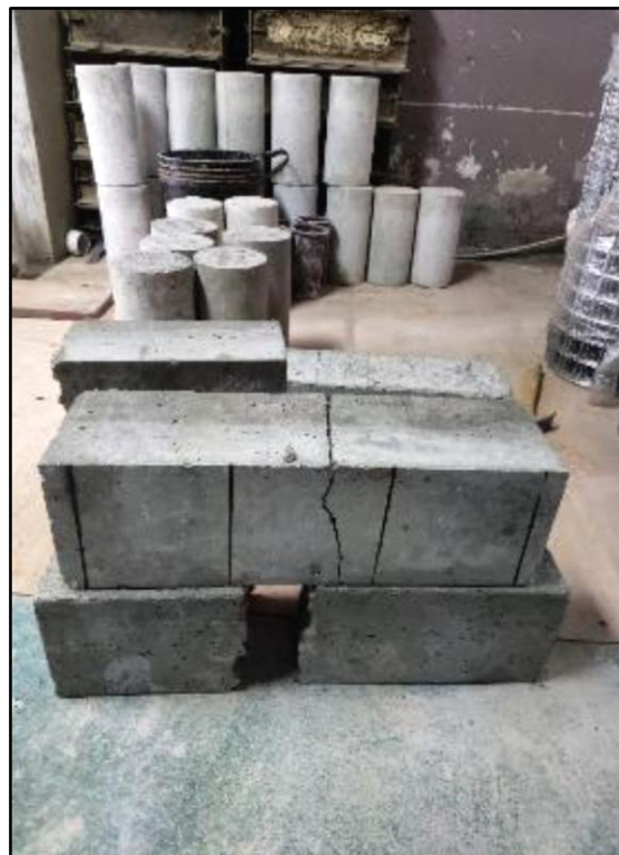
Figure 77. falla de viga de muestra patrón
