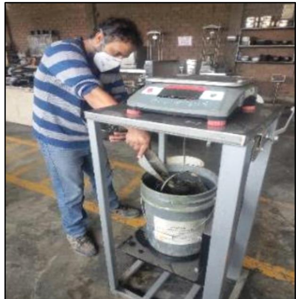
Foto 15. peso sumergido del agregado grueso
