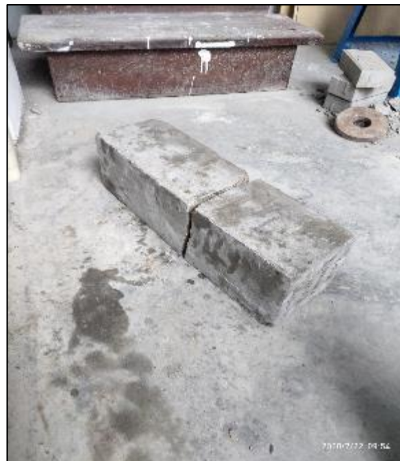
Foto 85. Falla de viga con 5% de PET
