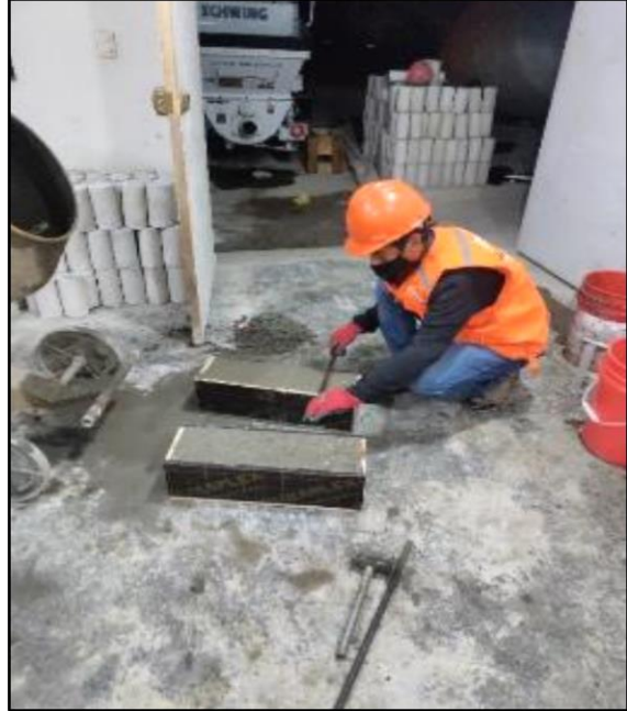
Figure 35 y 36 colocación de muestra de concreto en vigas
