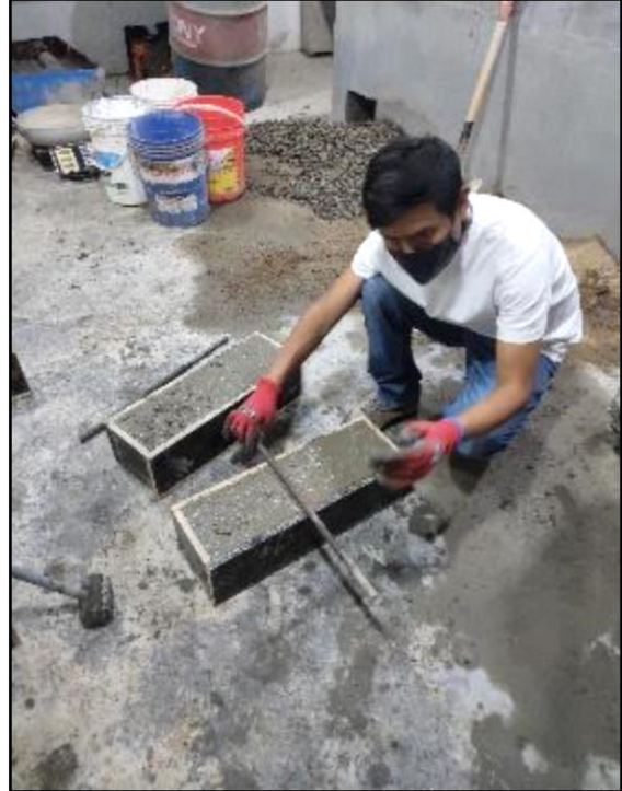
Foto 47 y 48. Colocación de muestra de concreto en vigas y probetas
