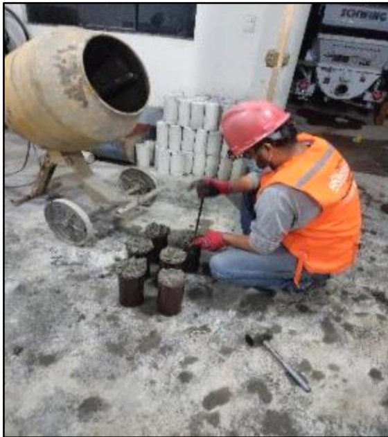
Foto 37 y 38. Colocación de muestra de concreto para elaboración de las probetas
