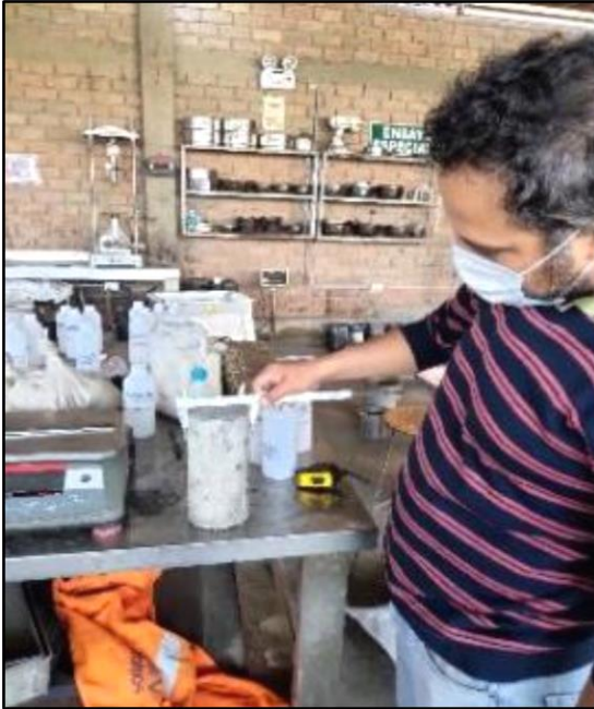
Foto 63 y 64. medida y Pesaje de los testigos de concreto
