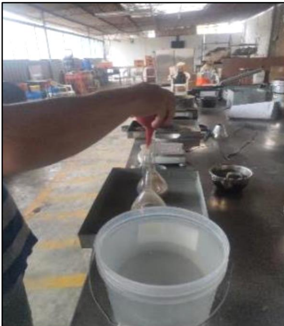
Foto 22. se agrega agua al picnómetro
