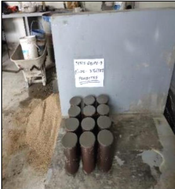
Foto 49 y 50. Acabado final de los testigos de concreto
