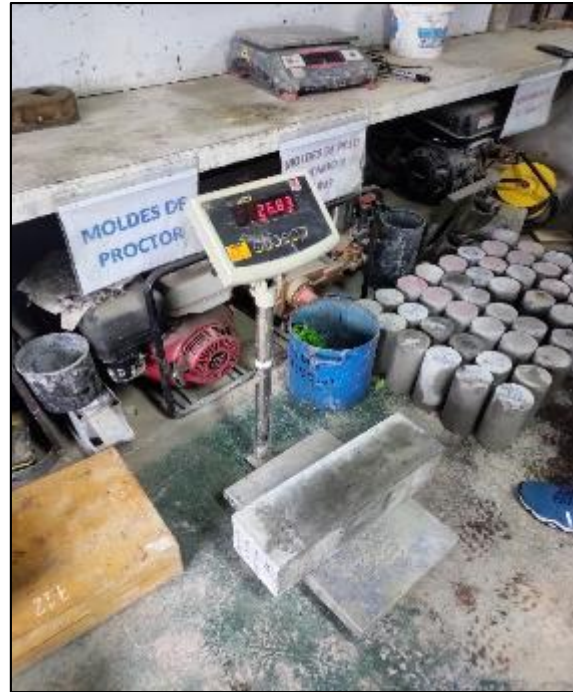
Figure 75 peso de la viga patrón
