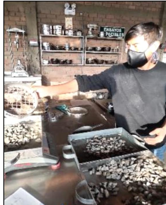
Foto 8. tamaño máximo del agregado
