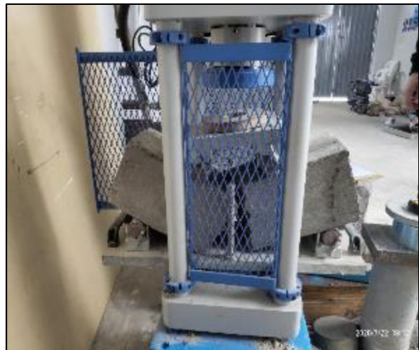
Foto 81. falla de viga con 3% de PET
