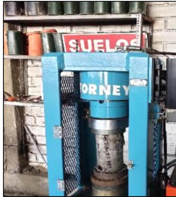
Foto 68. falla de testigo con 3% de PET
