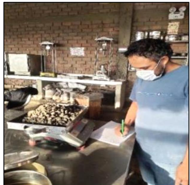
Foto11. se pesa después de sacar del horno
