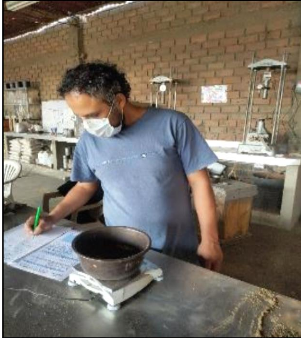
Foto 16. peso de muestra húmeda
