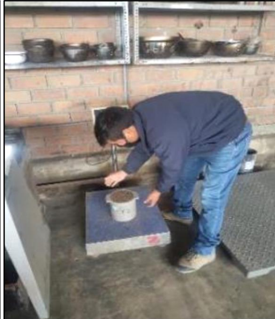
Foto 25. Pesaje del molde de ensayo de peso unitario
