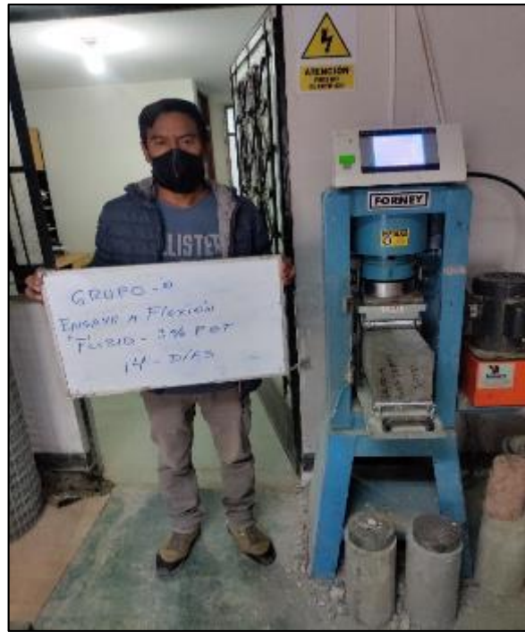
Foto 79. ensayo a flexión a 14 días
