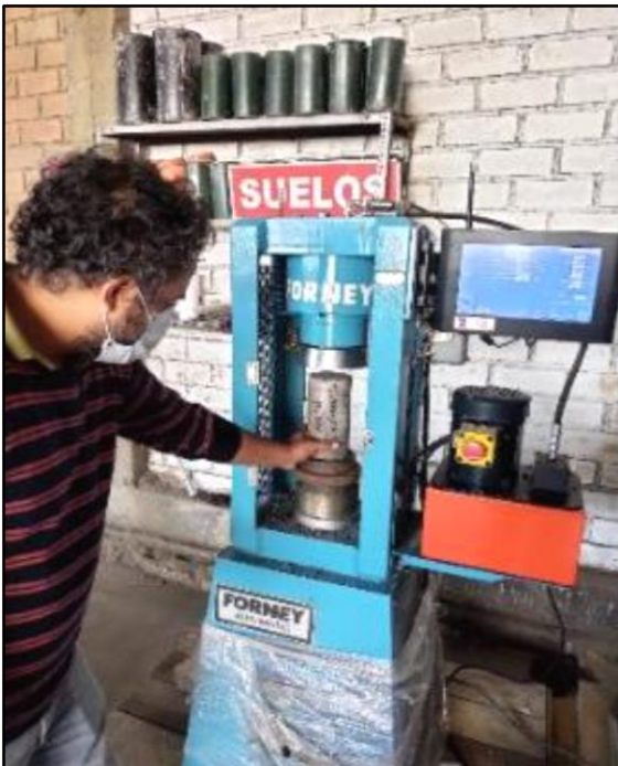
Foto 65. Ensayo de resistencia a la compresión hecha a los testigos de concreto muestra patrón
