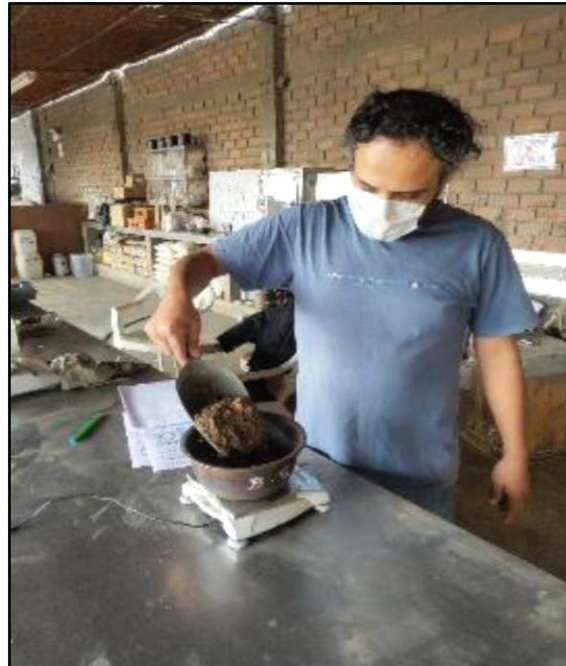
foto 4. pesaje de muestra agregado fino
