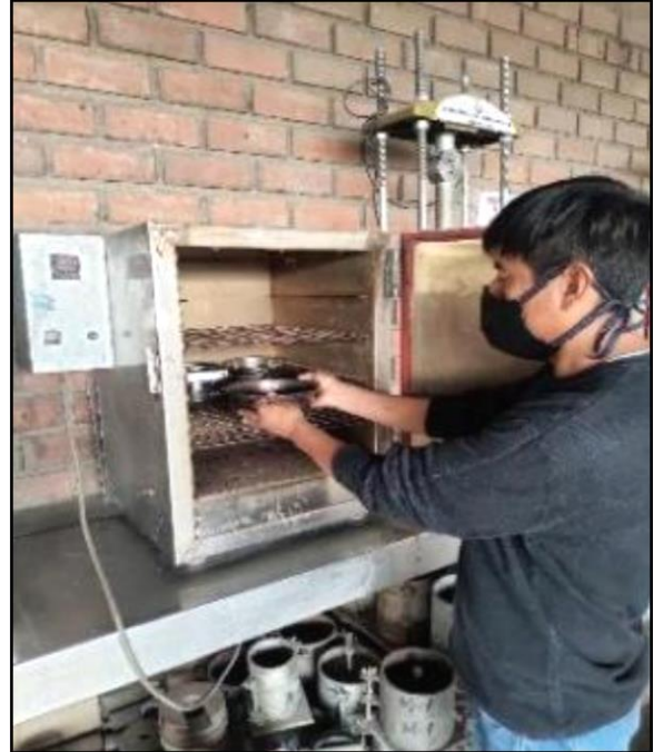
Foto 17. muestra colocada en el horno para obtener contenido de humedad
