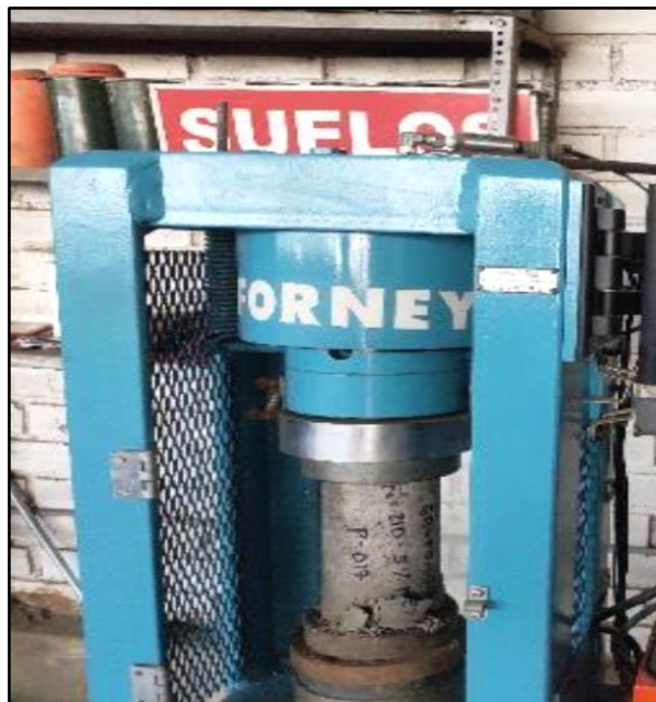
Foto 70. Falla de testigo con 5% de PET
