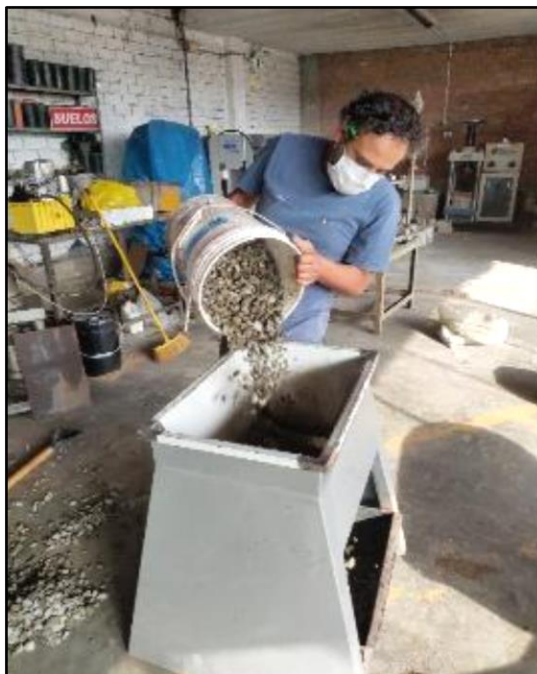
Foto 7. cuarteo de agregado grueso grueso
