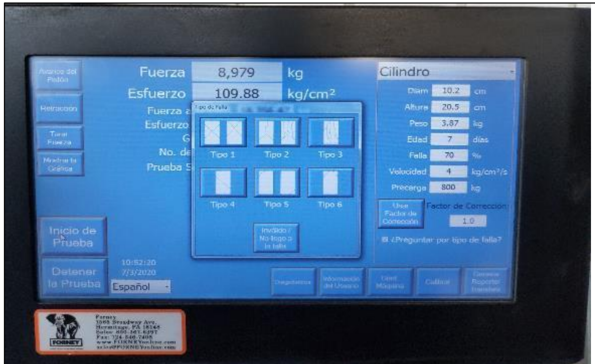
Foto 73. Tipos de falla a compresión en ruptura de probetas
