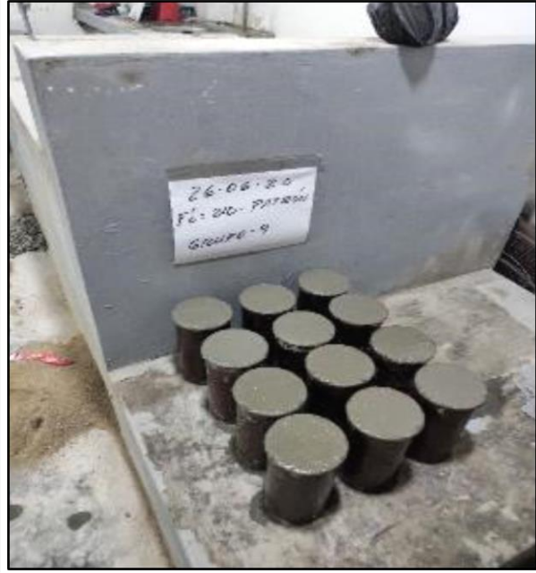
Foto 39 y 40. Acabado final de los testigos de concreto y de vigas
