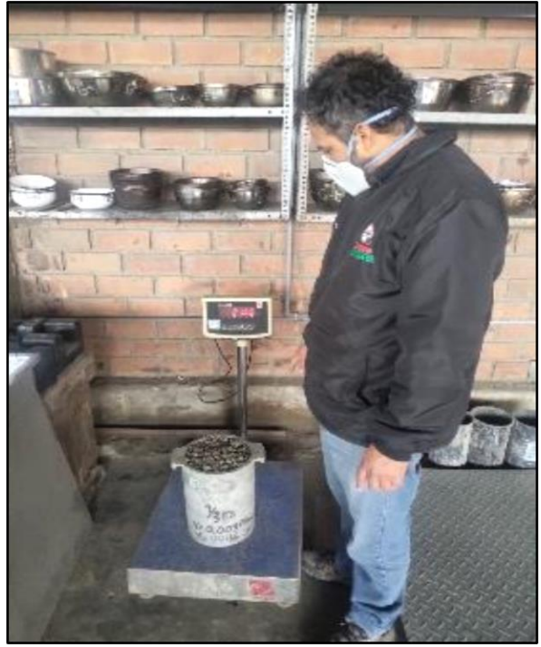
foto 13. ensayo de peso unitario
