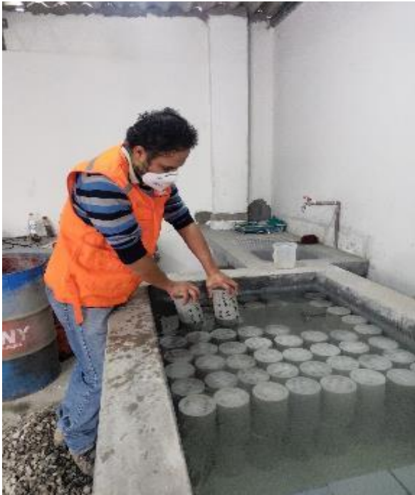
Foto 55 y 56. Almacenamiento de los testigos de concreto en la piscina de agua
