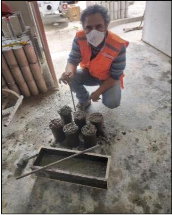
Foto 47 y 48. Colocación de muestra de concreto en vigas y probetas
