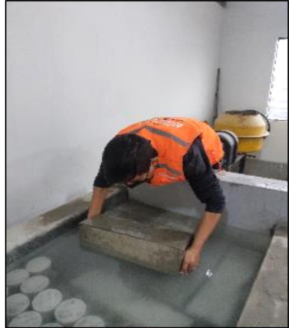
Foto 43 y 44. Almacenamiento de los testigos de concreto en la piscina de agua
