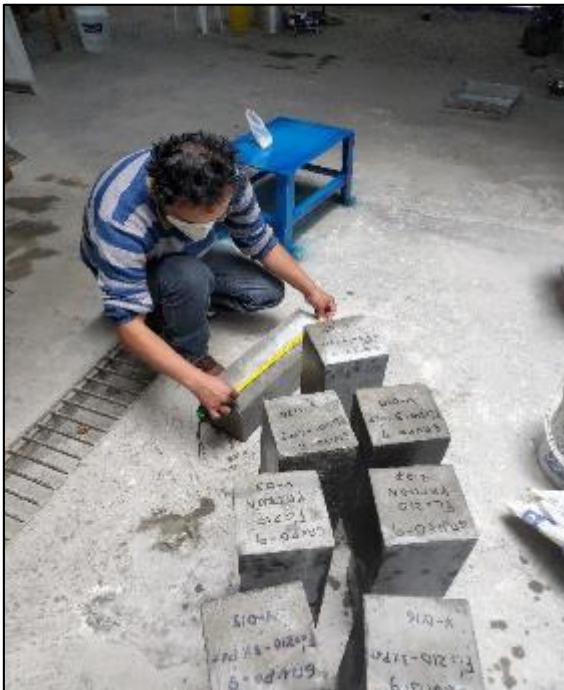
Figure 74. medida de la viga patrón
