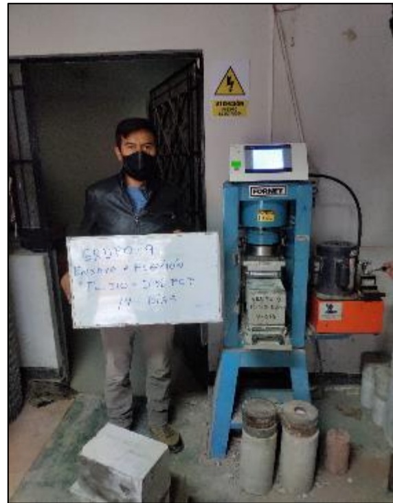
Foto 83. ensayo a flexión a 14 días
