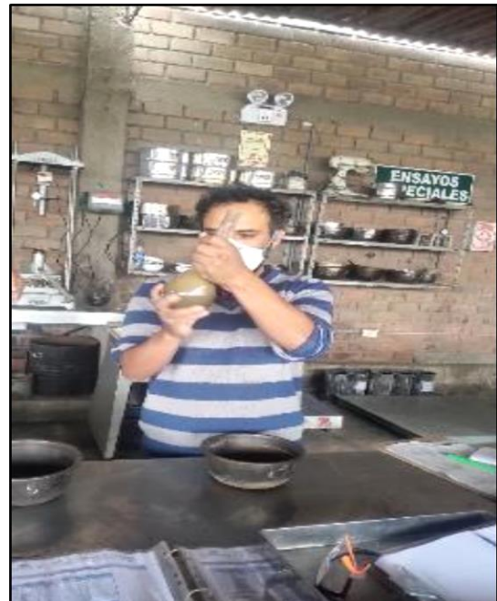
Foto 23. Agitación del picnómetro
