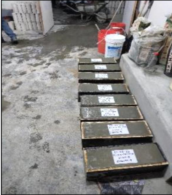
Foto 39 y 40. Acabado final de los testigos de concreto y de vigas
