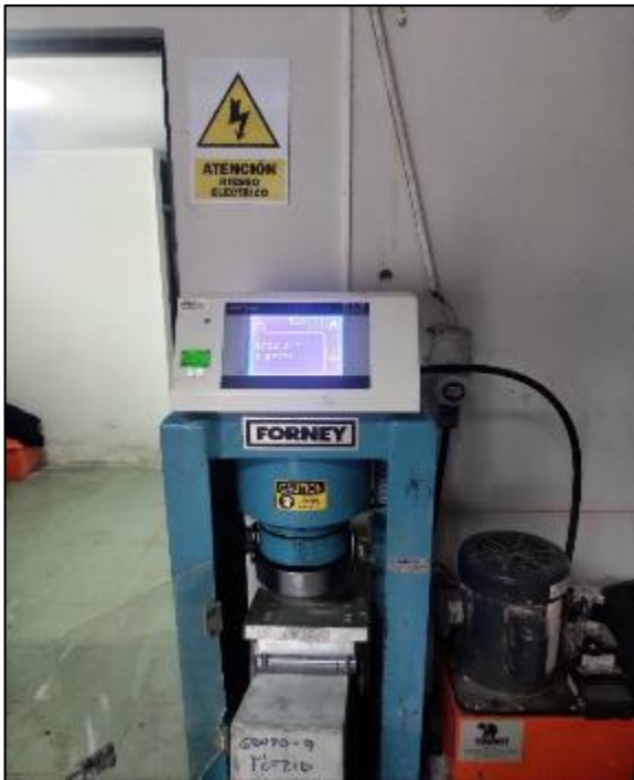
Foto 78. Ensayo a Flexión a 7 días
