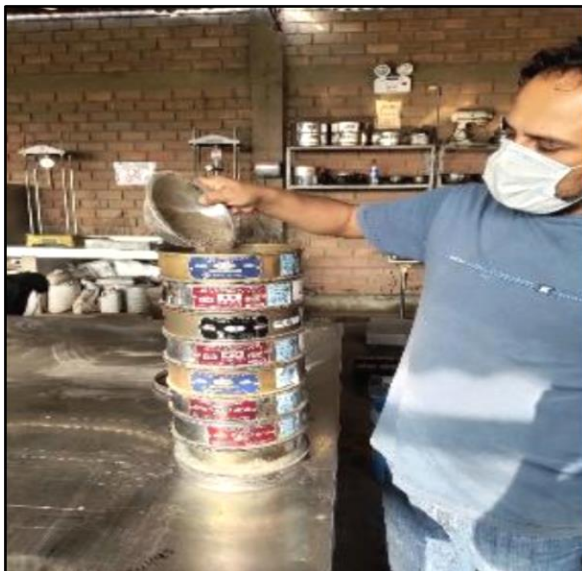
Foto 18. tamizado de muestra agregado
