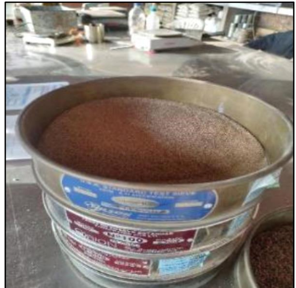
Foto 19. se pesa cada muestra retenida en los diferentes matices
