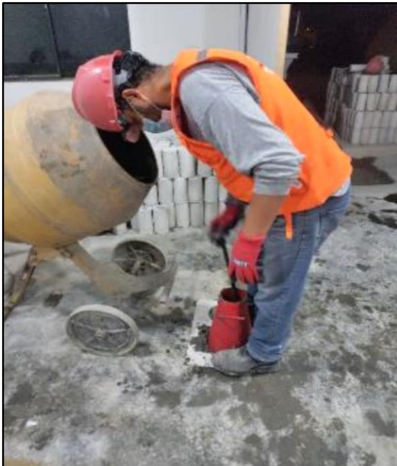
FOTO 33 y 34. prueba de concreto en el cono de Abrams
