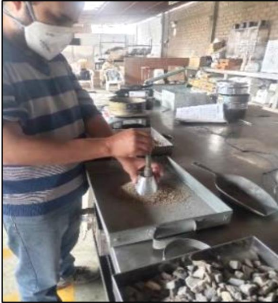
Foto 20. prueba de humedad superficial
