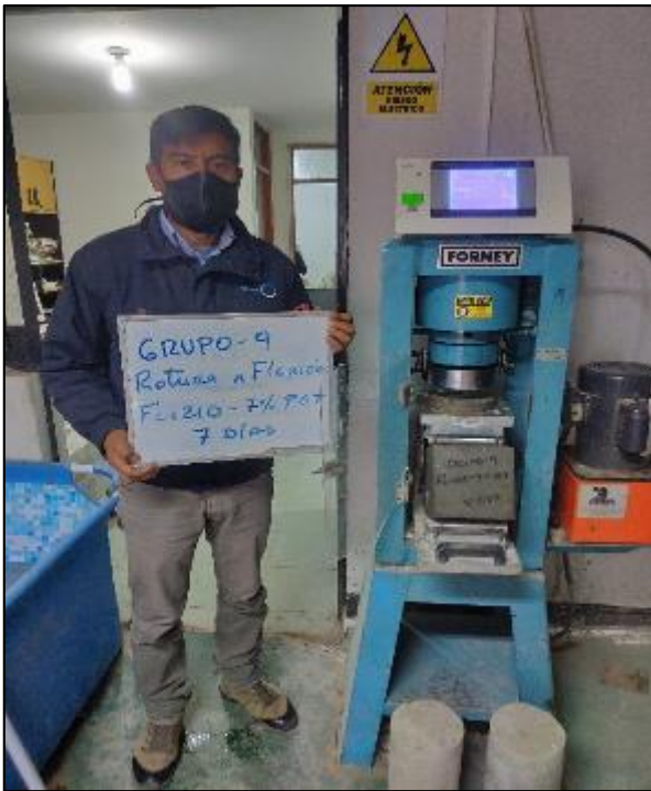
Foto 86. ensayo a flexión a 7 días
