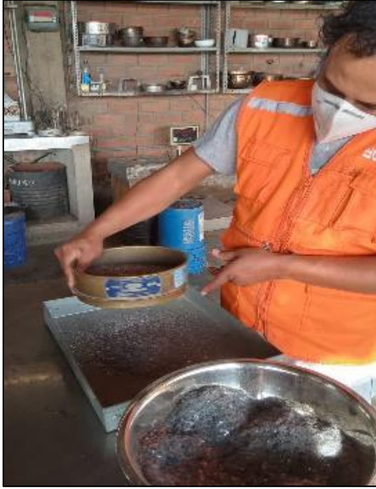
Figure 27 y 28. tamizado del plástico reciclado PET
