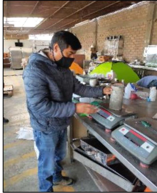
Foto 63 y 64. medida y Pesaje de los testigos de concreto
