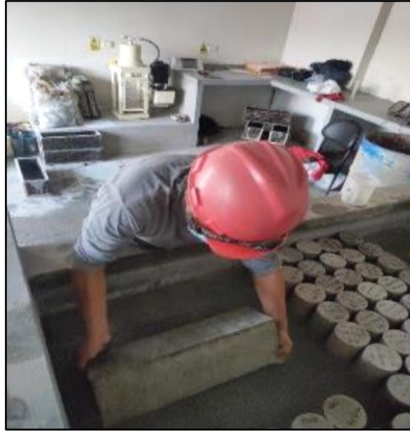
Foto 59 y 60. Almacenamiento de los testigos de concreto en la piscina de agua
