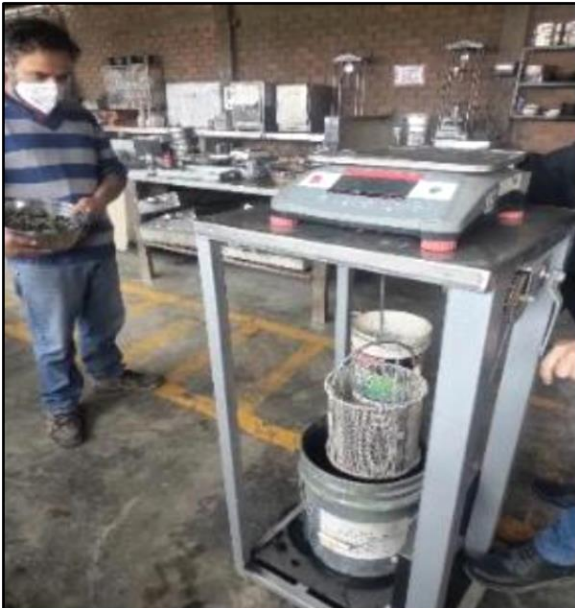
Foto 14. peso específico del agregado grueso
