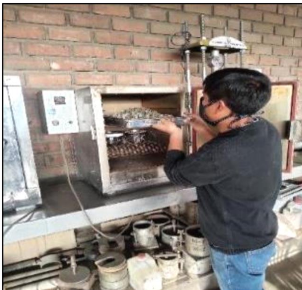
Foto 10. la muestra pesada se pone al horno a secar
