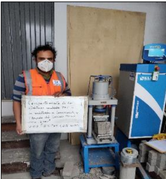
Foto 80. ensayo a flexión a 28 días
