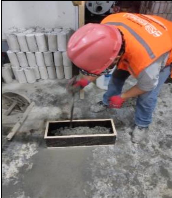
Figure 35 y 36 colocación de muestra de concreto en vigas
