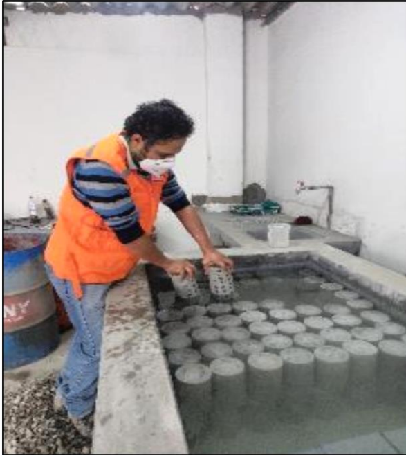
Foto 43 y 44. Almacenamiento de los testigos de concreto en la piscina de agua
