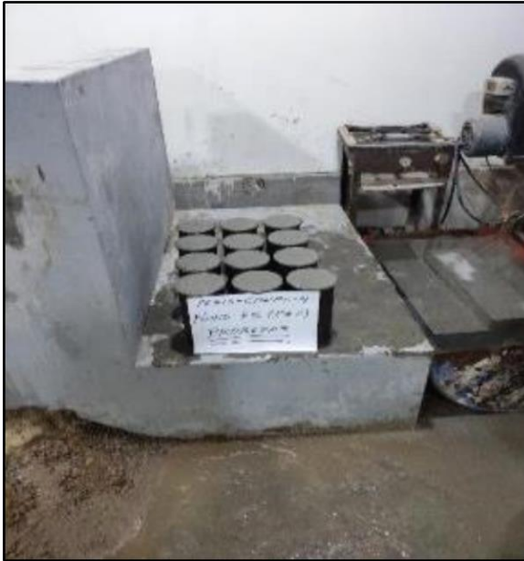
Foto 59 y 60. Almacenamiento de los testigos de concreto en la piscina de agua
