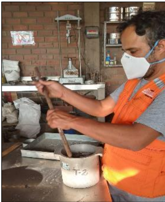
Figure 29 y 30. ensayo de peso unitario del plástico reciclado PET
