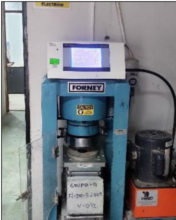
Foto 82. ensayo a flexión a 7 días
