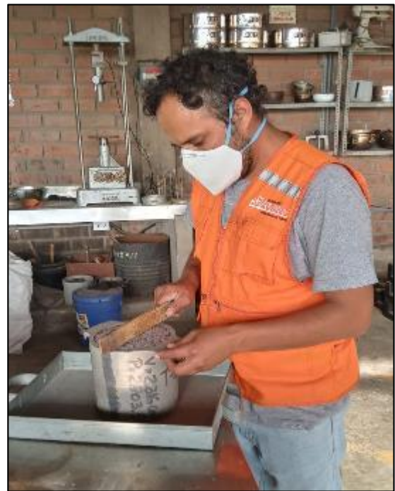
Figure 29 y 30. ensayo de peso unitario del plástico reciclado PET
