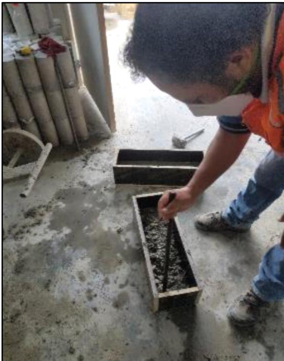
Foto 53 y 54. Colocación de muestra de concreto
