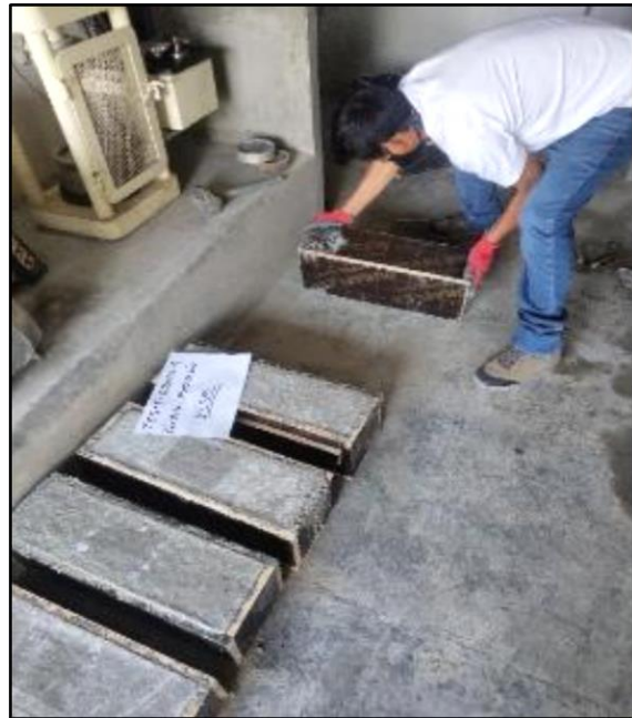
Foto 39 y 40. Acabado final de los testigos de concreto y de vigas
