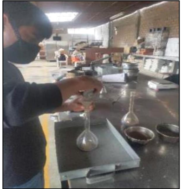
Foto 21. colocación de muestra en el picnómetro
