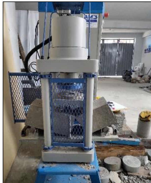
Foto 89. falla de viga con 7% de PET
