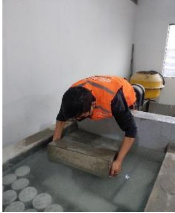
Foto 55 y 56. Almacenamiento de los testigos de concreto en la piscina de agua
