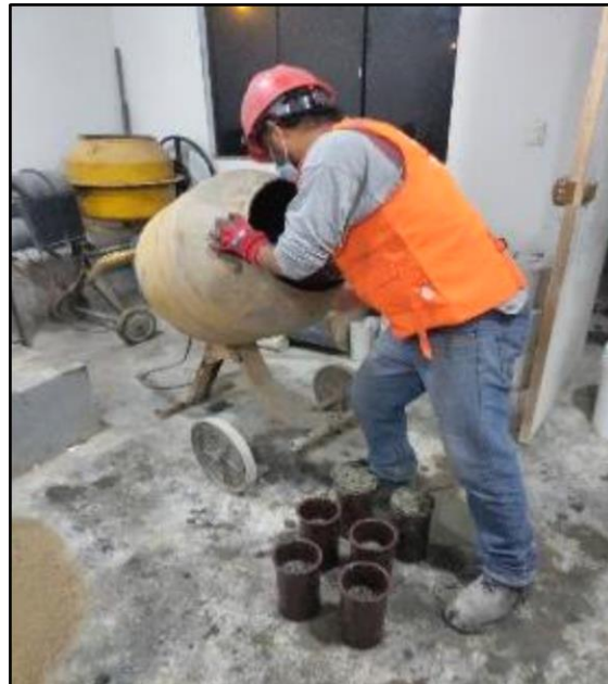
Foto 37 y 38. Colocación de muestra de concreto para elaboración de las probetas
