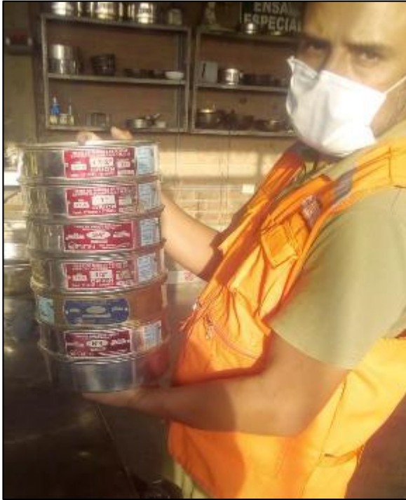
foto 12. tamizado del agregado grueso
