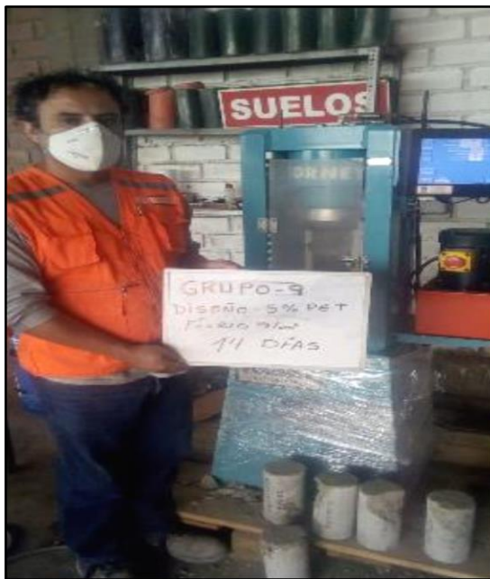
Foto 69. Resistencia a compresión con adición de PET 5%
