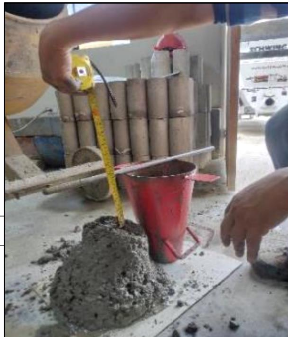
Foto 46. Prueba de asentamiento o slump
