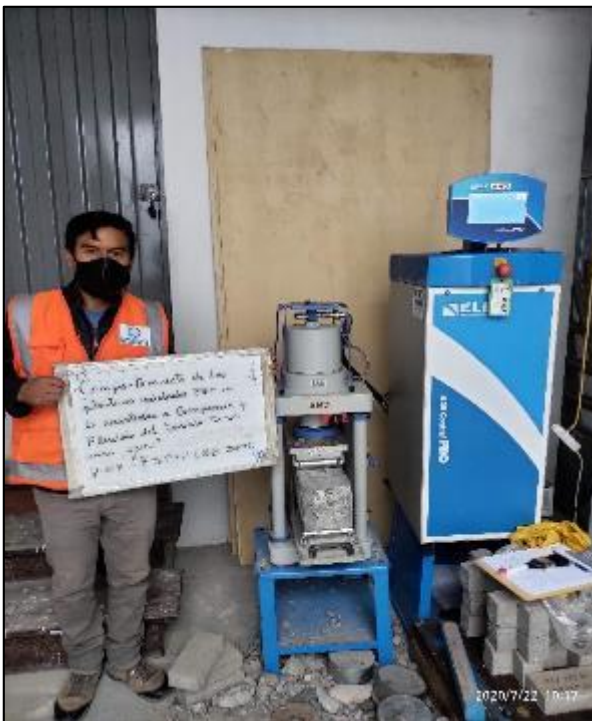
foto 88. ensayo a flexión a 28 días
