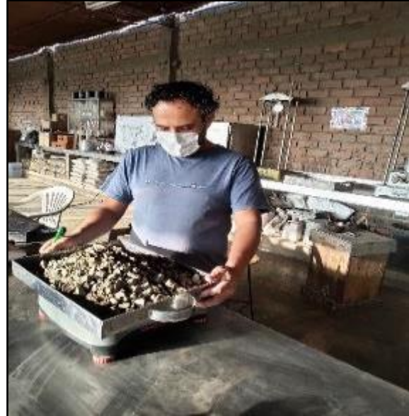
Foto 2. pesaje de agregado grueso
