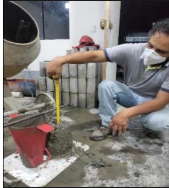
Foto 52. prueba de asentamiento o slump
