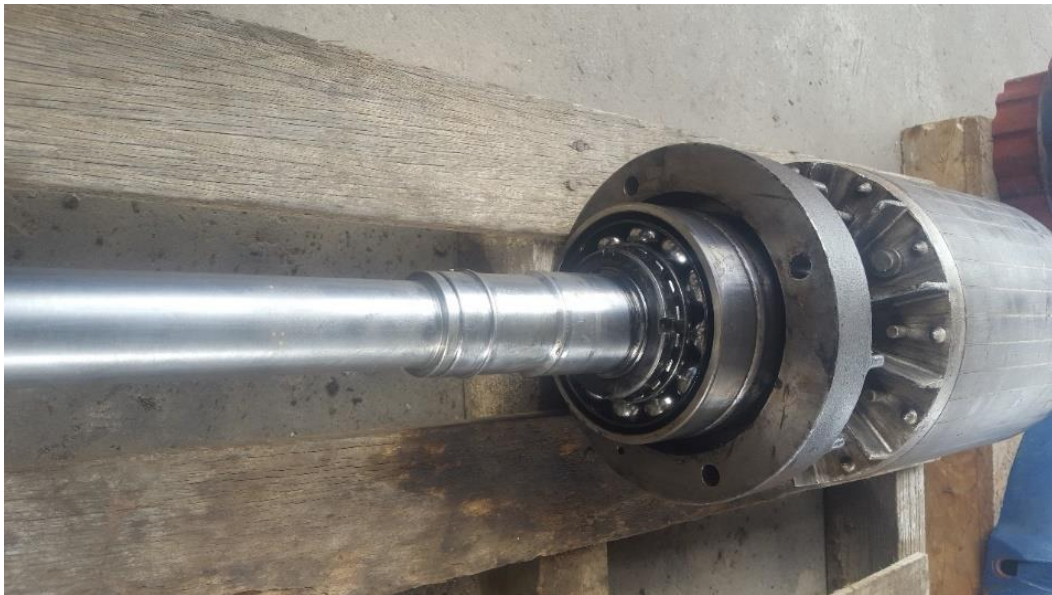
Figura 3. Instalación de rodamiento SKF en eje metalizado de motor eléctrico.
