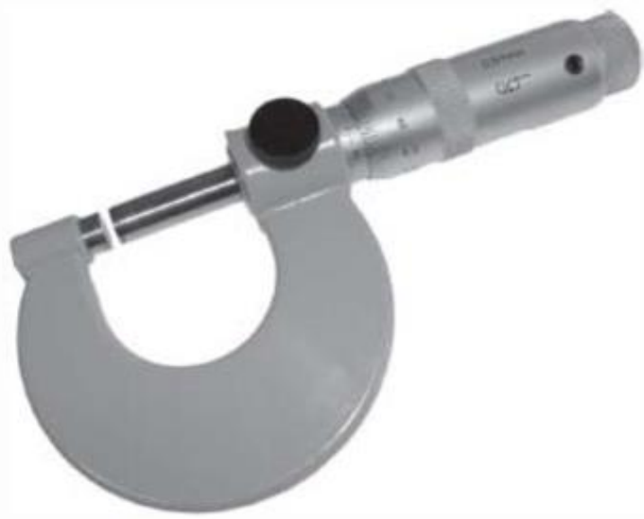
Figura 4. Instrumento de medición utilizado “Micrómetro”. Fuente: manual Tenium “Tolerancias y Ajustes, 2017”
