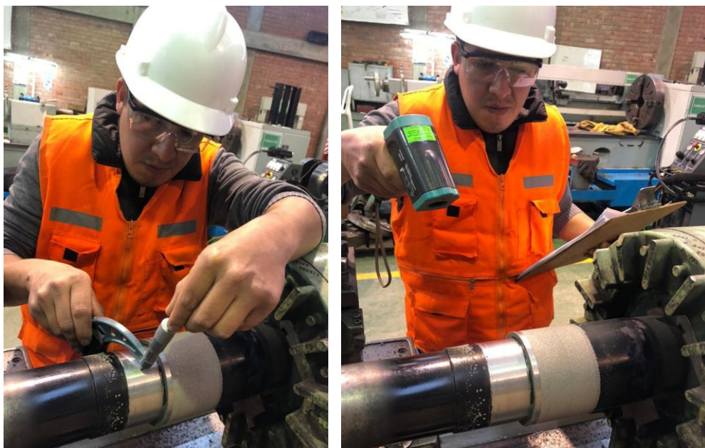
Figura 5. Bachiller William Chacón Tomando mediciones de las variaciones del eje metalizado. Fuente: Propia
