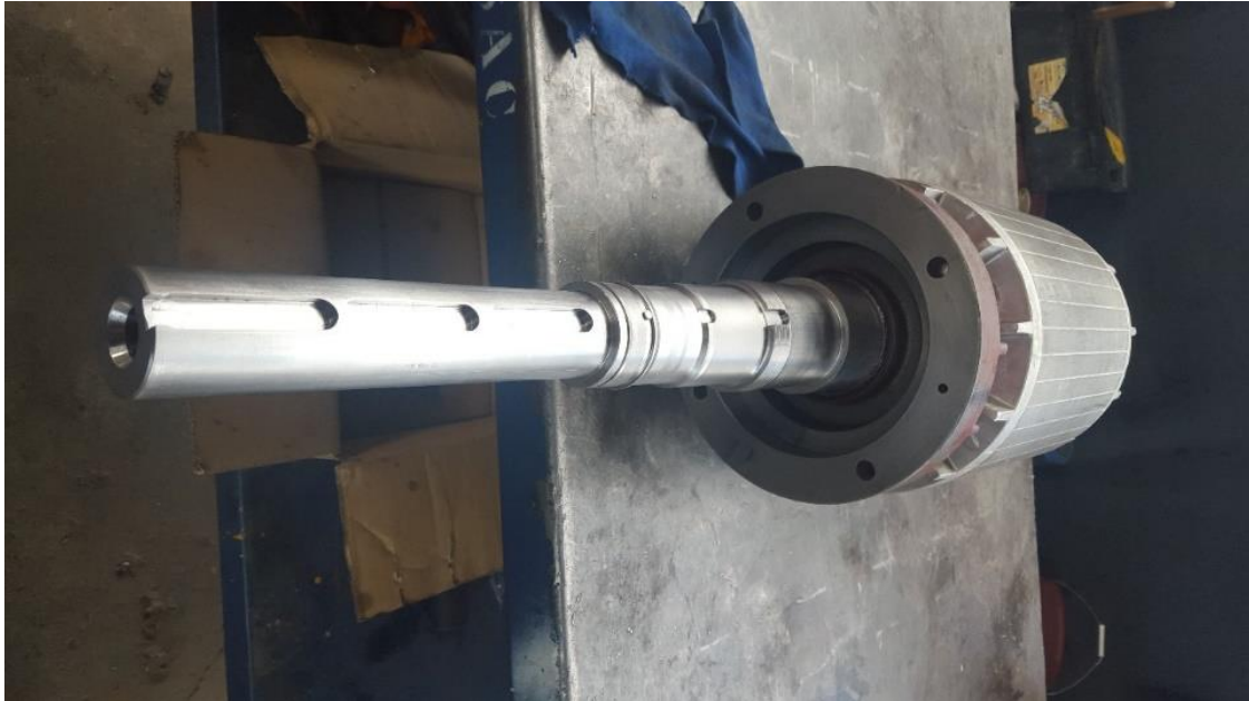
Figura 1. Eje metalizado de un motor eléctrico. Fuente: Propia
