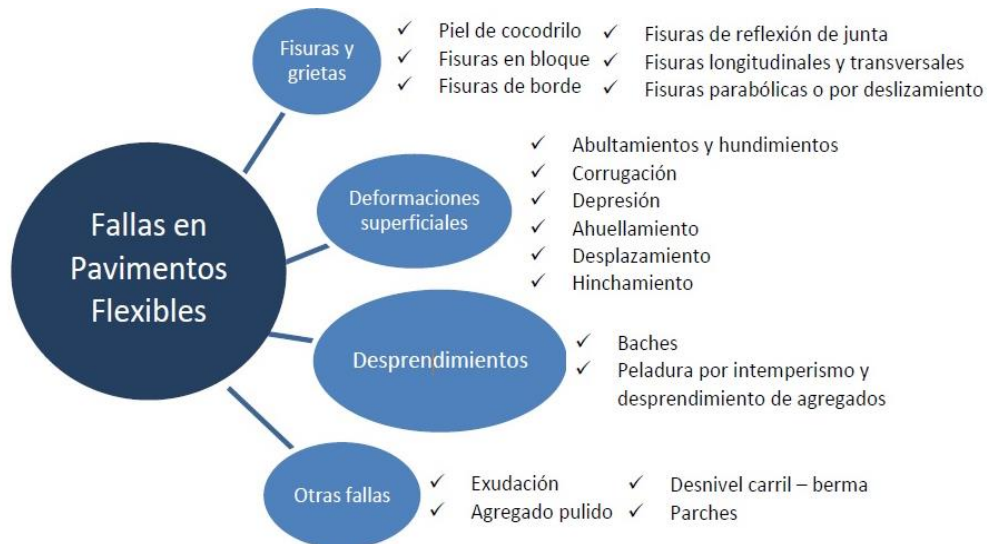
FIGURA D: Fallas de pavimento flexible establecidos por el PCI FUENTE: Rodríguez Velásquez, E. 2009
