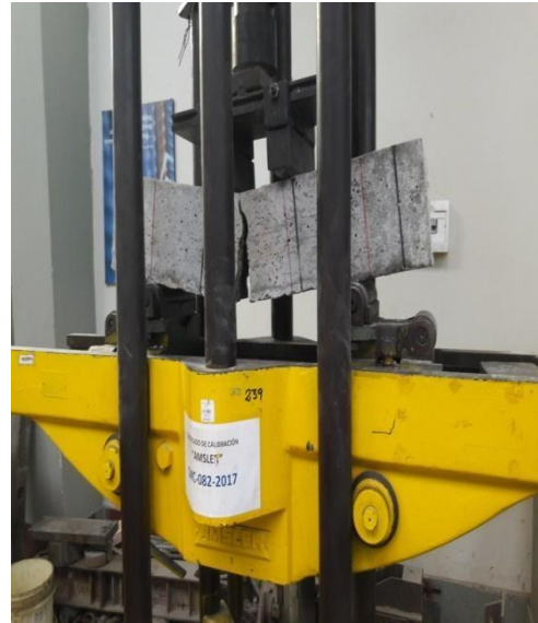
Figura 39. Ensayo de flexión para vigas de concreto con fibras metálicas.
