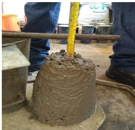
Figura 28. Asentamiento de 3" a 2".
