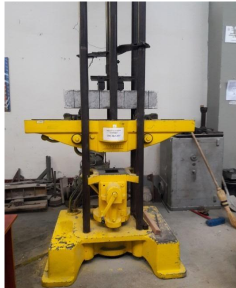
Figura 38. Ensayo de flexión para vigas de concreto convencional.
