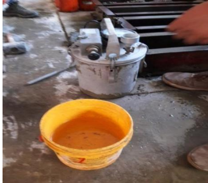
Figura 29. Olla de presión con mezcla de concreto con y sin fibra.
