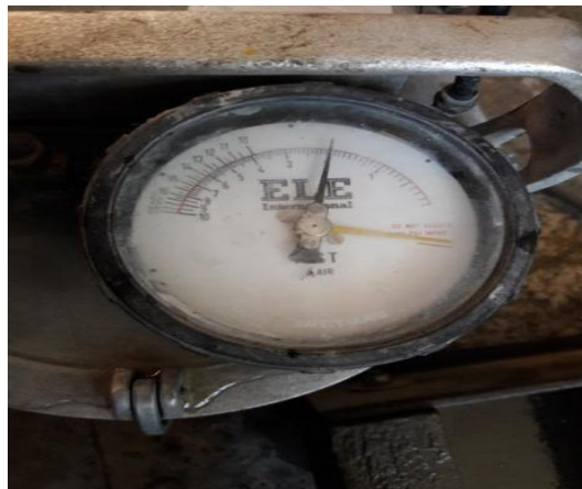
Figura 31. Contenido de aire en concreto con fibras de 2%.
