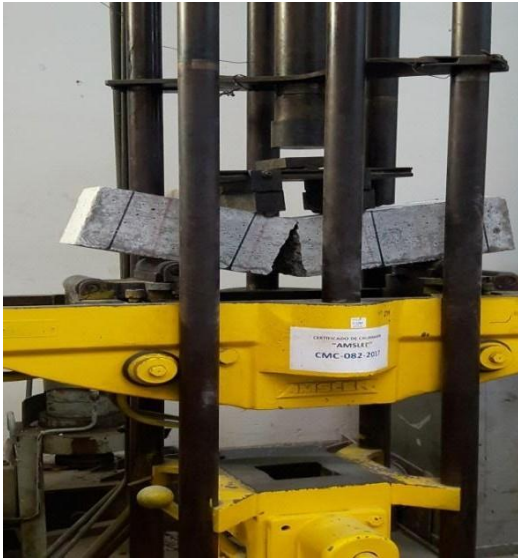
Figura 39. Ensayo de flexión para vigas de concreto con fibras metálicas.
