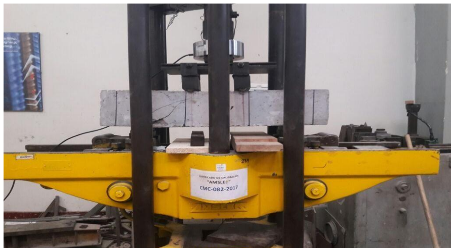
Figura 42. Ensayo a flexión de viga de concreto armado.
