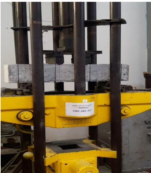
Figura 38. Ensayo de flexión para vigas de concreto convencional.
