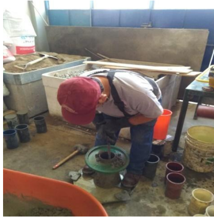
Figura 26. Prueba de consistencia para mezcla simple.
