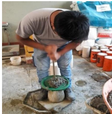
Figura 27. Prueba de consistencia para mezcla con fibras metálicas.
