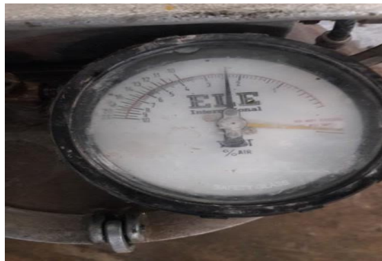
Figura 30. Contenido de aire en concreto convencional de 2.5%.
