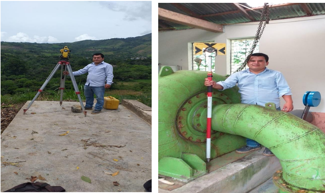
Figura 7. Medición de altura con el equipo subestación total (cámara de carga y centro de turbina)
