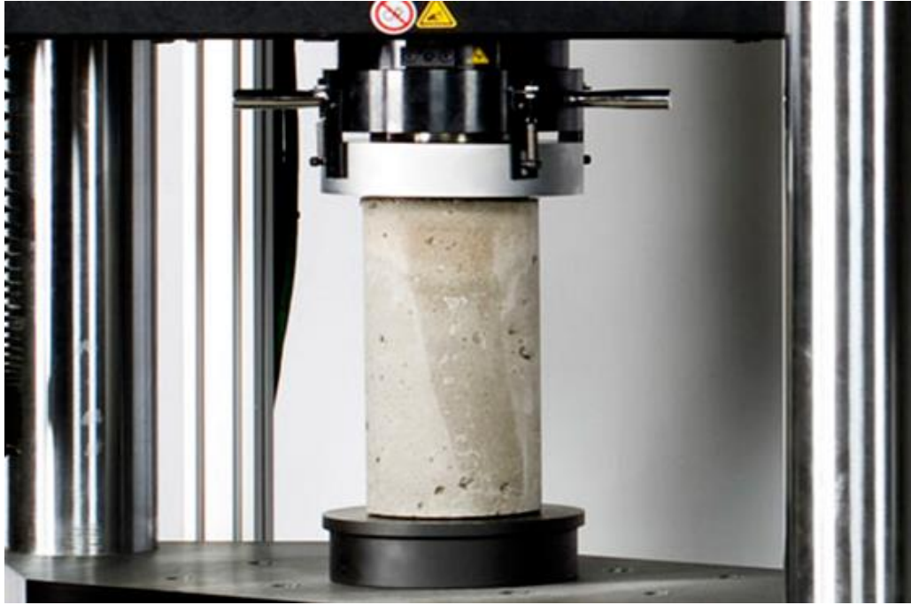
Figura 4. Ensayo de compresión de concreto con modificación bacteriana.
