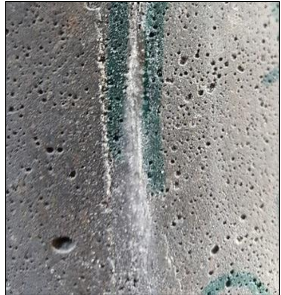
Observación del crecimiento de cristales de Carbonato de Calcio en fisuras en las probetas de concreto
