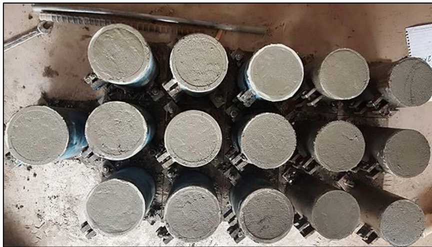
Rotura de concreto a una edad de 14 días de fraguado
