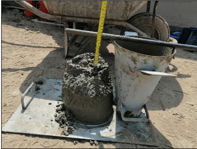
Ensayo de asentamiento
