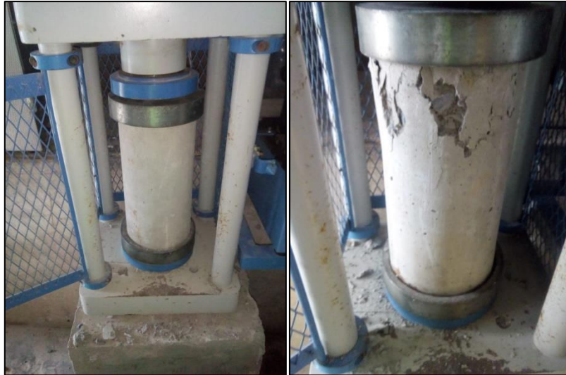
Rotura de concreto a una edad de 14 días de fraguado
