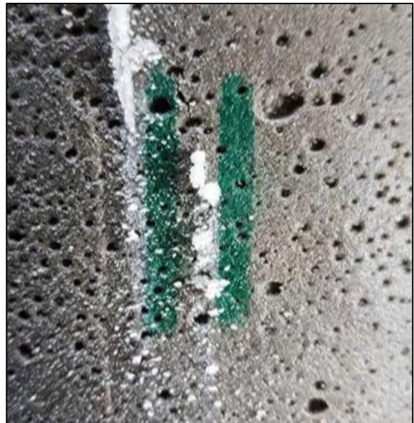
Observación del crecimiento de cristales de Carbonato de Calcio en fisuras en las probetas de concreto
