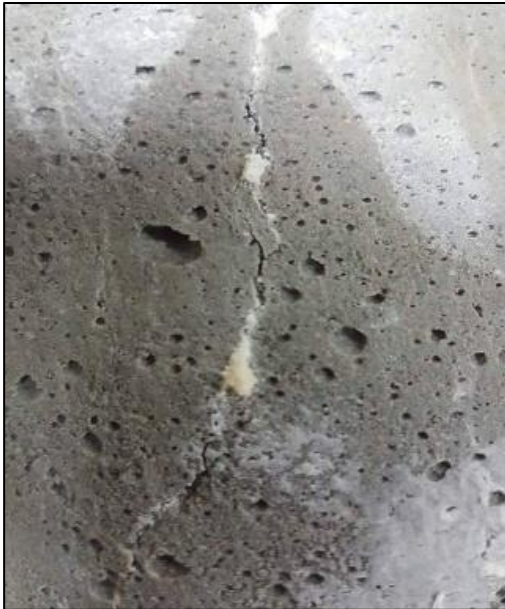
Observación del crecimiento de cristales de Carbonato de Calcio en fisuras en las probetas de concreto
