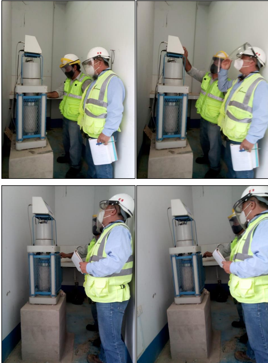
Control de resultados obtenidos durante las pruebas de rotura de probetas cilíndricas con y sin modificación bacteriana.
