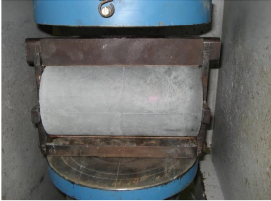
Figura 5. Ensayo de tracción de concreto de mezcla convencional.
