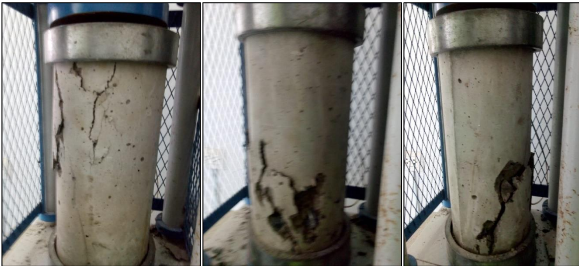
Rotura de concreto a una edad de 7 días de fraguado
