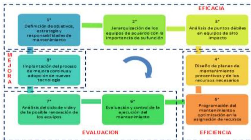
Figura 1: Modelo de proceso de gestión de proceso de mantenimiento de líneas de media tensión.
